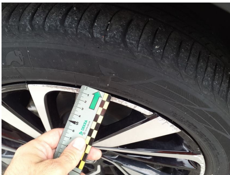
Pneumatico / Anteriore Sinistro / Tagliato/Strappato
