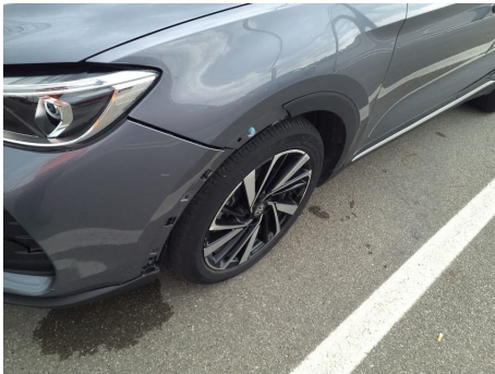
Modanatura parafrangente / Anteriore Sinistro / Rotto
