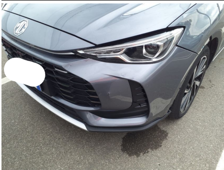
Paraurti / Anteriore / Ammaccato vernice incisa
