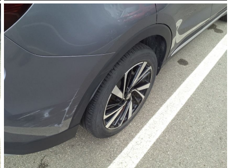
Modanatura parafrangente / Posteriore Destro / Riga
