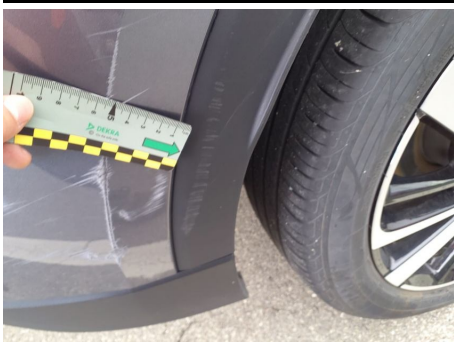
Modanatura parafrangente / Posteriore Destro / Riga
