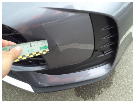
Paraurti / Anteriore / Ammaccato vernice incisa
