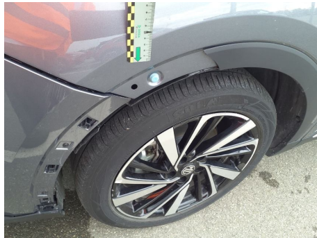
Modanatura parafrangente / Anteriore Sinistro / Rotto
