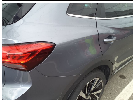
Parafrangente / Posteriore Destro / Riga
