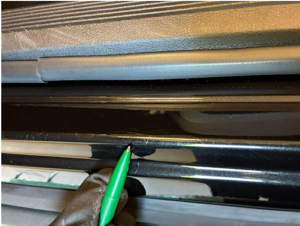
Bild 15 : Einstieg vorne links Kratzer
