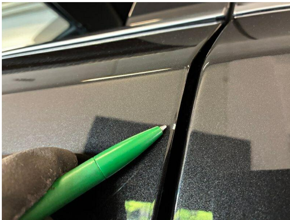
Bild 12 : Türe vorne links Kratzer
