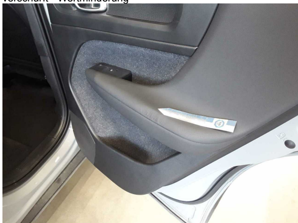
Beschädigung #3: Verkleidungen/Abdeckungen: Türverkleidung hinten rechts - verformt - erneuern
