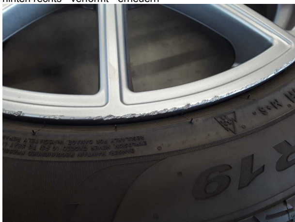
Beschädigung #4: 2.Radsatz: 1 Leichtmetallfelge - verkratzt / verschürft - erneuern
