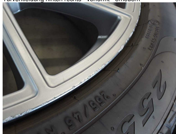
Beschädigung #4: 2.Radsatz: 1 Leichtmetallfelge - verkratzt / verschürft - erneuern
