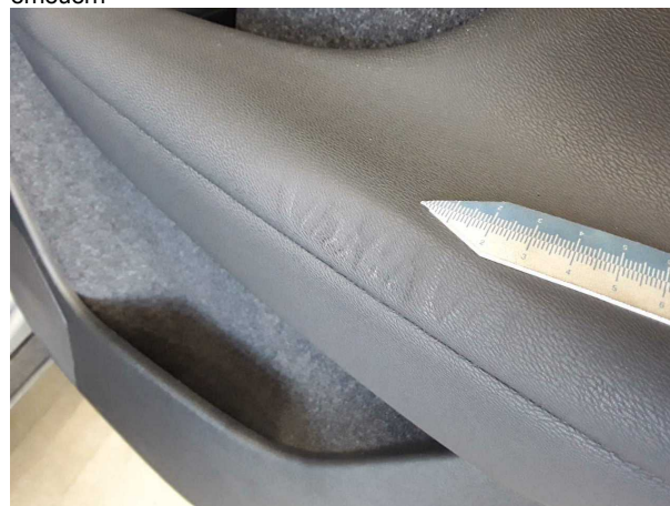
Beschädigung #3: Verkleidungen/Abdeckungen: Türverkleidung hinten rechts - verformt - erneuern
