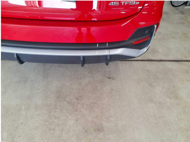
Beschädigung #2: Stossfänger hinten: Spoiler - verformt - erneuern
