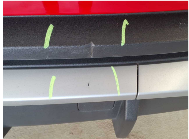
Beschädigung #2: Stossfänger hinten: Spoiler - verformt - erneuern
