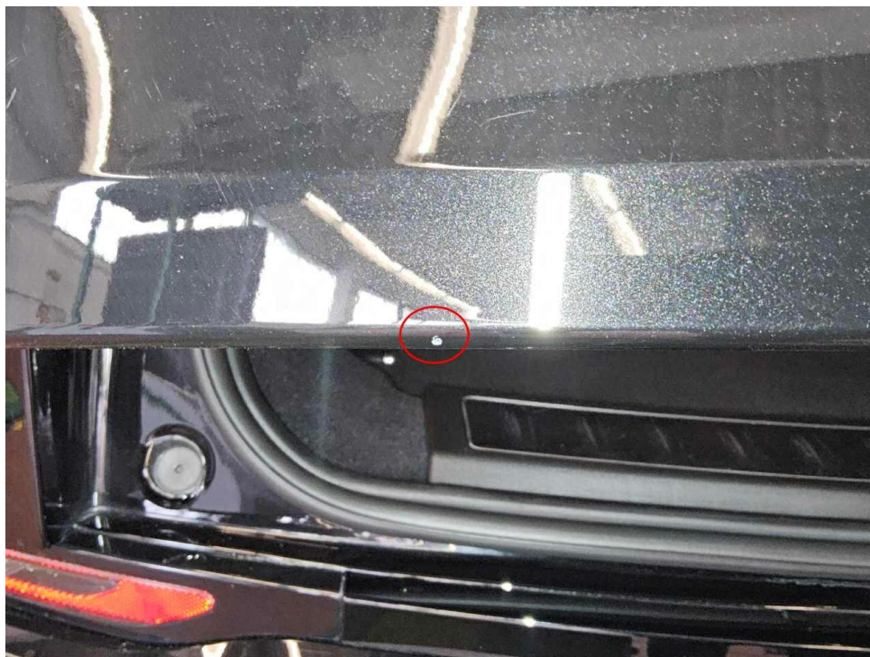
Bild 13 : Heckklappe Kante, verschrammt, smart repair
