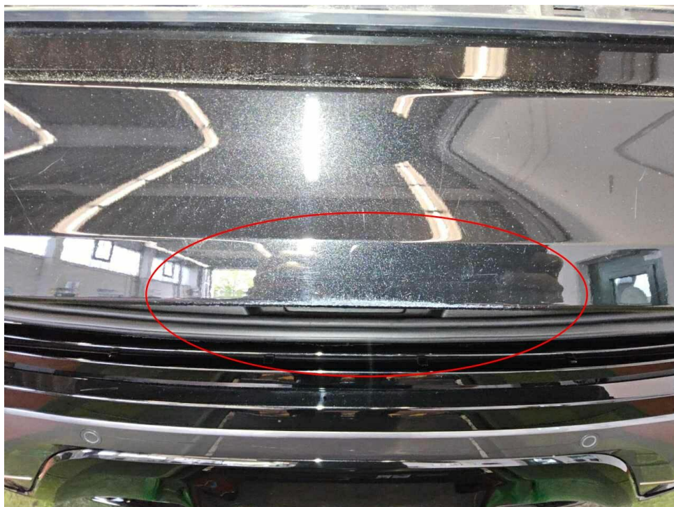
Bild 14 : Heckklappe Kante, verschrammt, smart repair
