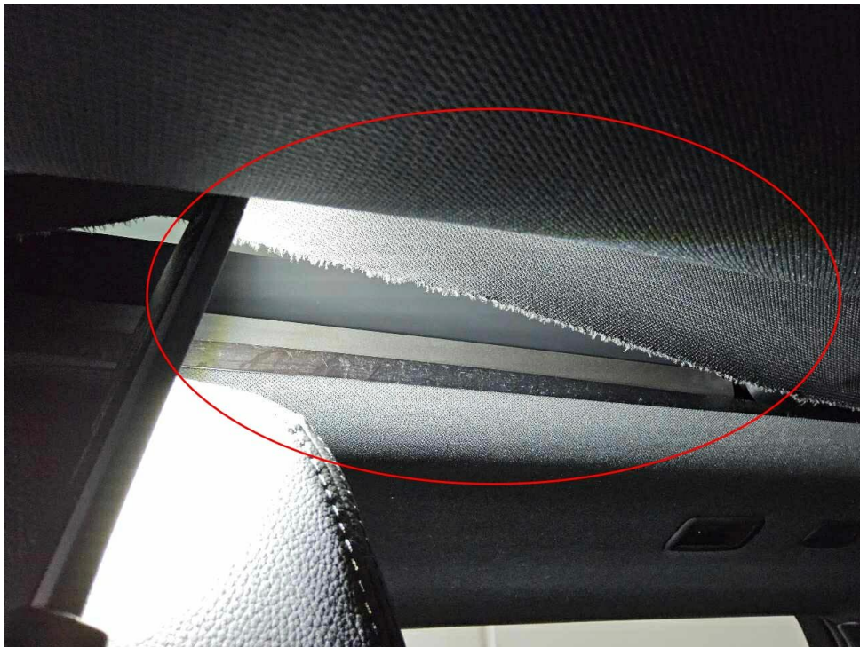
Bild 18 : Rollo Panoramadach gerissen
