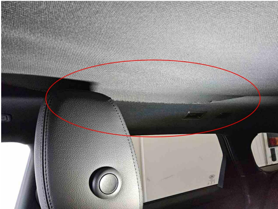
Bild 17 : Rollo Panoramadach gerissen
