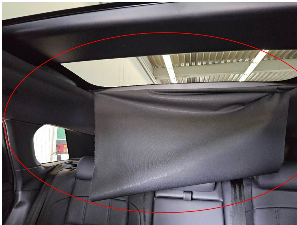
Bild 19 : Rollo Panoramadach gerissen
