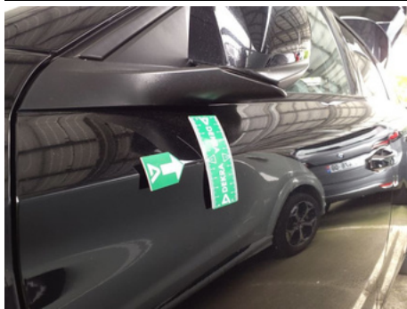
Porte / Avant Gauche / Enfoncement
