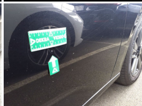
Porte / Avant Droit / Enfoncement
