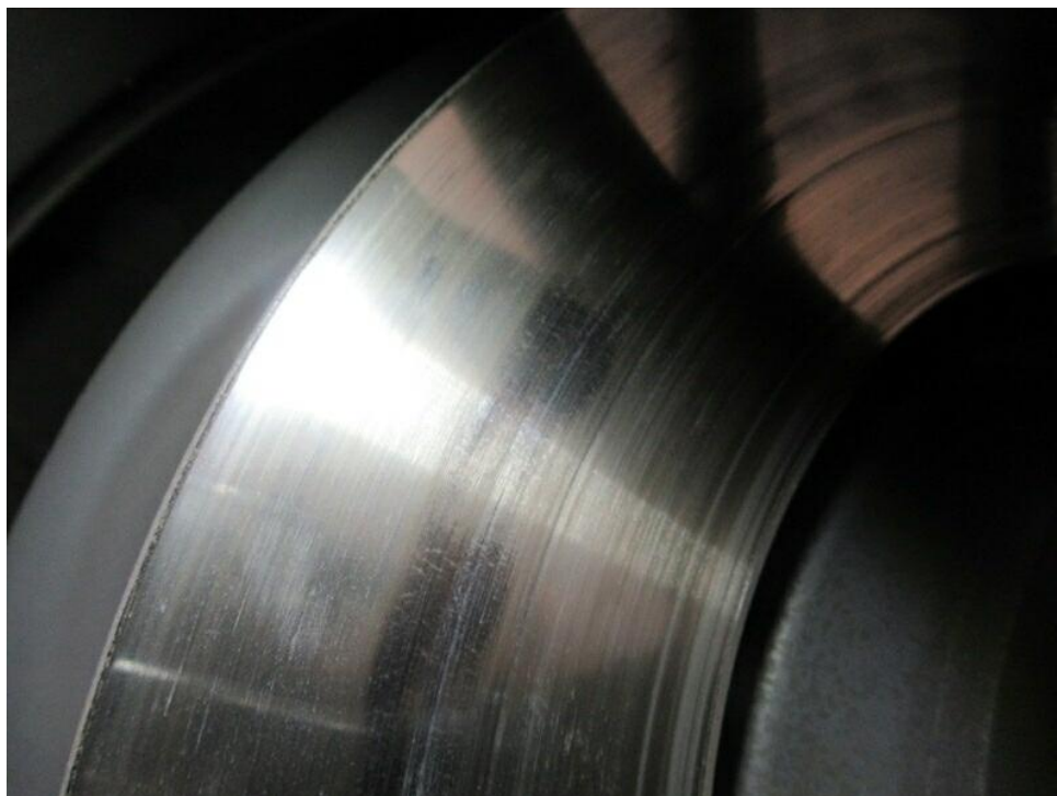
Bild 22 : Bremsscheiben vorne verglüht
