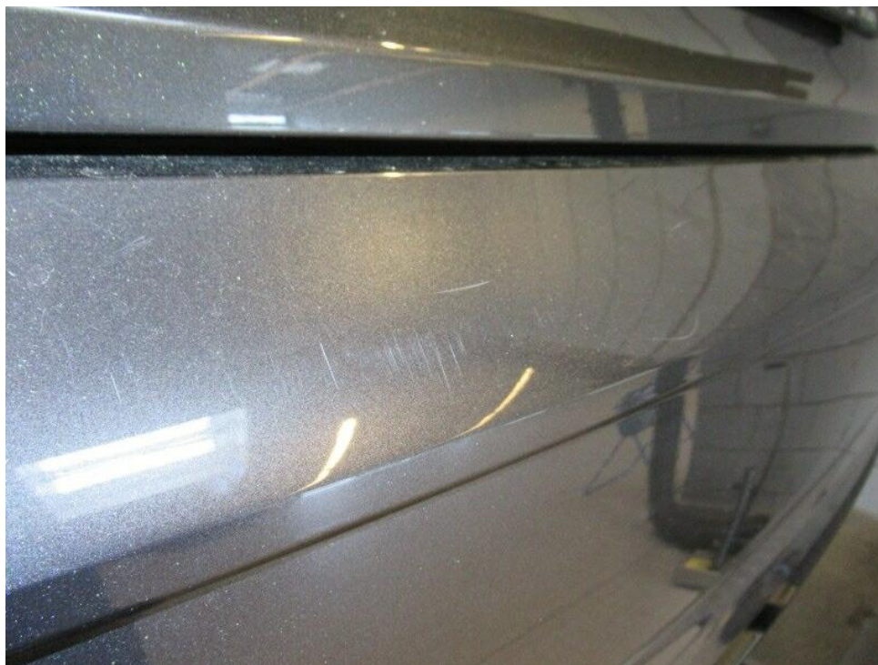
Bild 18 : Stoßfänger hinten Lackierung, zerkratzt, Gebrauchsspur
