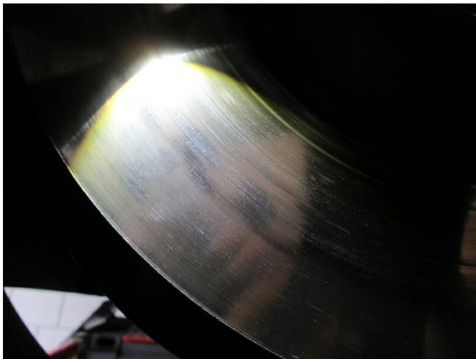
Bild 23 : Bremsscheiben vorne verglüht
