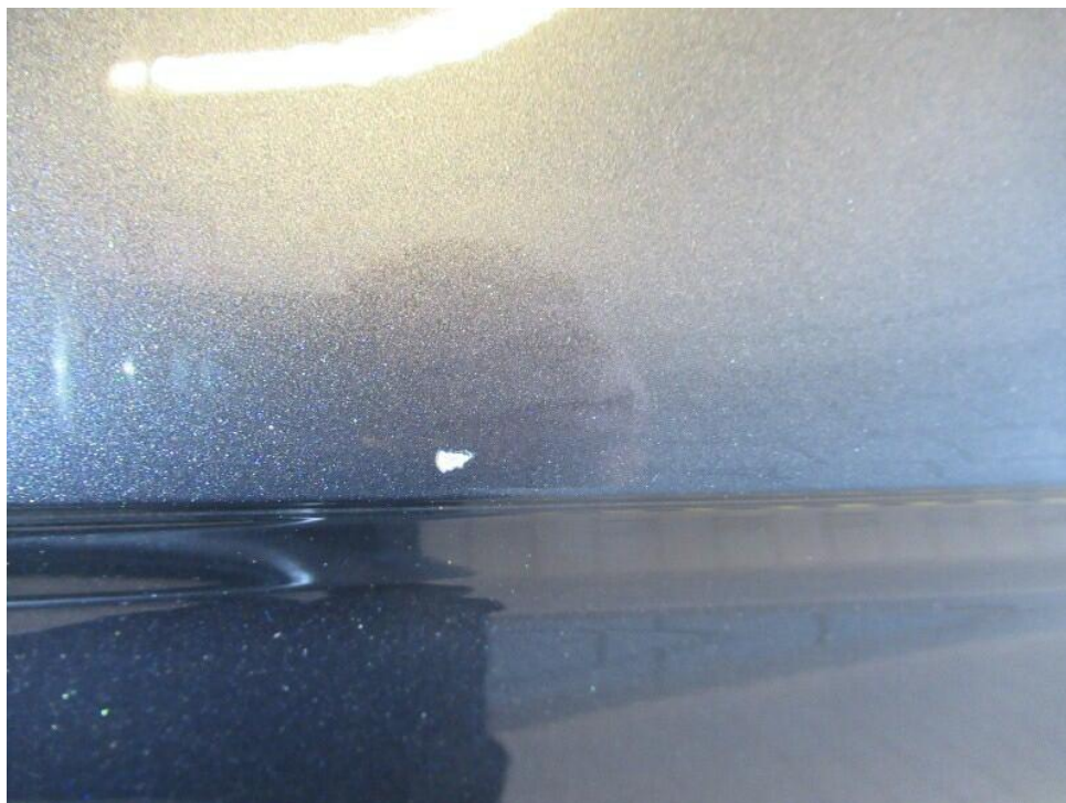
Bild 16 : Tür hinten rechts Lackierung, zerkratzt, Gebrauchsspur
