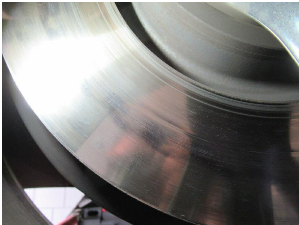
Bild 24 : Bremsscheiben vorne verglüht
