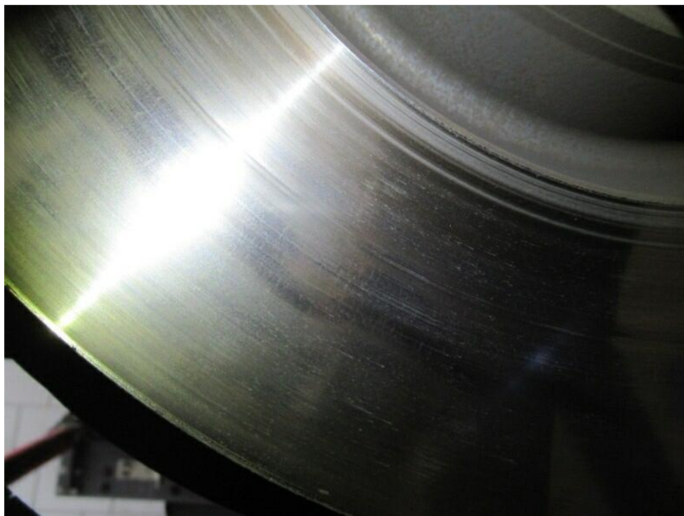
Bild 21 : Bremsscheiben vorne verglüht
