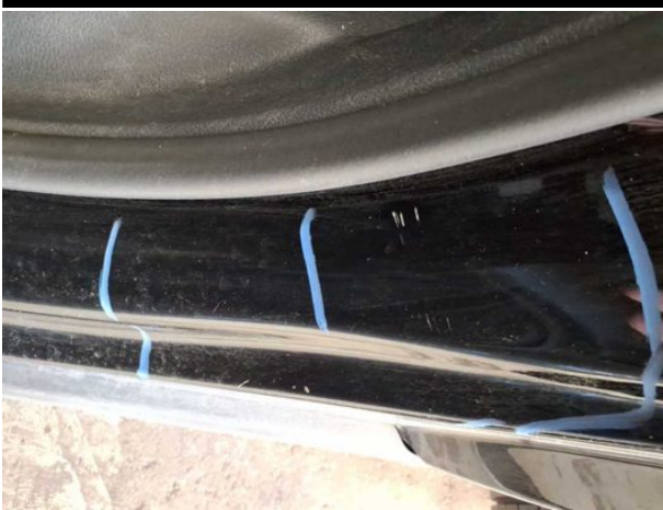
Beschädigung #5: Seitenwand links: Einstieg - Kratzer - auslege... polieren
