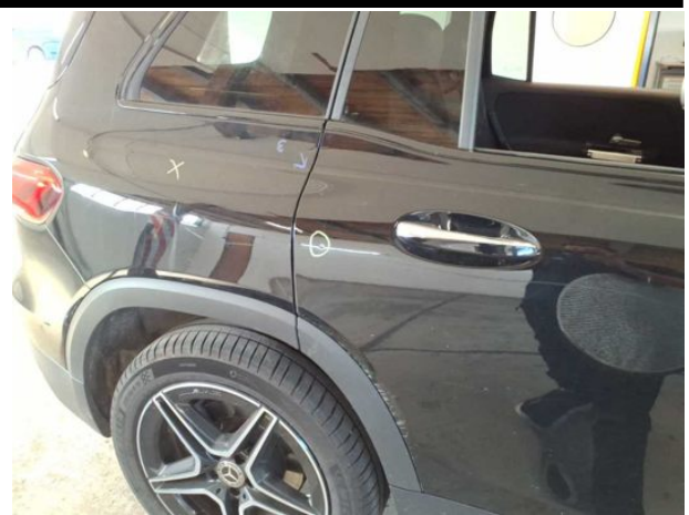
Beschädigung #7: Tür hinten rechts: Tür - Delle / Lackschad... - sanft instandsetzen
