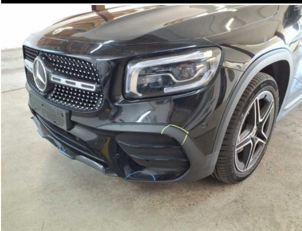
Beschädigung #9: Stossfänger vorn: Spoiler - Kratzer - erneuern
