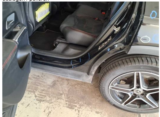
Beschädigung #5: Seitenwand links: Einstieg - Kratzer - auslegen / polieren
