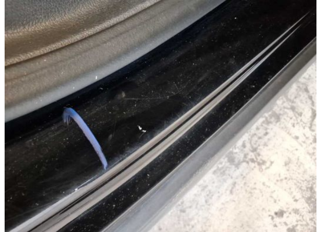
Beschädigung #1: Seitenwand rechts: Einstieg - Kratzer - auslegen / polieren
