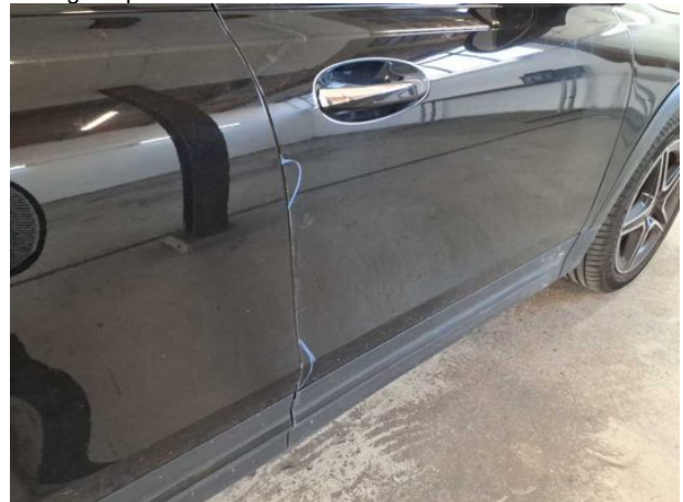
Beschädigung #2: Tür vorn rechts: Türkante - Kratzer - auslegen / polieren
