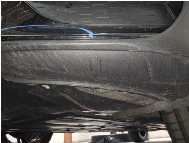
Beschädigung #9: Stossfänger vorn: Spoiler - Kratzer - erneuern
