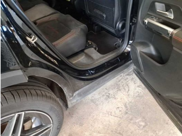
Beschädigung #1: Seitenwand rechts: Einstieg - Kratzer - auslegen / polieren
