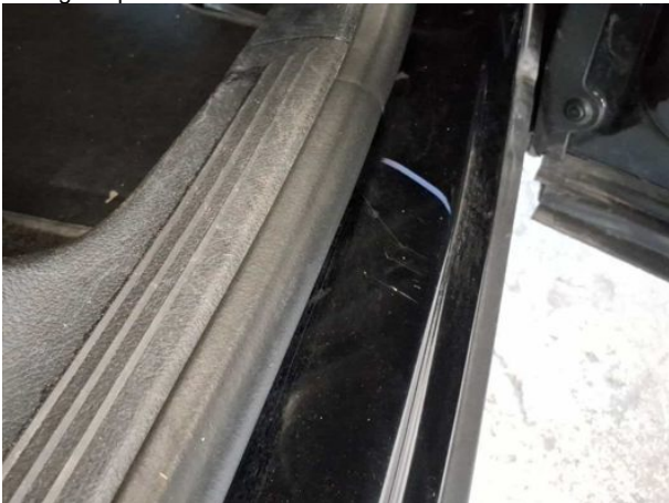
Beschädigung #1: Seitenwand rechts: Einstieg - Kratzer - auslegen / polieren
