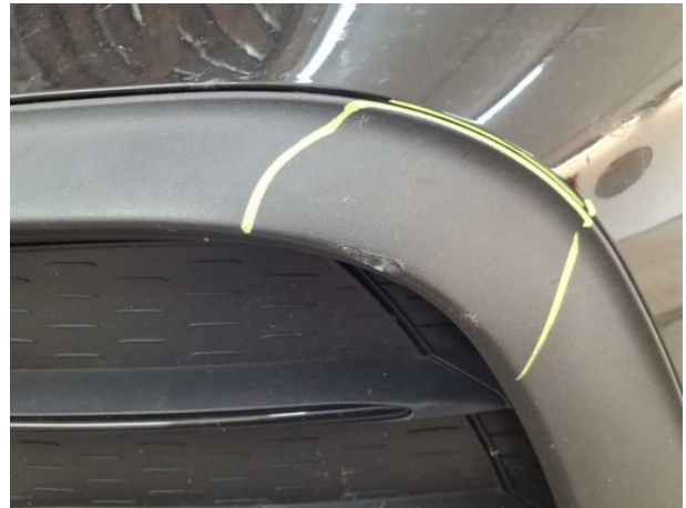
Beschädigung #9: Stossfänger vorn: Spoiler - Kratzer - erneuern
