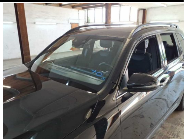
Beschädigung #13: Verglasung: Frontscheibe - Steinschlag - erneuern
