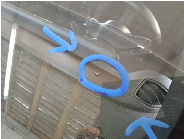
Beschädigung #13: Verglasung: Frontscheibe - Steinschlag - erneuern
