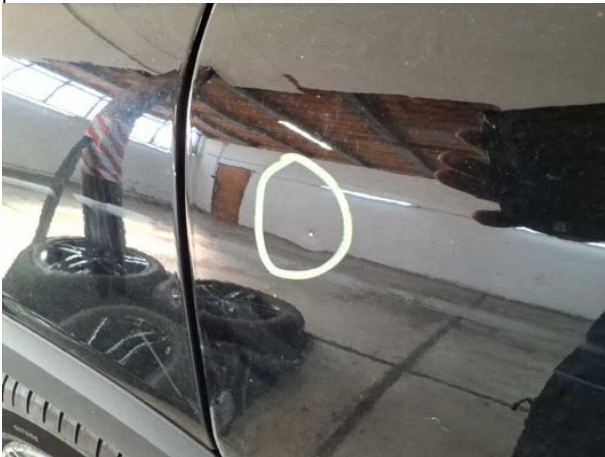
Beschädigung #7: Tür hinten rechts: Tür - Delle / Lackschaden - sanft instandsetzen
