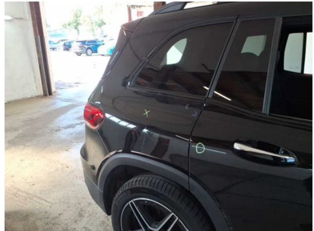
Beschädigung #14: Seitenwand rechts: Seitenwand - nicht fachgerecht instandgesetzt - instandsetzen und lackieren
