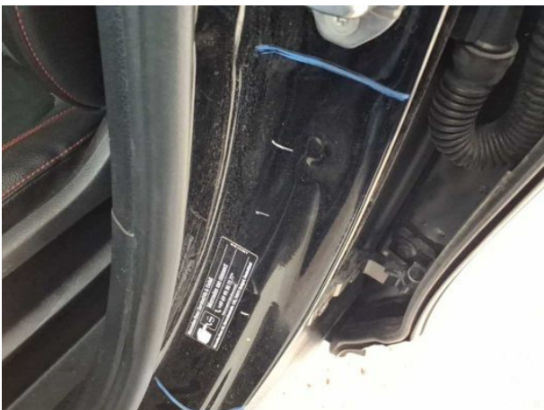
Beschädigung #10: Schweller links: Einstieg - Delle / Lackschad... - Smart Repair
