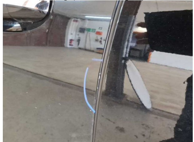
Beschädigung #4: Tür vorn links: Türkante - Kratzer - auslegen / polieren
