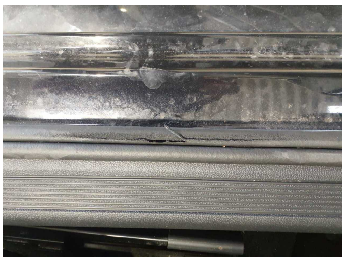
Damage 11: Door - front left side: Door seal - Broken / torn - Replace
