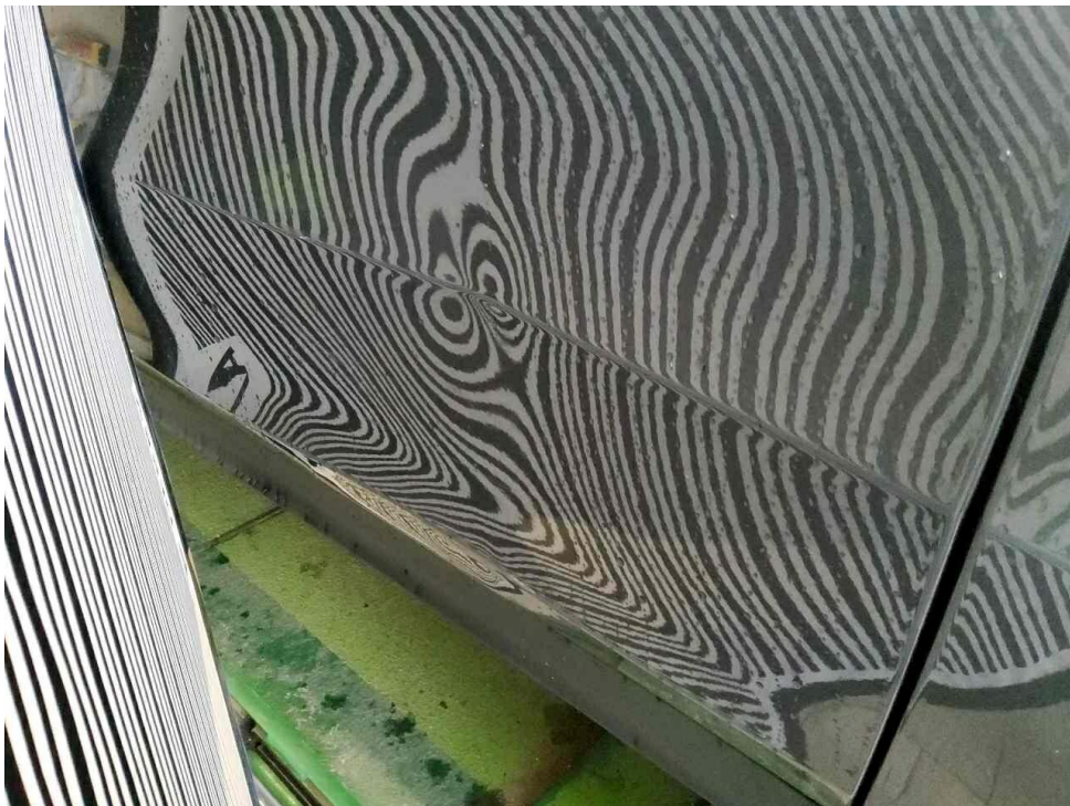
Bild 16 : Tür vorne rechts deformiert
