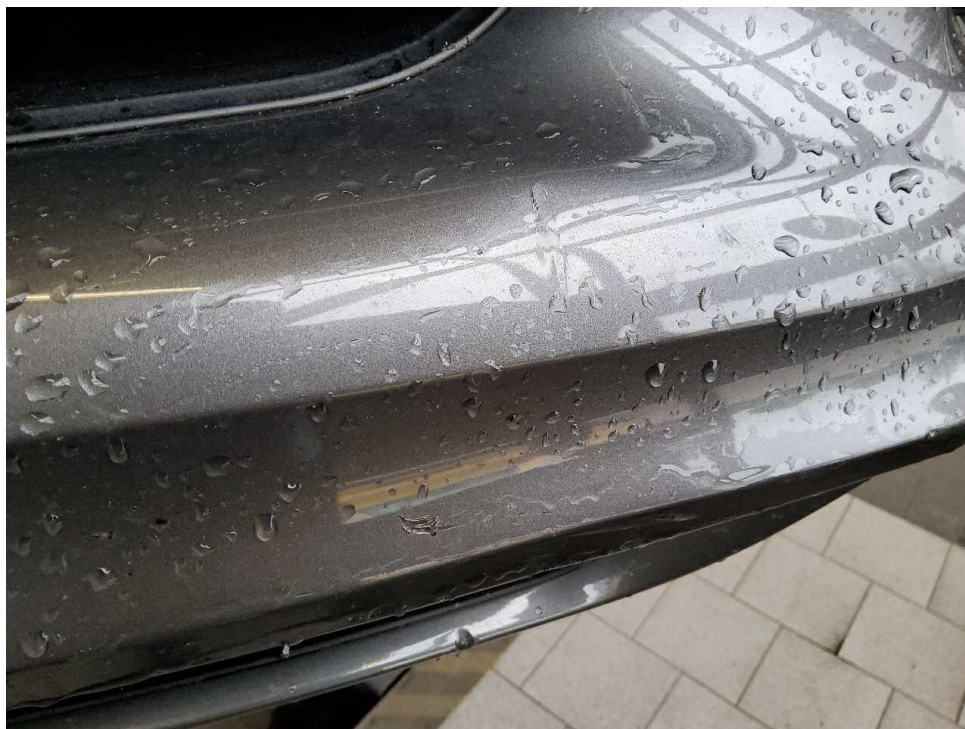
Bild 17 : Anfahrschaden Stoßfänger vorne
