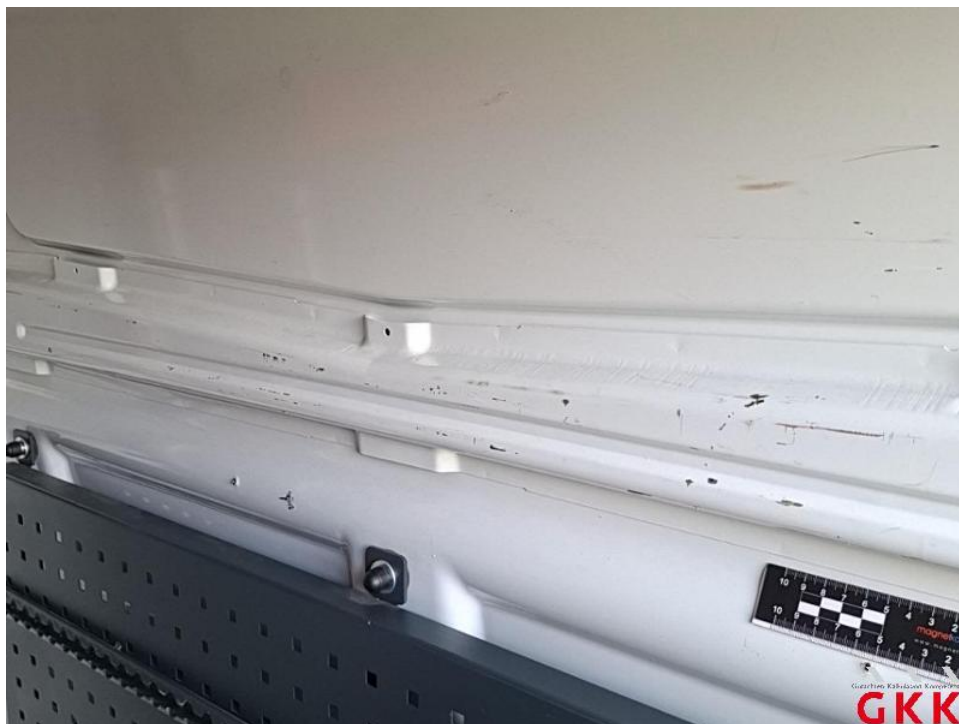
Bild 57. Trennwand, oberhalb, beschädigt, instand setzen - lackieren
