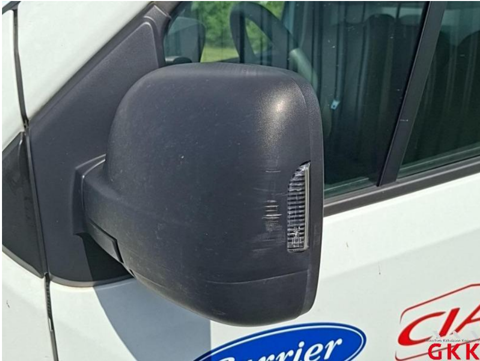
Bild 33. Spiegelgehäuse links, Kappe -unlackiert-, verkratzt, ersetzen
