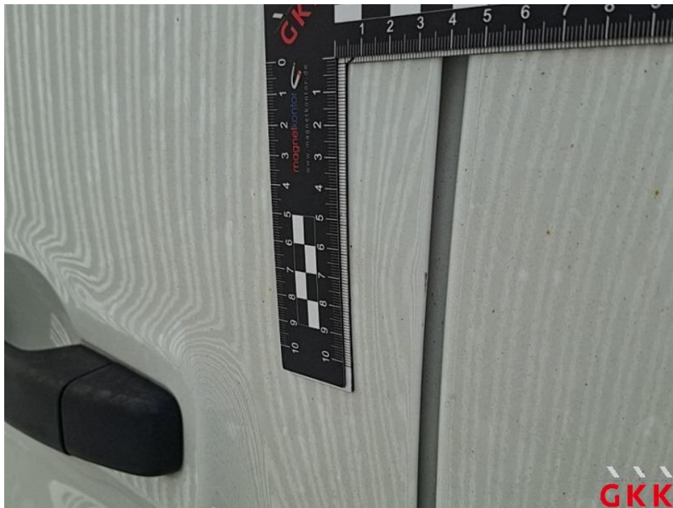
Bild 14. Hecktür links, bis 3 Dellen / Bauteil, Smartrepair
