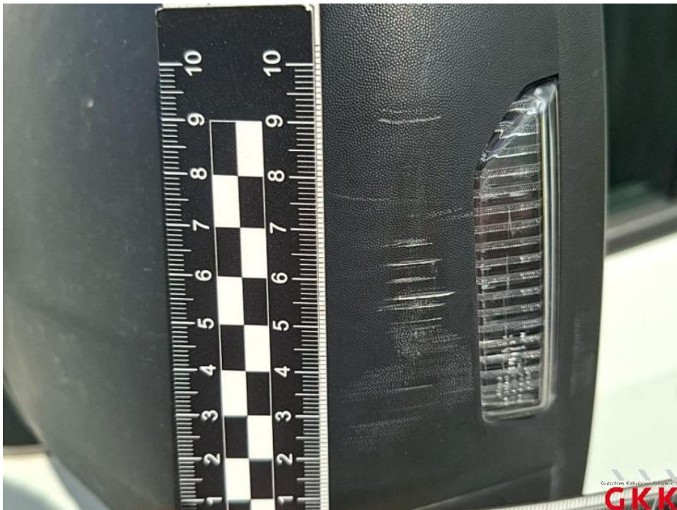
Bild 35. Spiegelgehäuse links, Kappe -unlackiert-, verkratzt, ersetzen
