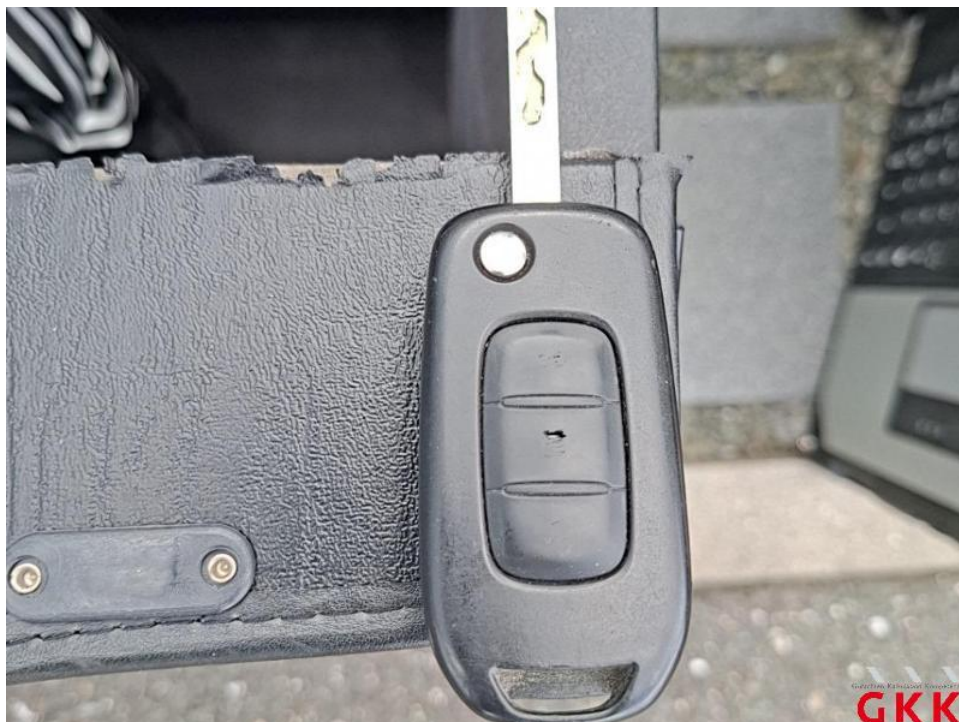
Bild 53. Hauptschlüssel, mit Fernbedienung, beschädigt, ersetzen
