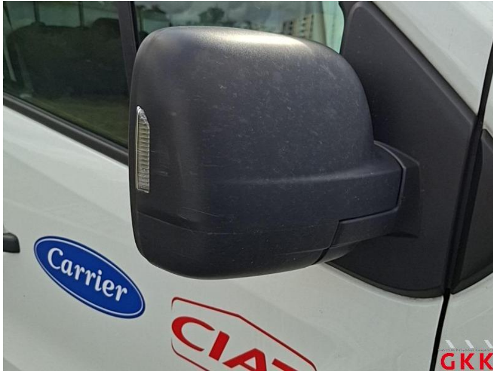
Bild 15. Spiegelgehäuse rechts, Kappe -unlackiert-, verkratzt, Smartrepair
