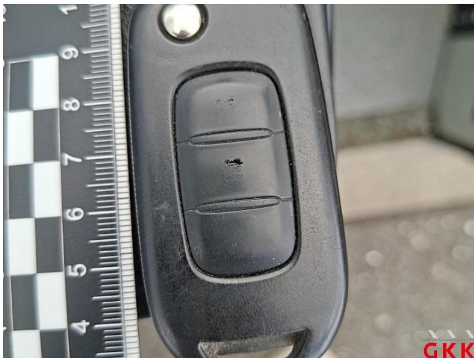
Bild 54. Hauptschlüssel, mit Fernbedienung, beschädigt, ersetzen
