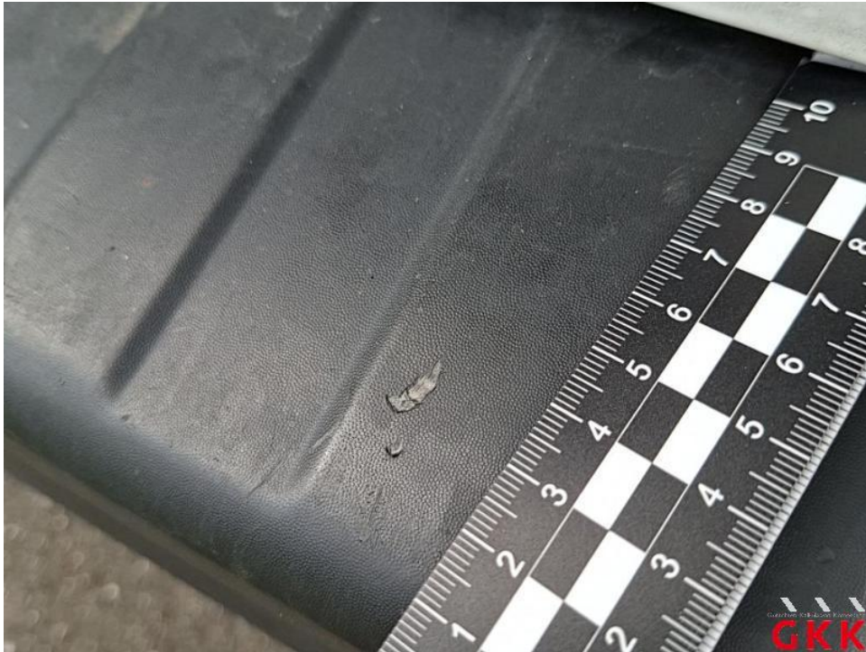
Bild 27. Stoßfänger hinten, Verkleidung -unlackiert-, verkratzt, ersetzen
