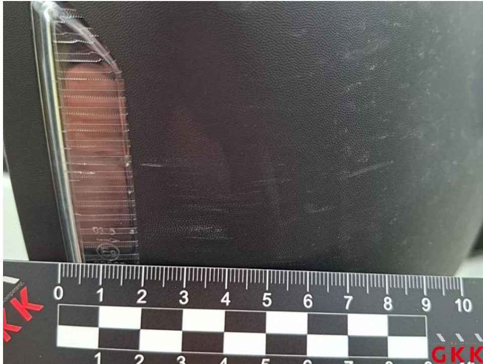
Bild 17. Spiegelgehäuse rechts, Kappe -unlackiert-, verkratzt, Smartrepair
