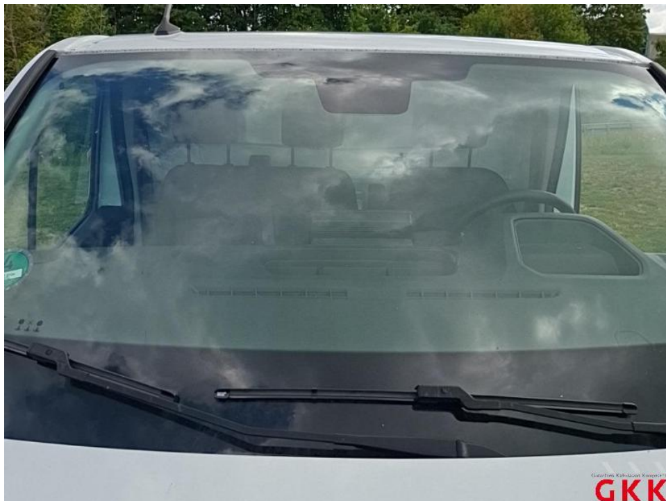
Bild 44. Frontscheibe, mit Regensensor, Steinschlag mit Rissbildung, ersetzen
