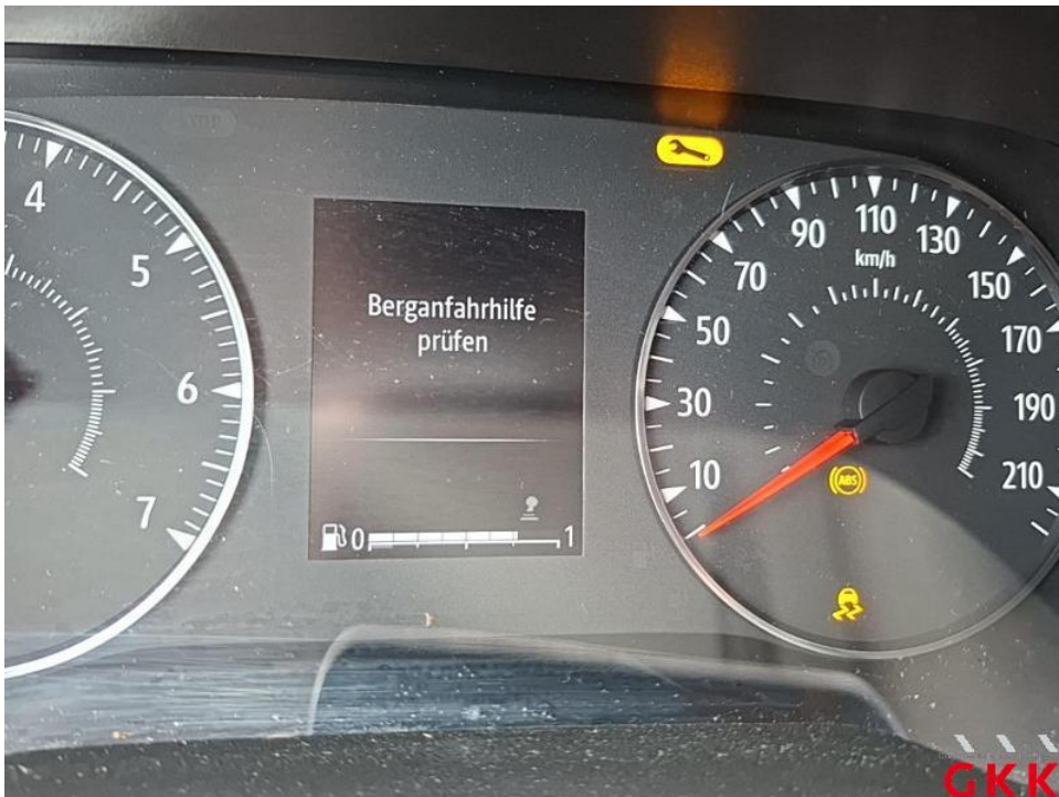
Bild 12. Kombiinstrument, Fehlerspeicher, aktiv, auslesen / prüfen
