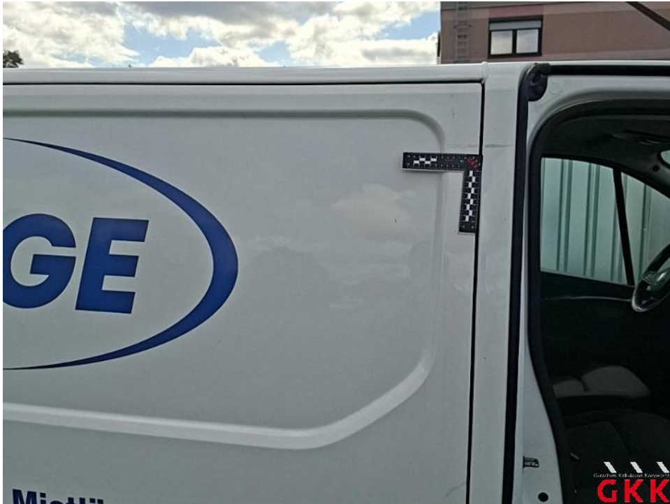
Bild 23. Schiebetür rechts, verkratzt, Smartrepair
