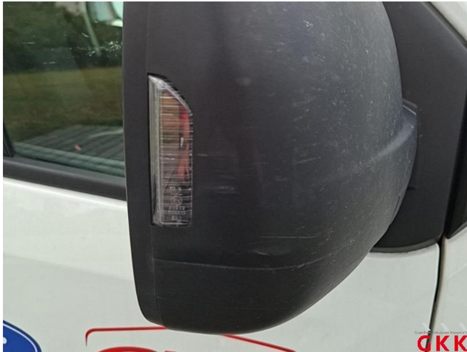
Bild 18. Spiegelgehäuse rechts, Blinker, verkratzt, ersetzen
