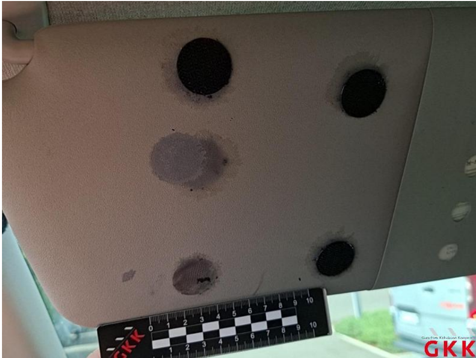
Bild 39. Sonnenblende, links, beschädigt, ersetzen
