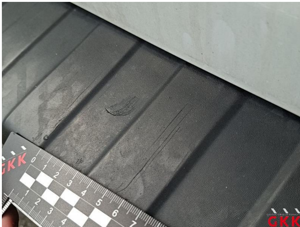
Bild 26. Stoßfänger hinten, Verkleidung -unlackiert-, verkratzt, ersetzen
