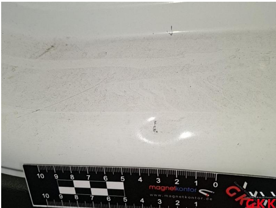
Bild 30. Schiebetür rechts, innen, beschädigt, Smartrepair
