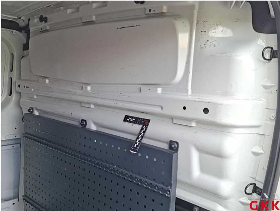
Bild 55. Trennwand, oberhalb, beschädigt, instand setzen - lackieren
