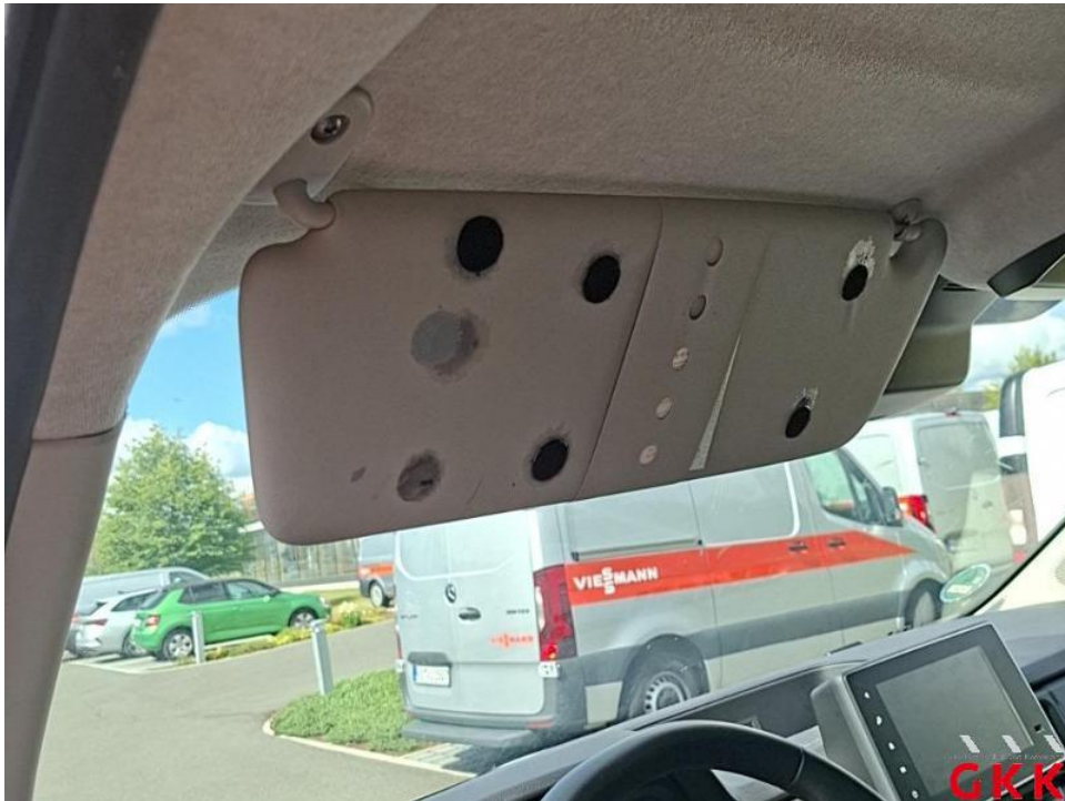
Bild 38. Sonnenblende, links, beschädigt, ersetzen
