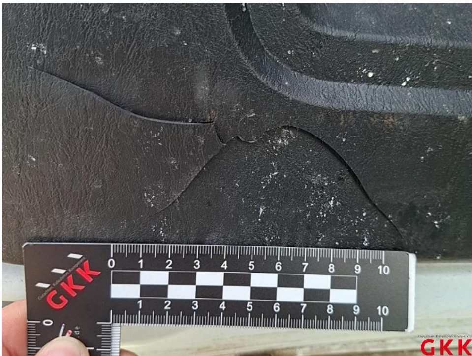
Bild 32. Hecktür links, Innenverkleidung, beschädigt, ersetzen
