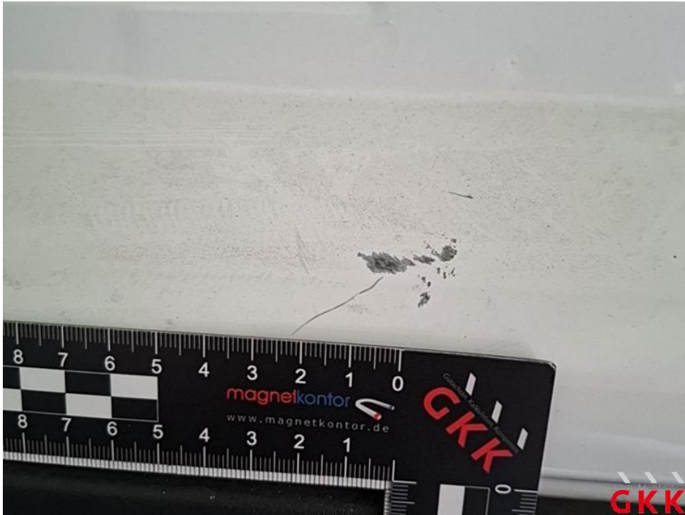
Bild 29. Schiebetür rechts, innen, beschädigt, Smartrepair
