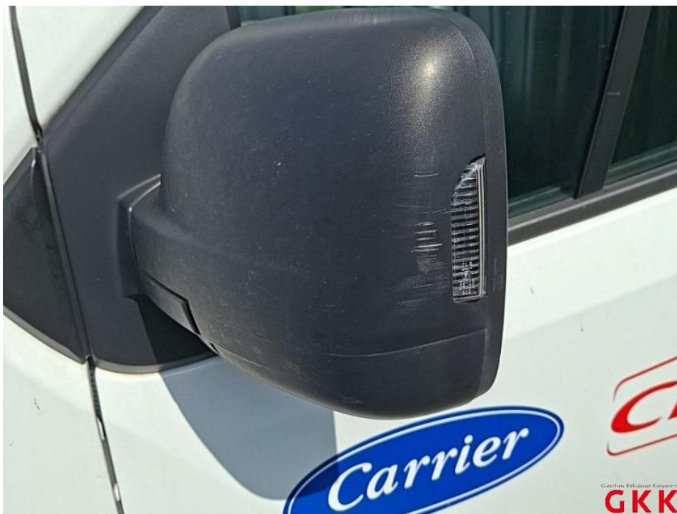
Bild 36. Spiegelgehäuse links, Blinker, verkratzt, ersetzen
