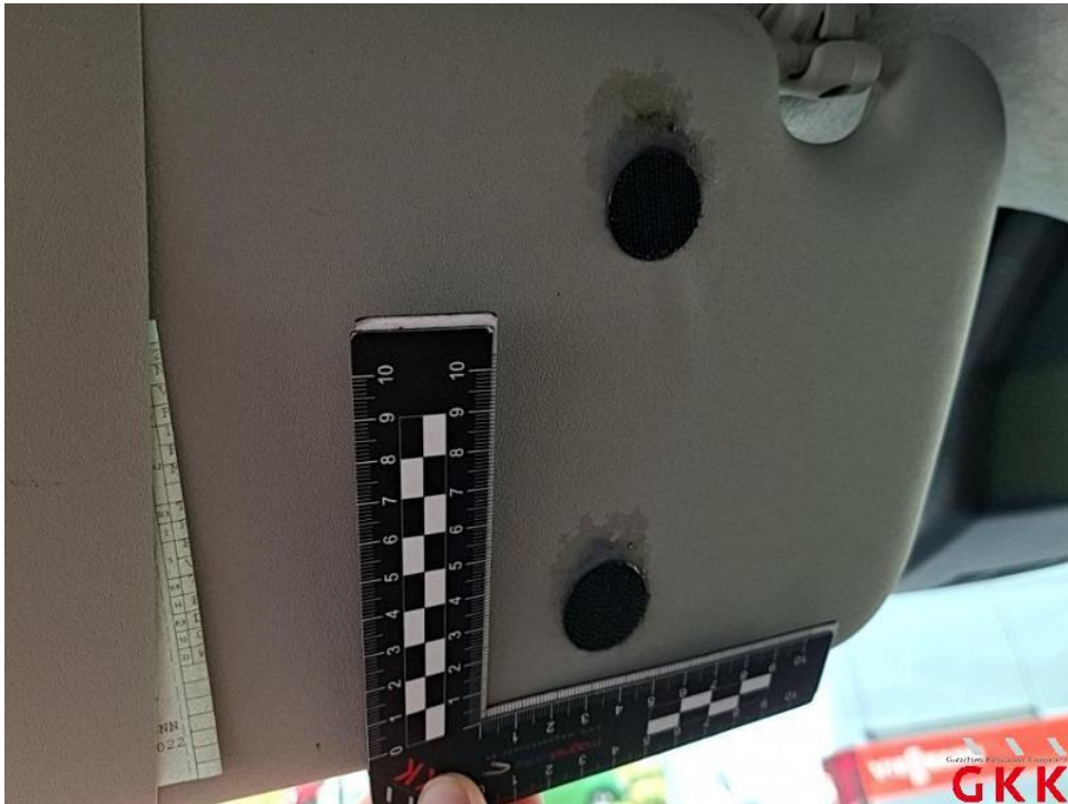
Bild 40. Sonnenblende, links, beschädigt, ersetzen
