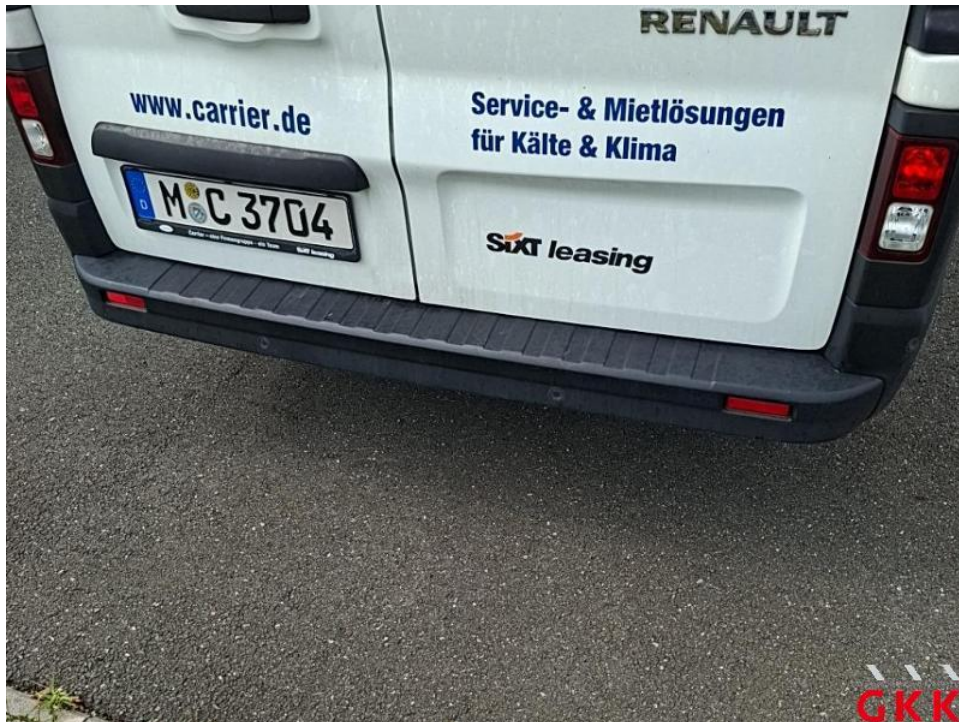
Bild 25. Stoßfänger hinten, Verkleidung -unlackiert-, verkratzt, ersetzen
