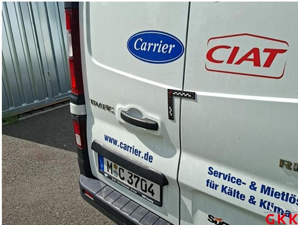
Bild 13. Hecktür links, bis 3 Dellen / Bauteil, Smartrepair
