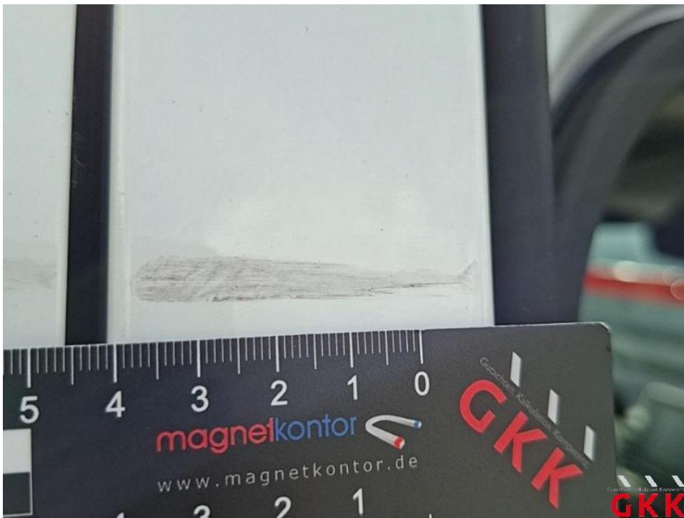
Bild 22. B- Säule rechts, verkratzt, Smartrepair
