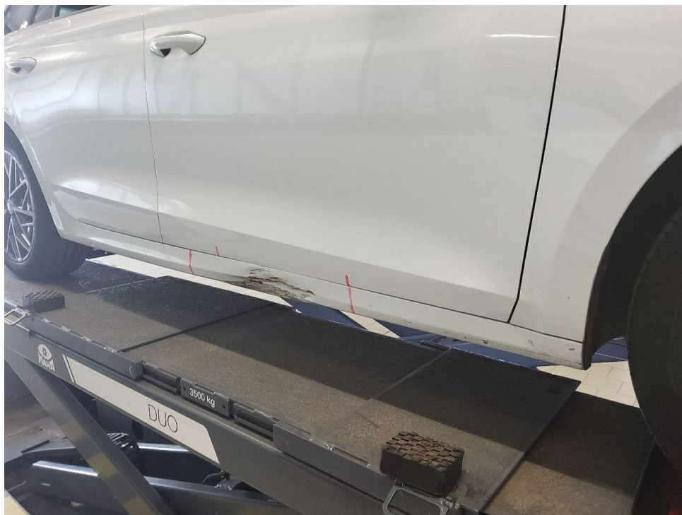
Bild 31 : Seitenschaden rechts, GA. anfordern, Schaden- und Kostenerweiterung möglich!
