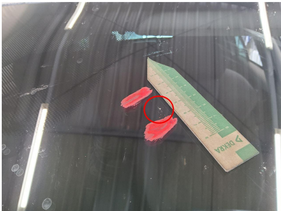
Bild 28 : Windschutzscheibe, Steinschlag mit Anriss / nicht beheizbar
