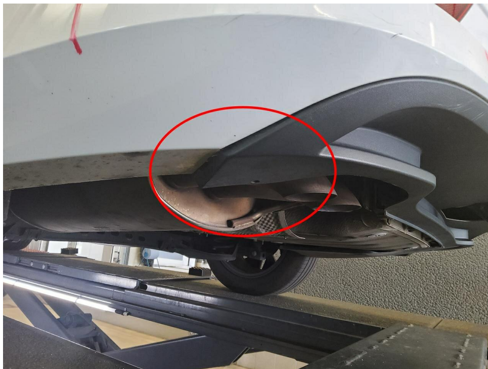
Bild 55 : Heckschaden, GA. anfordern, Schaden- und Kostenerweiterung möglich!
