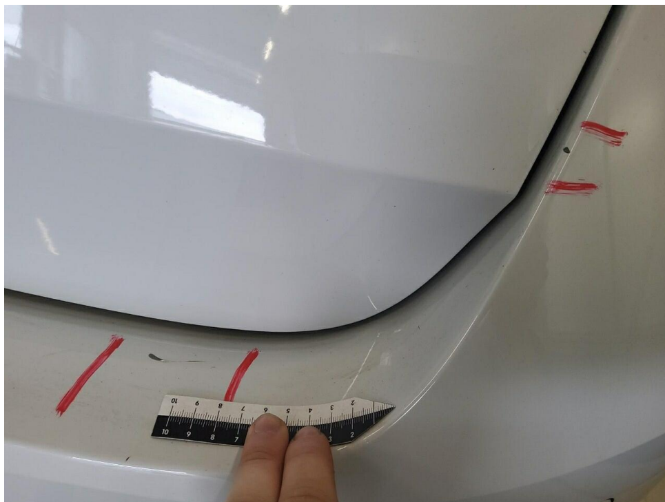
Bild 51 : Heckschaden, GA. anfordern, Schaden- und Kostenerweiterung möglich!
