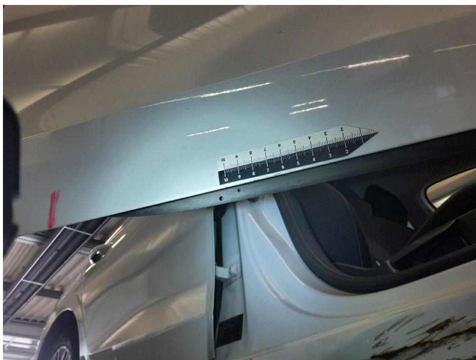
Bild 34 : Seitenschaden rechts, GA. anfordern, Schaden- und Kostenerweiterung möglich!
