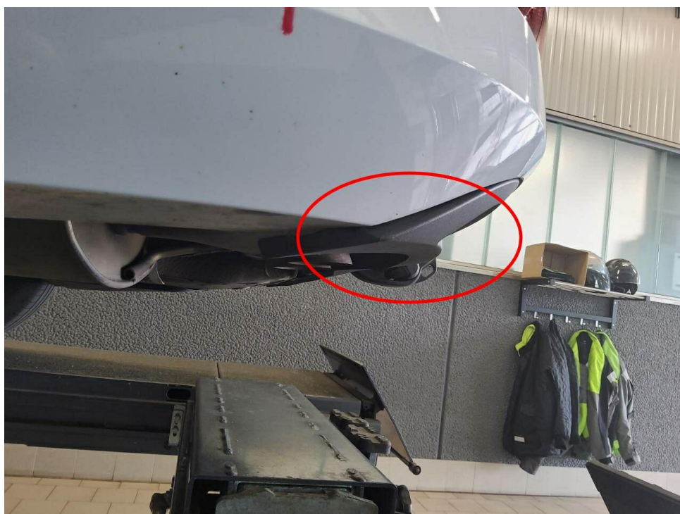
Bild 56 : Heckschaden, GA. anfordern, Schaden- und Kostenerweiterung möglich!
