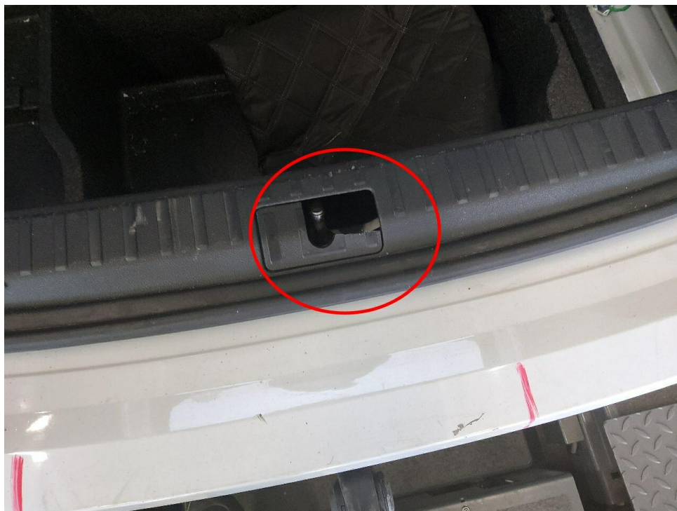
Bild 25 : Abdeckung Ladekante, zerbrochen
