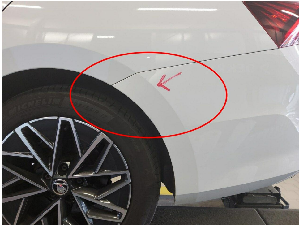
Bild 49 : Heckschaden, GA. anfordern, Schaden- und Kostenerweiterung möglich!
