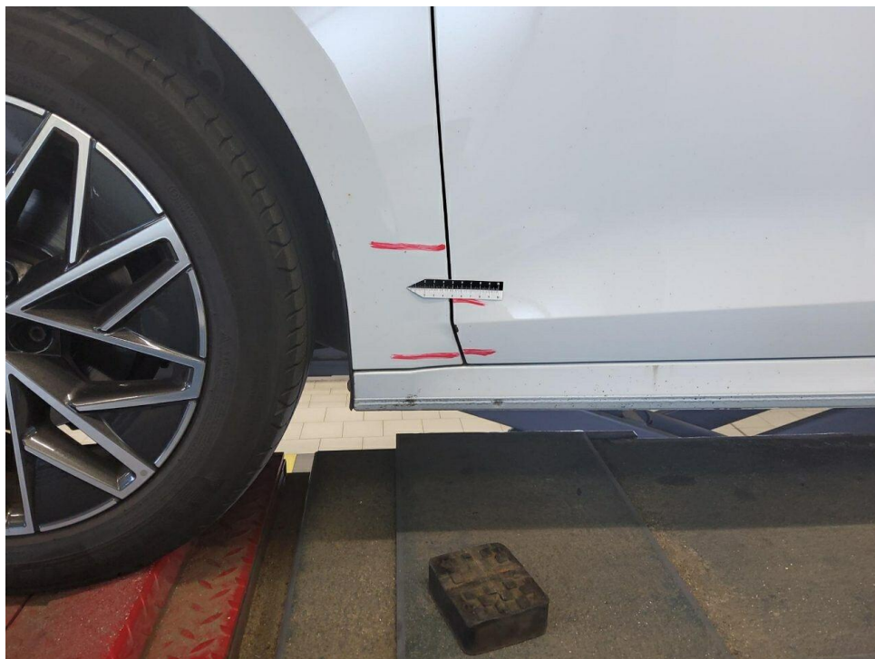
Bild 18 : Tür vorne links Lackierung, zerkratzt, smart repair
