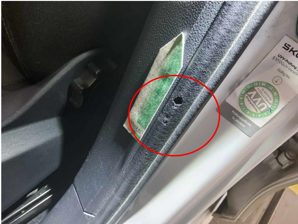
Bild 23 : Türdichtung vorne links, zerkratzt
