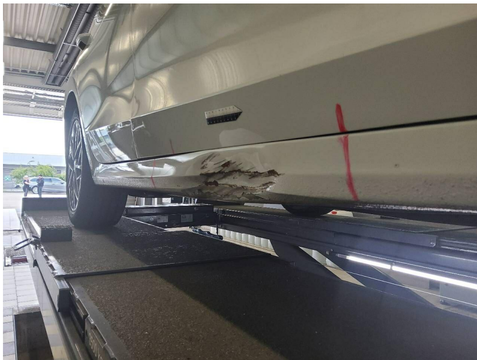
Bild 33 : Seitenschaden rechts, GA. anfordern, Schaden- und Kostenerweiterung möglich!
