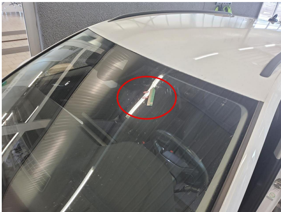
Bild 27 : Windschutzscheibe, Steinschlag mit Anriss / nicht beheizbar
