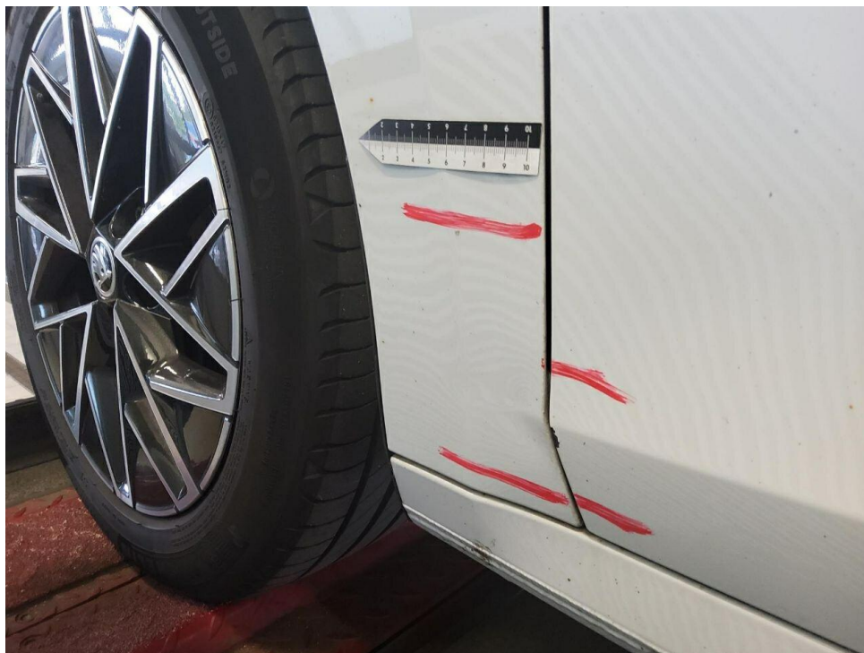
Bild 21 : Kotflügel vorne links, deformiert, instandsetzen und lackieren mit Lackaufbau
