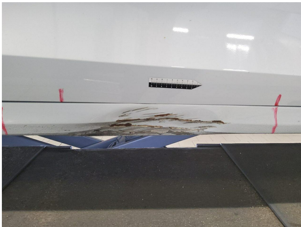
Bild 32 : Seitenschaden rechts, GA. anfordern, Schaden- und Kostenerweiterung möglich!
