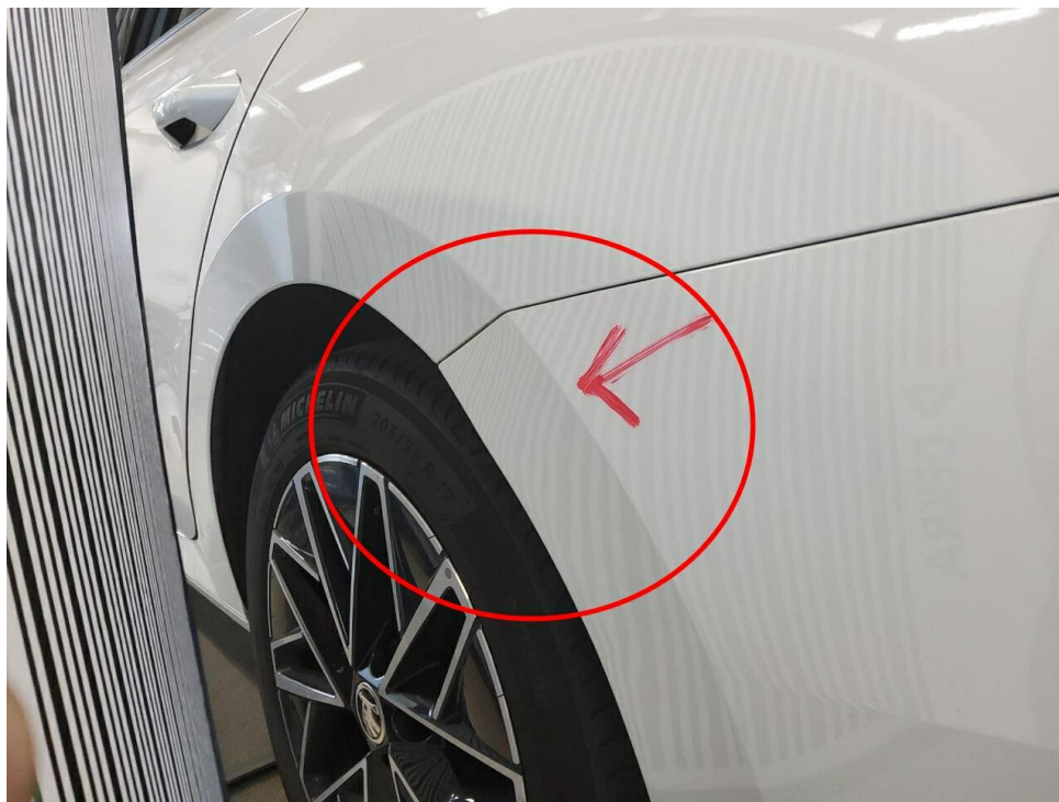
Bild 48 : Heckschaden, GA. anfordern, Schaden- und Kostenerweiterung möglich!
