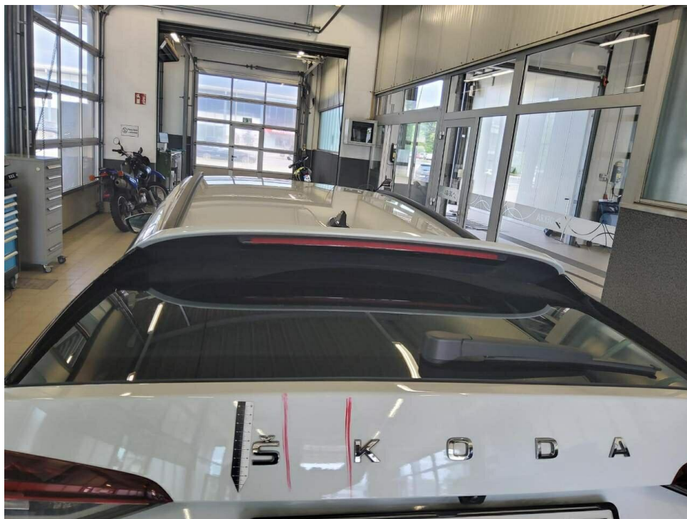
Bild 15 : Heckklappe, eingedellt, smart repair
