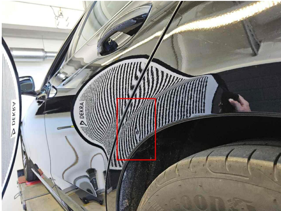
Bild 17 : Seitenwand links, eingedellt
