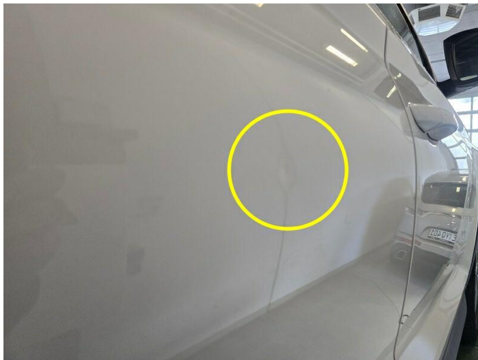
Bild 14 : Tür hinten rechts, eingedellt, drücken
