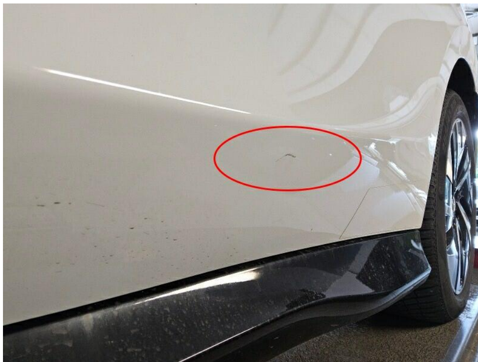
Bild 14 : Tür hinten links Lackierung, zerkratzt, lackieren
