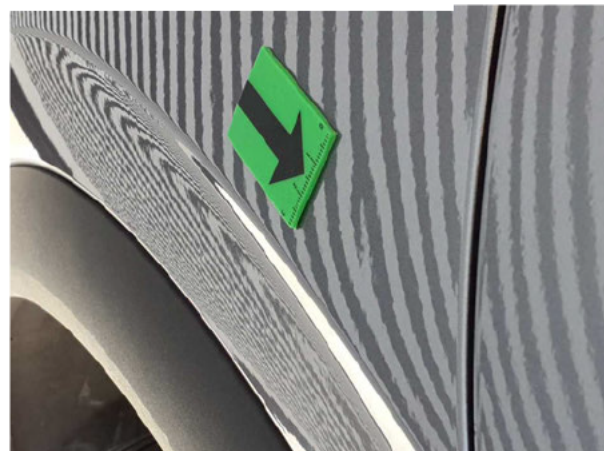
Beschädigung #4: Seitenwand rechts: Seitenwand - Delle(n) - sanft instandsetzen
