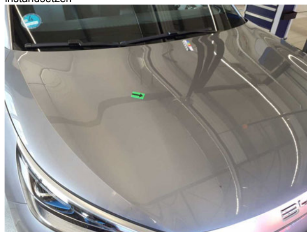
Beschädigung #3: Motorhaube: Motorhaube - Delle(n) - sanft instandsetzen
