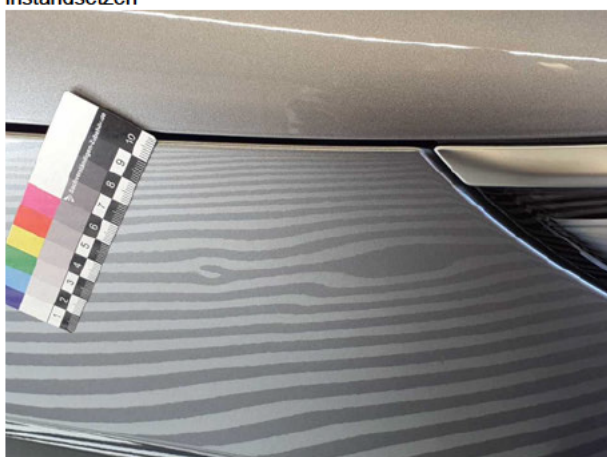
Beschädigung #5: Kotflügel rechts: Kotflügel rechts - Delle(n) - sanft instandsetzen
