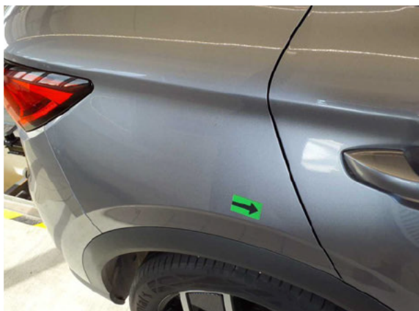
Beschädigung #4: Seitenwand rechts: Seitenwand - Delle(n) - sanft instandsetzen
