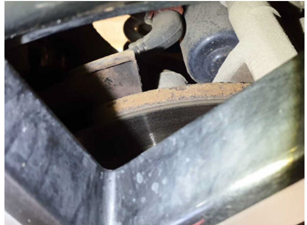
Beschädigung #8: Bremsanlage: Bremsscheiben hinten - verschlissen - erneuern
