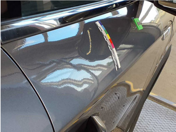
Beschädigung #7: Tür vorn rechts: Tür - Delle(n) - sanft instandsetzen
