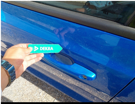
Puerta / Delantero Izquierdo / Abolladura
