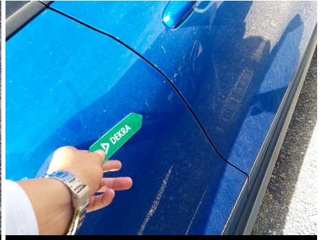
Puerta / Trasero Derecho / Abolladura
