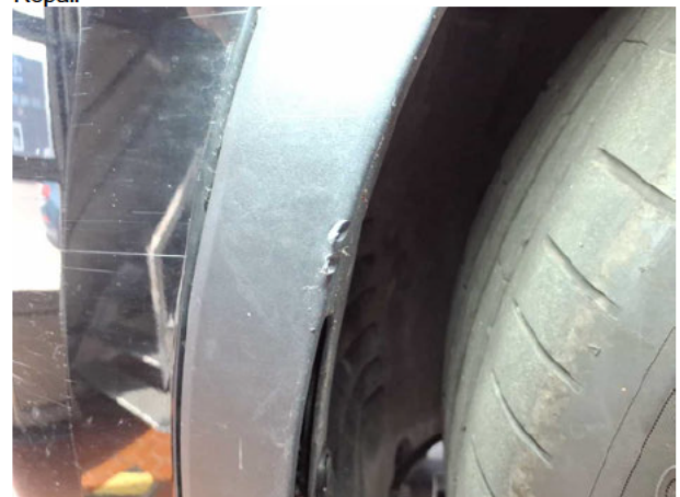
Beschädigung #3: Kotflügel links: Radlauf - verkratzt / verschürft - erneuern
