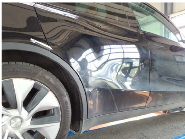
Beschädigung #14: Tür hinten rechts: Tür - verformt - erneuern
