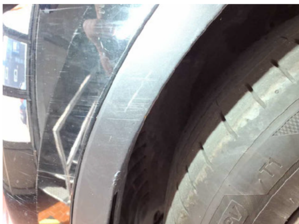
Beschädigung #3: Kotflügel links: Radlauf - verkratzt / verschürft - erneuern
