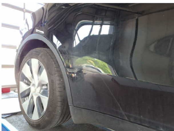
Beschädigung #14: Tür hinten rechts: Tür - verformt - erneuern
