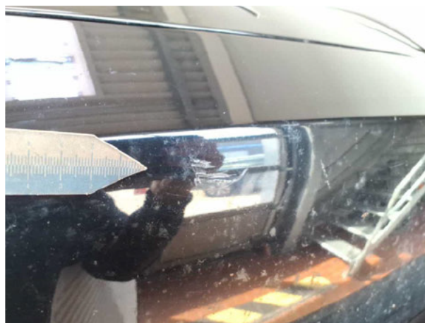
Beschädigung #7: Stossfänger vorn: Stossfänger vorn - verkratzt / verschürft - lackieren
