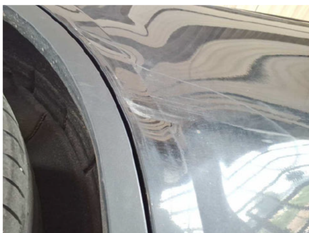
Beschädigung #14: Tür hinten rechts: Tür - verformt - erneuern
