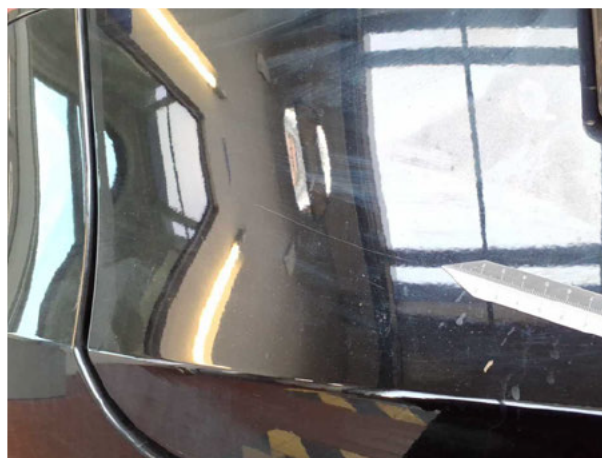
Beschädigung #6: Heckklappe/-tür: Heckklappe - Delle / Lackschaden - Smart Repair
