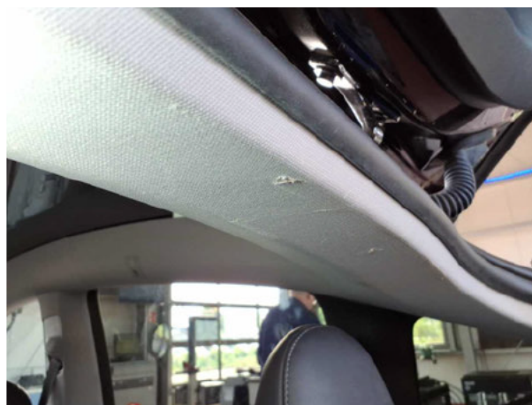
Beschädigung #8: Verkleidungen/Abdeckungen: Dachhimmel (Hinten) - verkratzt / verschürft - erneuern
