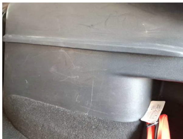
Beschädigung #5: Verkleidungen/Abdeckungen: Verkleidungen/Abdeckungen (Innenraum) - Kratzer - Wertminderung
