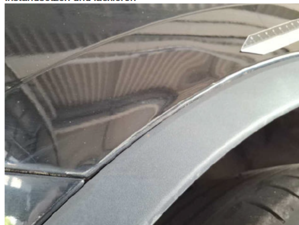
Beschädigung #13: Seitenwand rechts: Seitenwand - verformt - instandsetzen und lackieren
