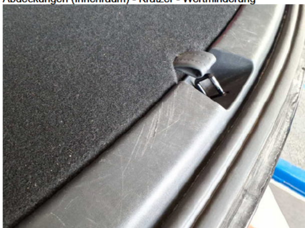
Beschädigung #5: Verkleidungen/Abdeckungen: Verkleidungen/Abdeckungen (Innenraum) - Kratzer - Wertminderung
