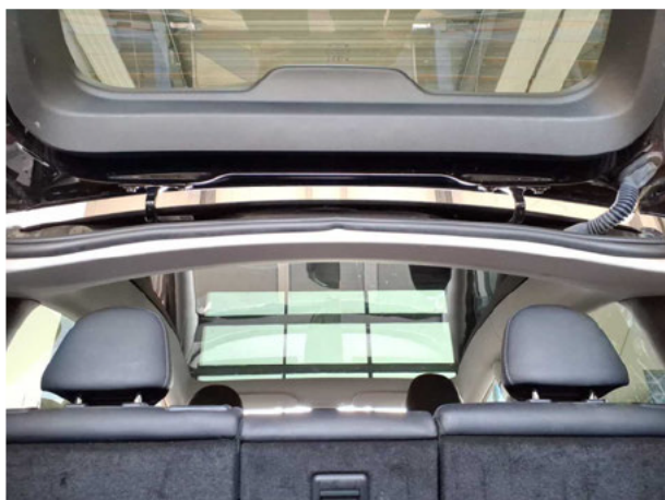
Beschädigung #8: Verkleidungen/Abdeckungen: Dachhimmel (Hinten) - verkratzt / verschürft - erneuern
