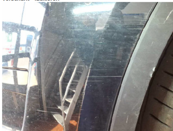
Beschädigung #7: Stossfänger vorn: Stossfänger vorn - verkratzt / verschürft - lackieren
