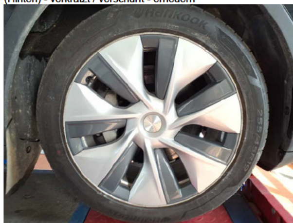
Beschädigung #9: Rad/Reifen: Leichtmetallfelge vorn rechts - verkratzt / verschürft - erneuern
