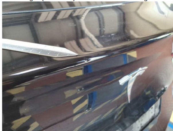
Beschädigung #6: Heckklappe/-tür: Heckklappe - Delle / Lackschaden - Smart Repair
