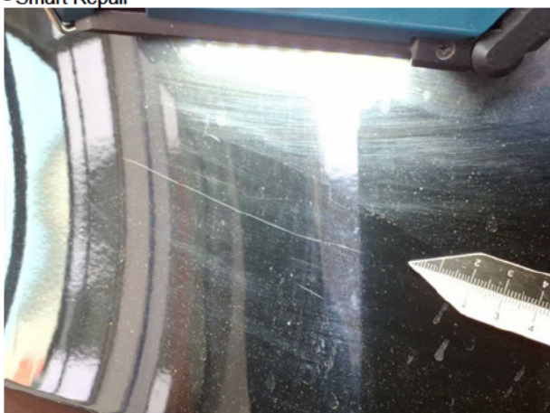
Beschädigung #6: Heckklappe/-tür: Heckklappe - Delle / Lackschaden - Smart Repair
