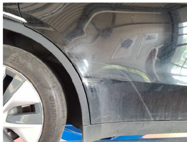
Beschädigung #14: Tür hinten rechts: Tür - verformt - erneuern
