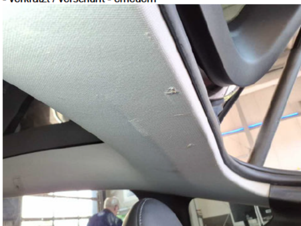
Beschädigung #8: Verkleidungen/Abdeckungen: Dachhimmel (Hinten) - verkratzt / verschürft - erneuern
