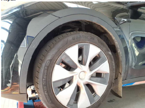
Beschädigung #3: Kotflügel links: Radlauf - verkratzt / verschürft - erneuern
