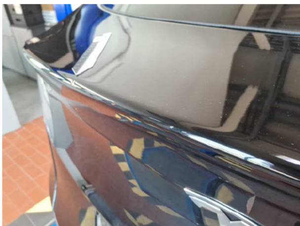
Beschädigung #6: Heckklappe/-tür: Heckklappe - Delle / Lackschaden - Smart Repair
