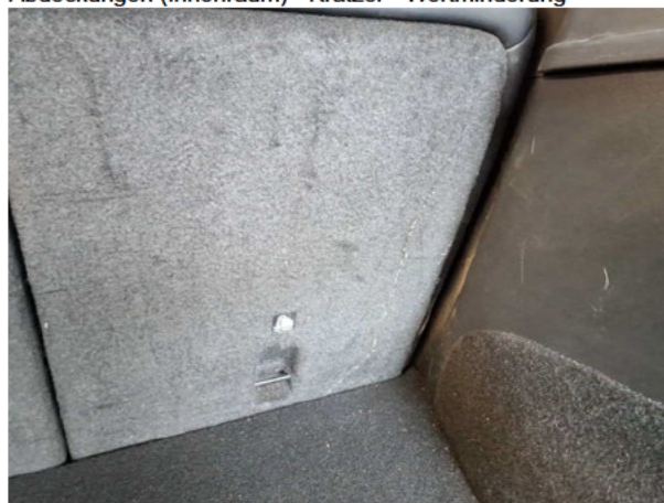
Beschädigung #5: Verkleidungen/Abdeckungen: Verkleidungen/Abdeckungen (Innenraum) - Kratzer - Wertminderung
