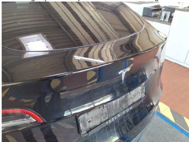
Beschädigung #6: Heckklappe/-tür: Heckklappe - Delle / Lackschaden - Smart Repair
