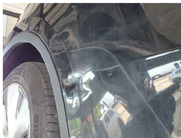
Beschädigung #14: Tür hinten rechts: Tür - verformt - erneuern
