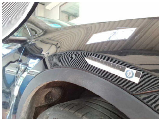
Beschädigung #12: Kotflügel rechts: Kotflügel rechts - verformt - instandsetzen und lackieren
