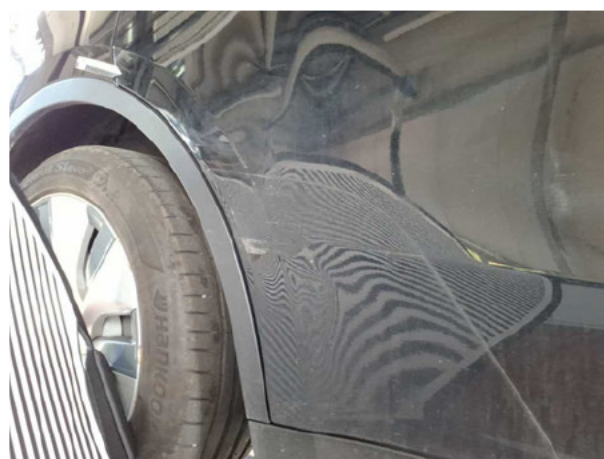
Beschädigung #14: Tür hinten rechts: Tür - verformt - erneuern
