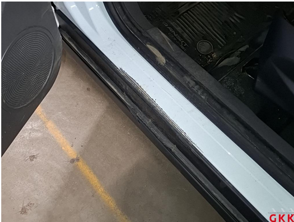
Bild 33 Tür vorne links, Einstieg, verkratzt, lackieren
