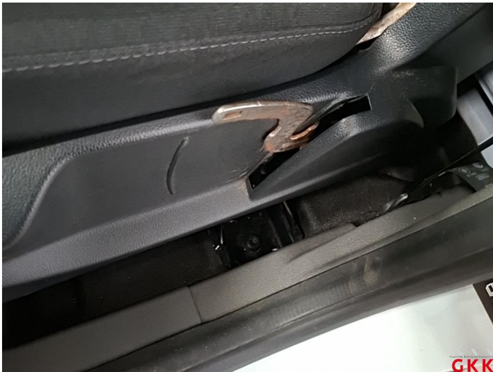
Bild 20 Griff Sitz Höhenverstellung V.L., fehlt, ersetzen
