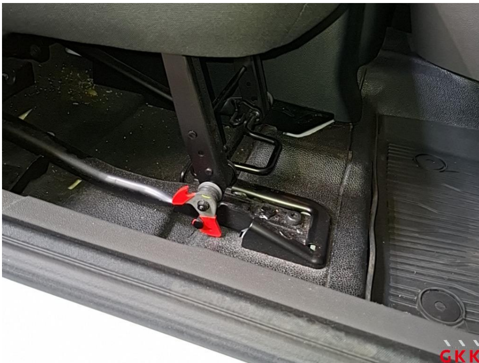
Bild 16 Sitz vorne rechts, Verkleidung, fehlt, ersetzen
