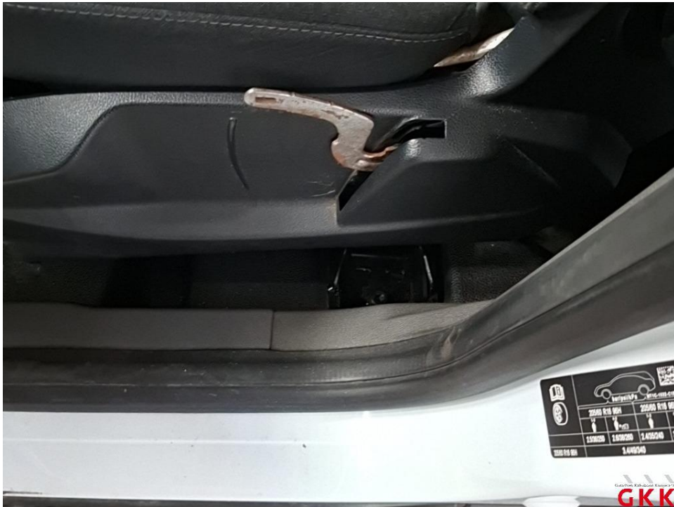
Bild 19 Griff Sitz Höhenverstellung V.L., fehlt, ersetzen
