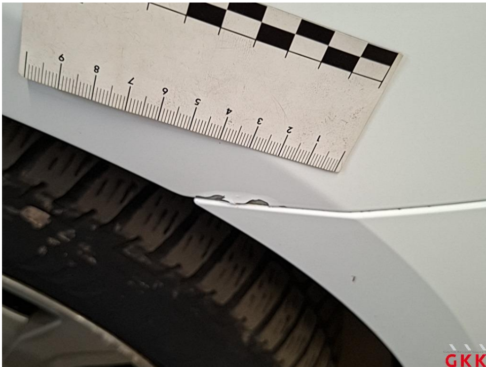
Bild 27 Kotflügel vorne rechts, Lackierung abgeplatzt, lackieren
