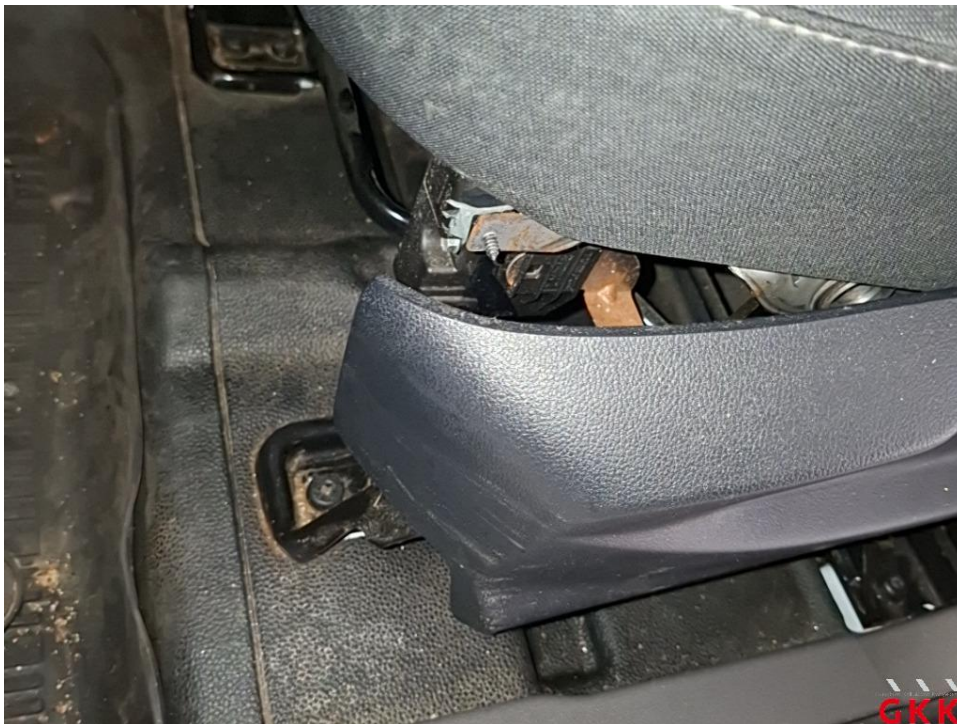
Bild 18 Sitz vorne links, Verkleidung, beschädigt, ersetzen
