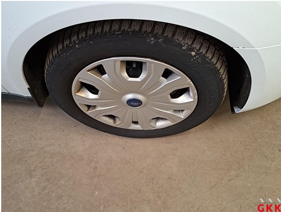
Bild 24 Radkappe(n), vorne rechts, beschädigt, ersetzen
