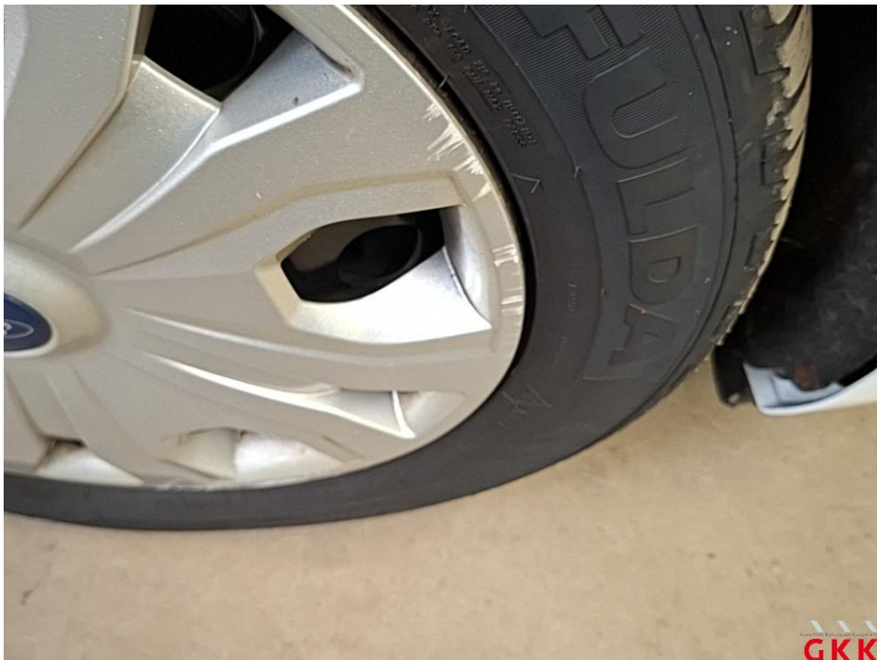
Bild 25 Radkappe(n), vorne rechts, beschädigt, ersetzen
