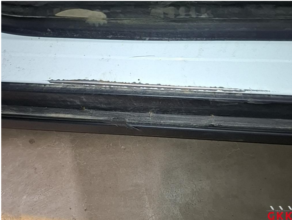
Bild 34 Tür vorne links, Einstieg, verkratzt, lackieren
