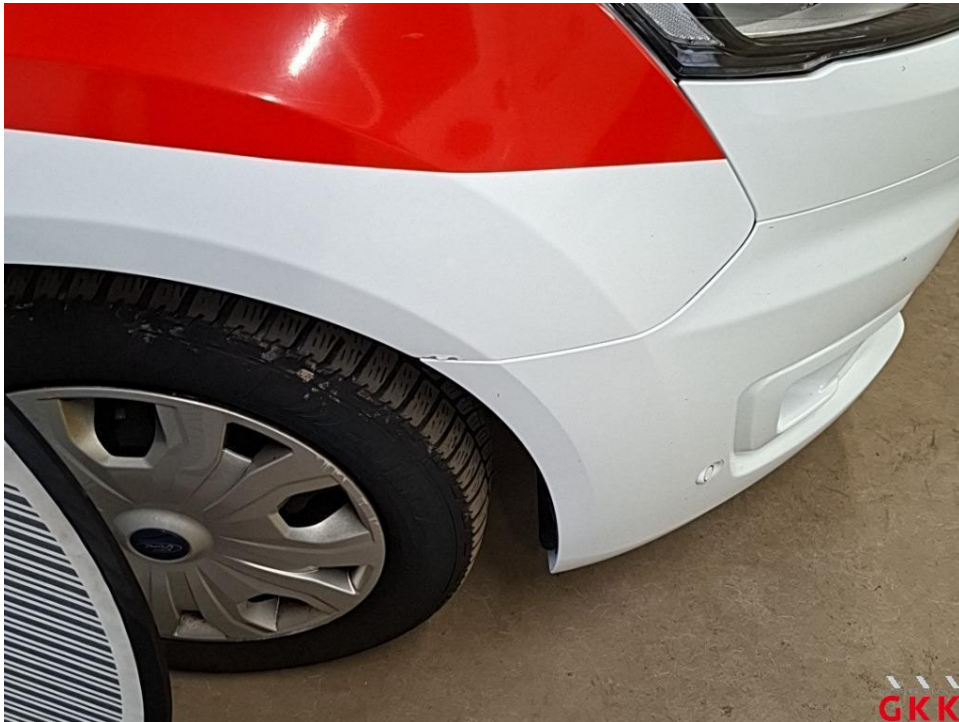
Bild 26 Kotflügel vorne rechts, Lackierung abgeplatzt, lackieren
