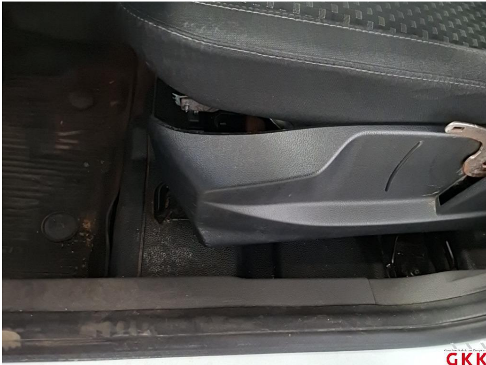
Bild 17 Sitz vorne links, Verkleidung, beschädigt, ersetzen
