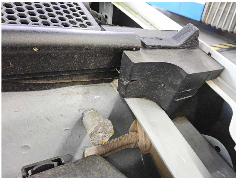
Bild 19 : Tierversbiss Antennenstab, Tierversbiss Motorraum
