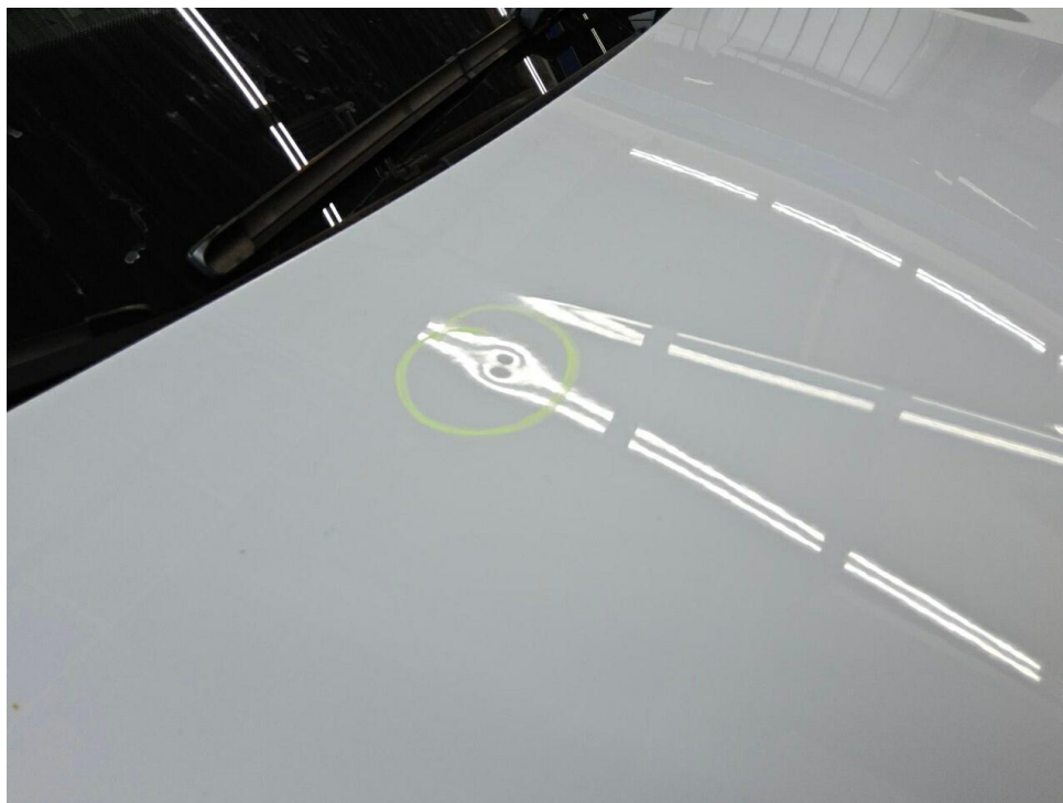
Bild 13 : Motorhaube, eingedellt, drücken
