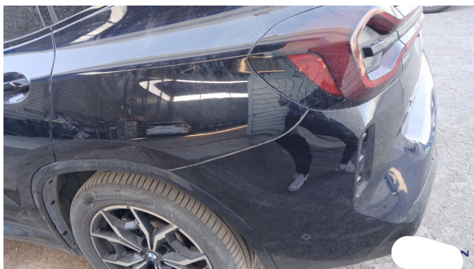
5. parete laterale - posteriore - sinistra Graffi superficiali
