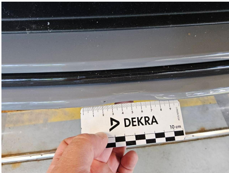
Bild 21 : Stoßfänger und Blende vorne rechts und gebrochen
