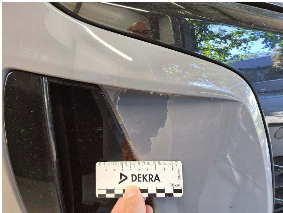
Bild 24 : Stoßfänger und Blende vorne rechts und gebrochen
