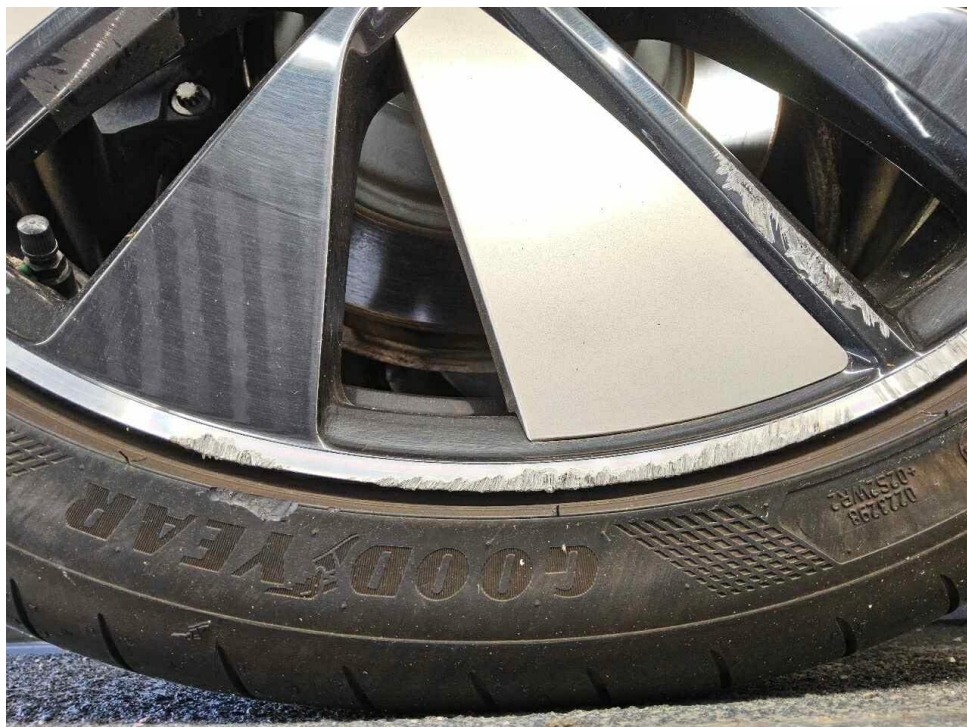
Bild 16 : Alufelge vorne und hinten rechts zerkratzt glanzgedreht
