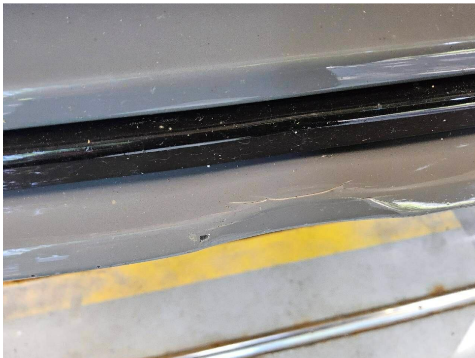
Bild 20 : Stoßfänger und Blende vorne rechts und gebrochen
