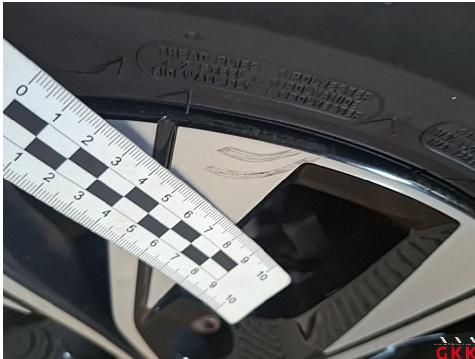
Bild 18 LM-Rad, vorne rechts, Materialabtrag, ersetzen
