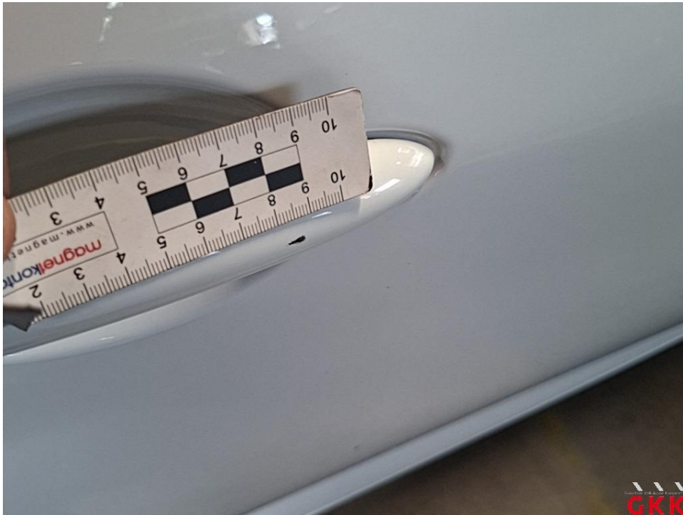
Bild 25 Tür vorne rechts, Griff, verkratzt, lackieren
