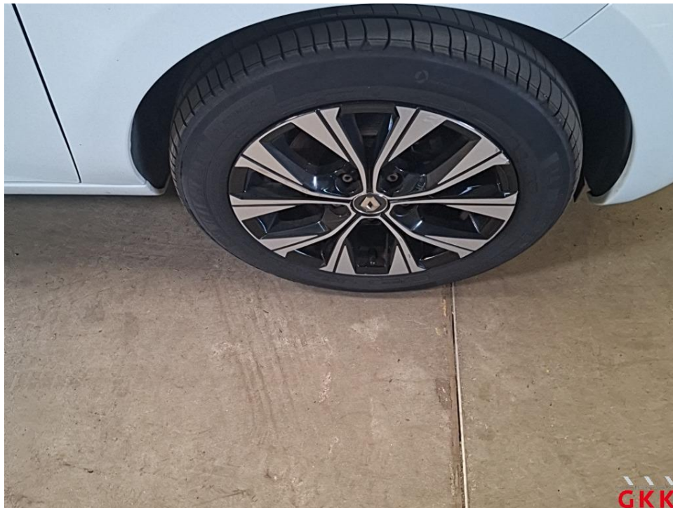
Bild 16 LM-Rad, vorne rechts, Materialabtrag, ersetzen
