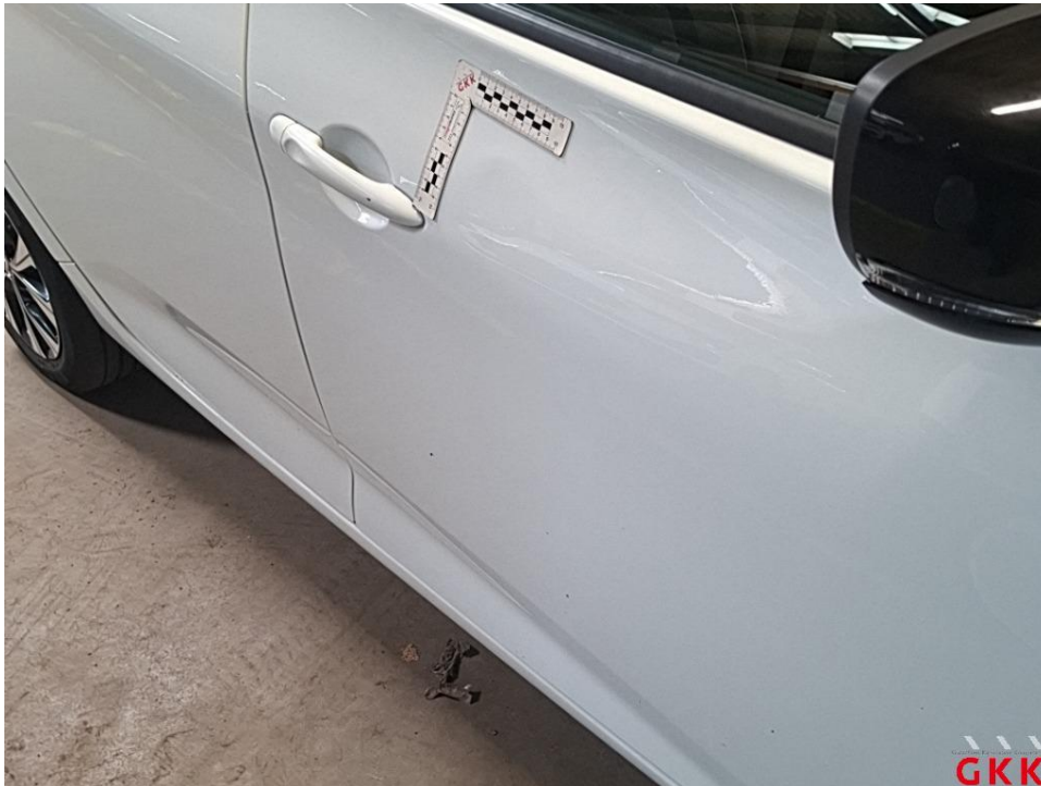
Bild 29 Tür vorne rechts, beschädigt, instand setzen - lackieren
