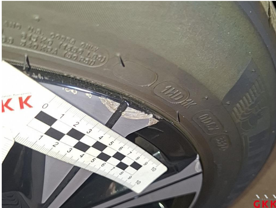
Bild 17 LM-Rad, vorne rechts, Materialabtrag, ersetzen
