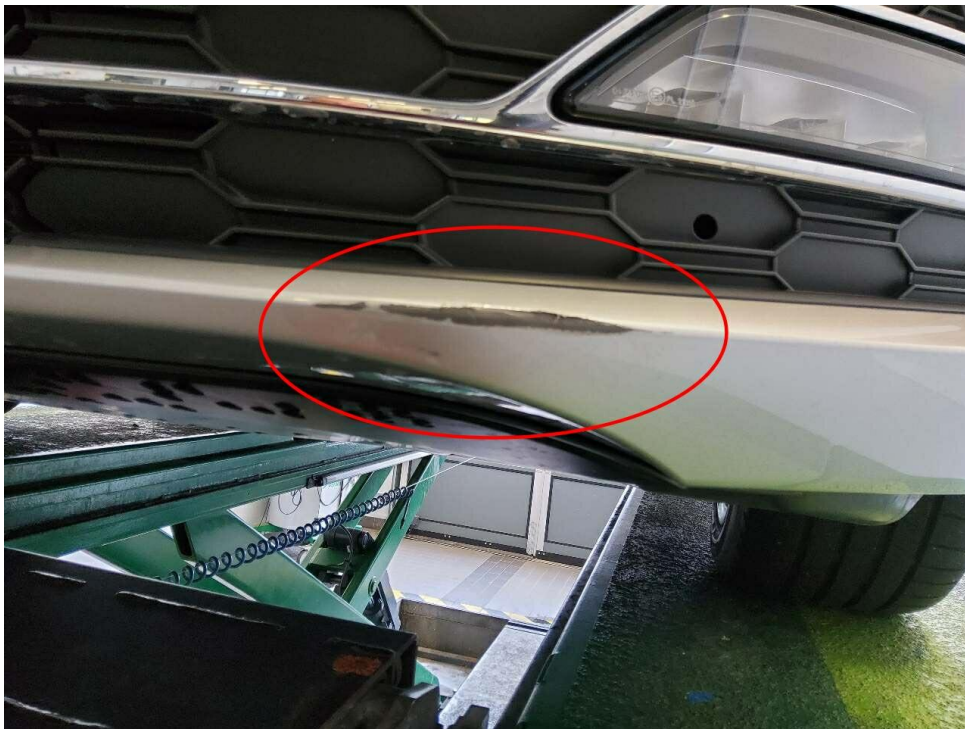
Bild 15 : Stoßfänger vorn links verschrammt mit Materialabtrag
