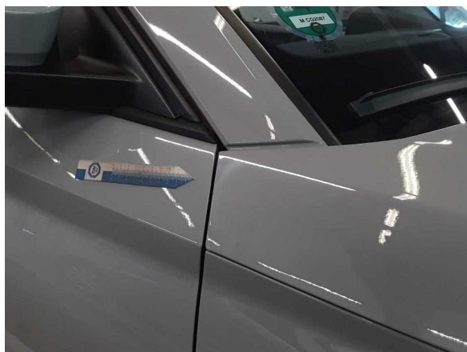
Damage 2: Bonnet: Bonnet (Farbnebel, Mehrkosten sind möglich) - Unprofessionally repaired - Conditioning
