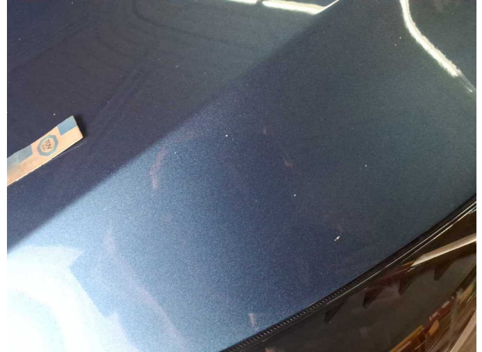
Damage 3: Bonnet: Bonnet (Sandstrahleffekt) - Stone chips - Paint
