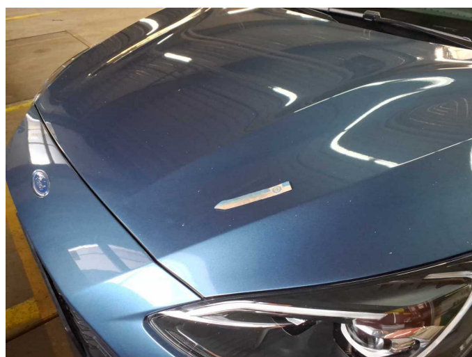
Damage 3: Bonnet: Bonnet (Sandstrahleffekt) - Stone chips - Paint
