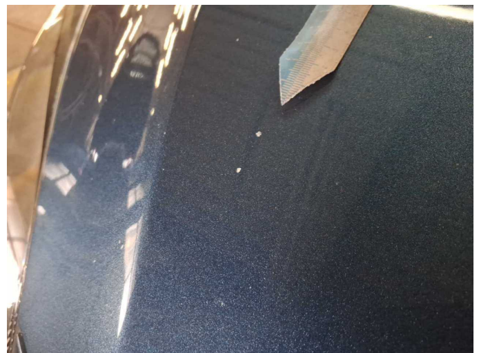
Damage 3: Bonnet: Bonnet (Sandstrahleffekt) - Stone chips - Paint
