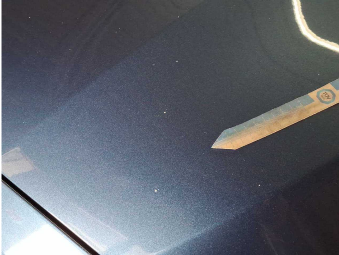
Damage 3: Bonnet: Bonnet (Sandstrahleffekt) - Stone chips - Paint
