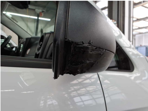
Beschädigung #2: Außenspiegel rechts: Spiegelgehäuse - beschädigt - erneuern
