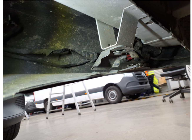
Beschädigung #5: Stossfänger hinten: Stossfänger hinten - gebrochen / gerissen - erneuern
