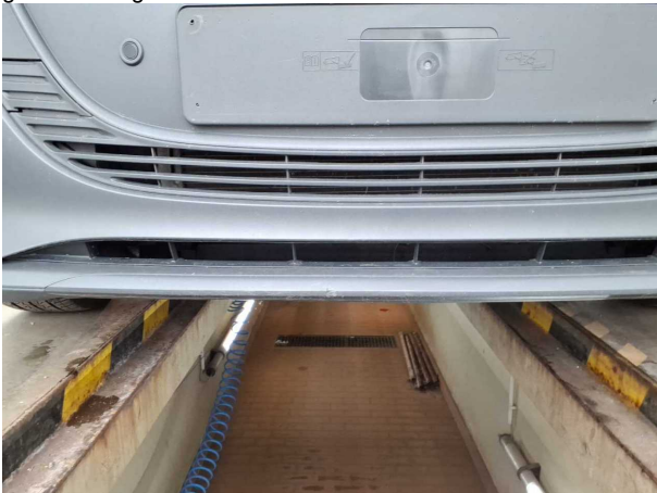
Beschädigung #6: Stossfänger vorn: Stossfänger vorn - verformt - erneuern
