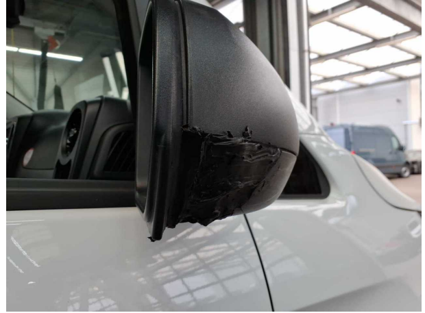
Beschädigung #1: Außenspiegel rechts: Abdeckkappe - beschädigt - erneuern
