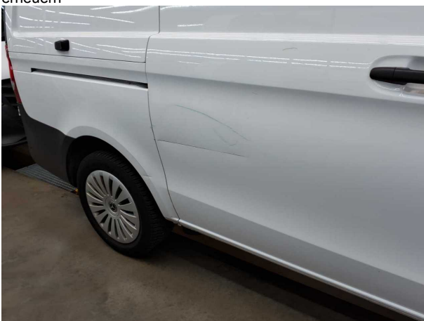
Beschädigung #7: Schiebetür rechts: Schiebetür - Delle / Lackschad... - instandsetzen/lackieren (S1)
