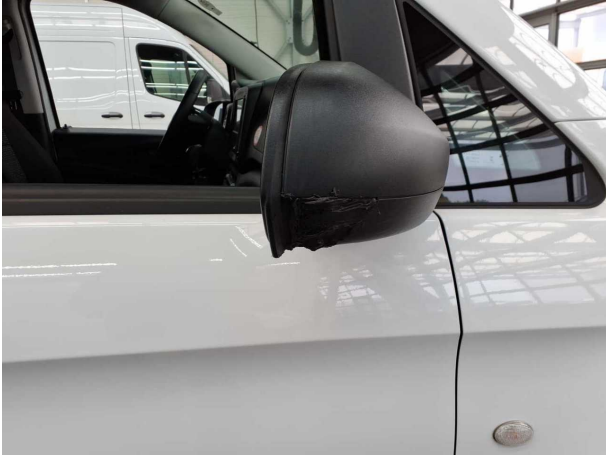
Beschädigung #1: Außenspiegel rechts: Abdeckkappe - beschädigt - erneuern
