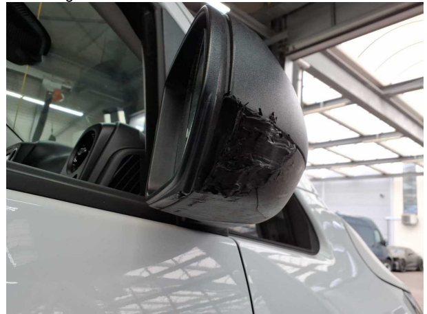
Beschädigung #3: Außenspiegel rechts: Rahmen - beschädigt - erneuern
