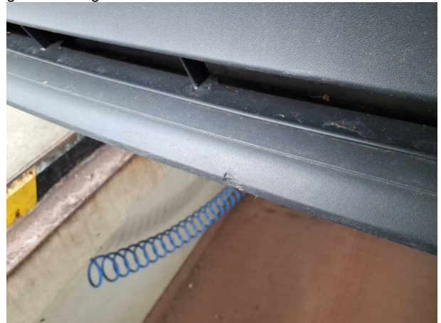
Beschädigung #6: Stossfänger vorn: Stossfänger vorn - verformt - erneuern
