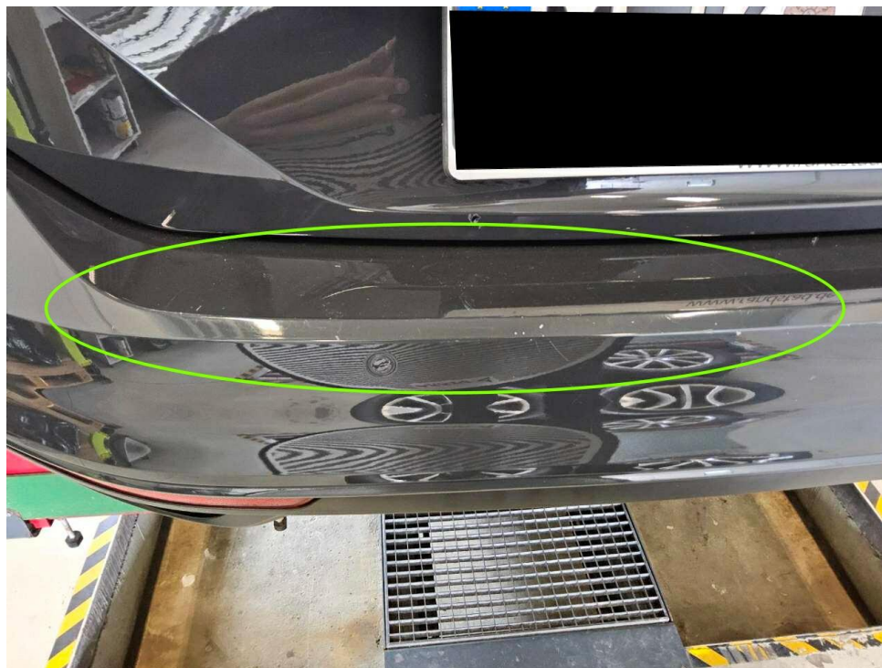
Bild 18 : Stoßfänger hinten, zerkratzt, lackieren
