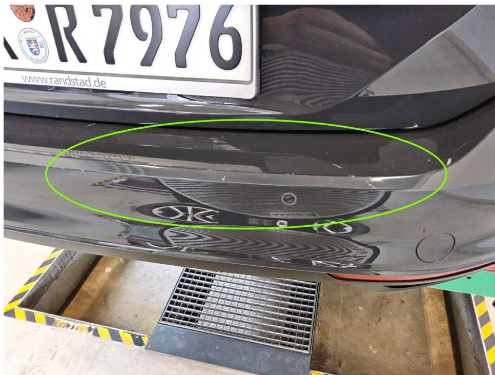
Bild 17 : Stoßfänger hinten, zerkratzt, lackieren
