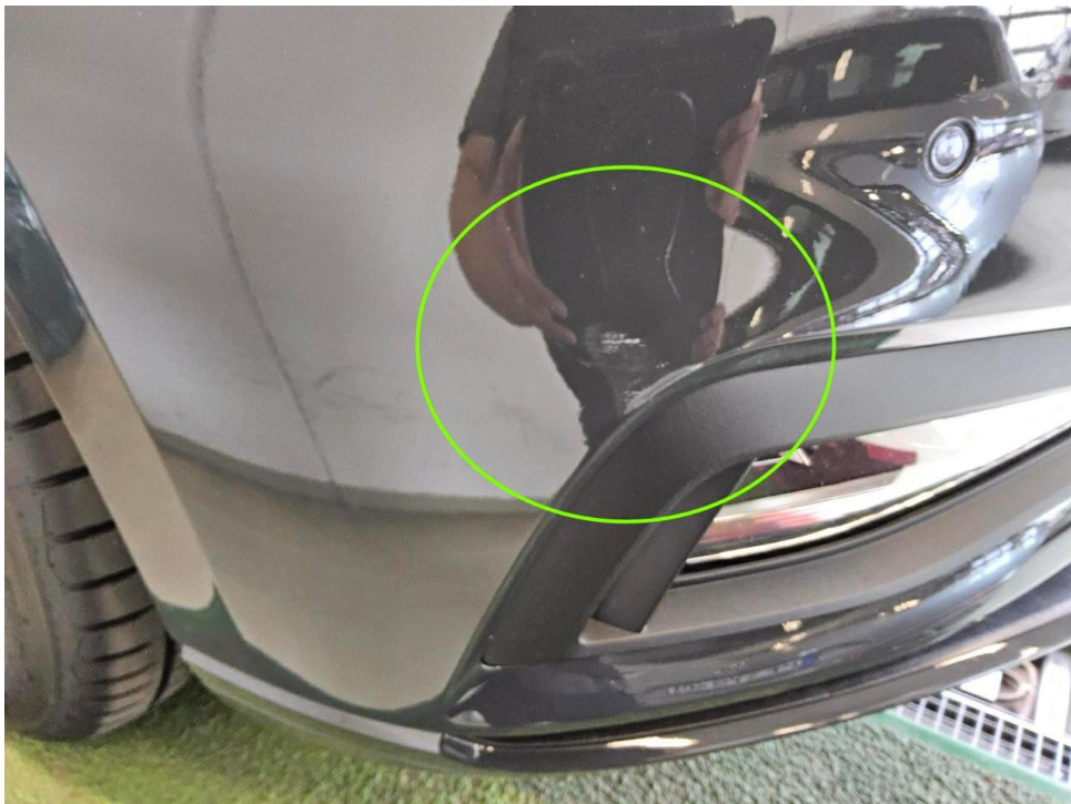
Bild 14 : Stoßfänger vorne, zerkratzt, smart repair
