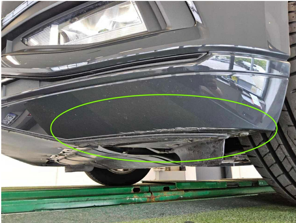
Bild 23 : Frontspoiler, zerkratzt, lackieren mit Lackaufbau
