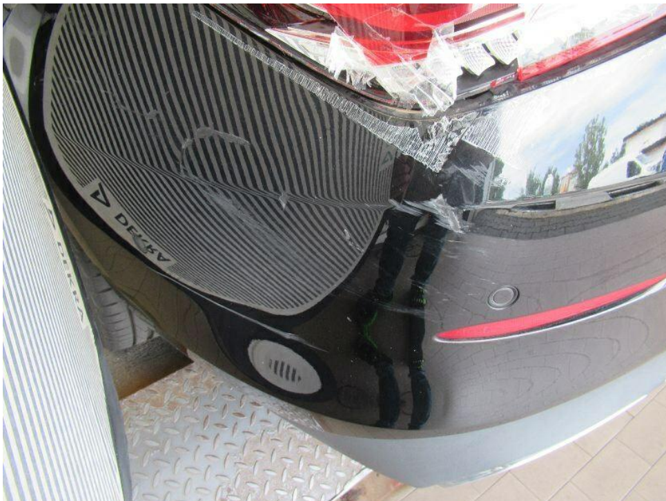
Bild 24 : Anfahrsschaden hinten links: Seitenteil, Stoßfänger, Rücklicht,..... beschädigt.
