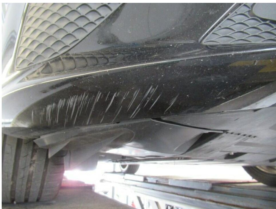
Bild 36 : Stoßfänger vorne Lackierung, zerkratzt, smart repair
