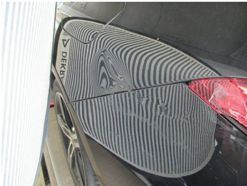
Bild 19 : Anfahrsschaden hinten links: Seitenteil, Stoßfänger, Rücklicht,..... beschädigt.
