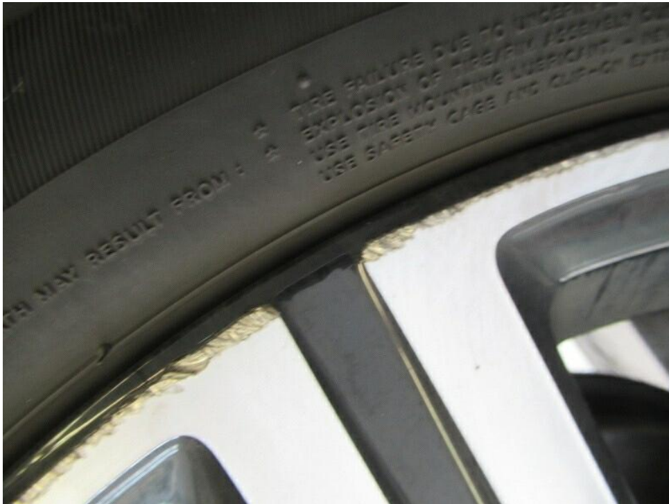
Bild 29 : Leichtmetallfelge hinten rechts beschädigt verschrammt.
