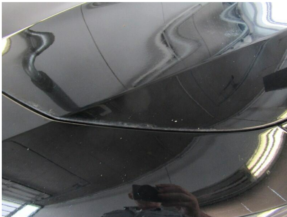
Bild 39 : Motorhaube Lackierung, Steinschlag, Gebrauchsspur
