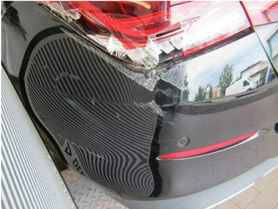
Bild 21 : Anfahrsschaden hinten links: Seitenteil, Stoßfänger, Rücklicht,..... beschädigt.
