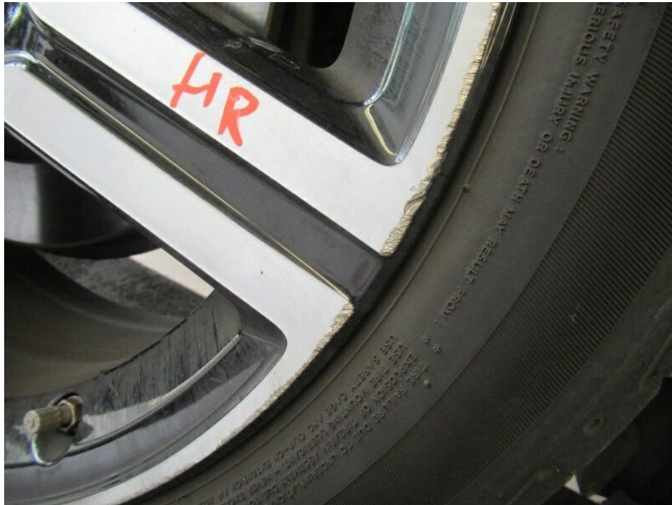
Bild 27 : Leichtmetallfelge hinten rechts beschädigt verschrammt.
