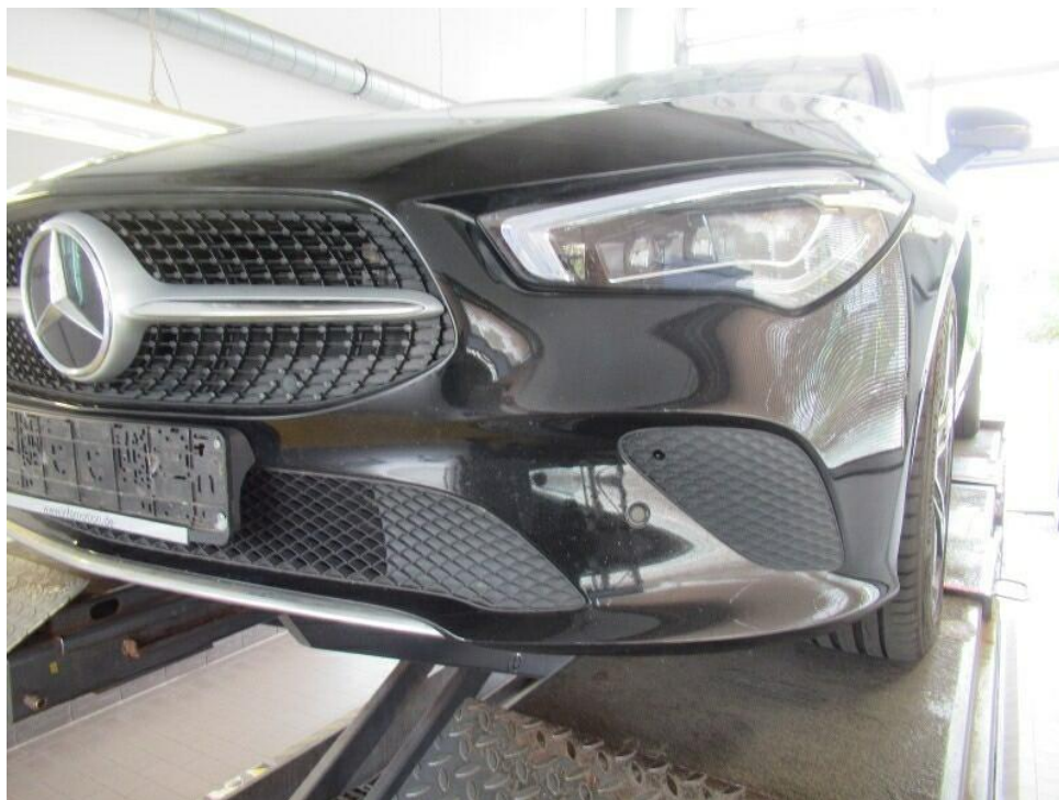
Bild 31 : Stoßfänger vorne Lackierung, Steinschlag, Gebrauchsspur
