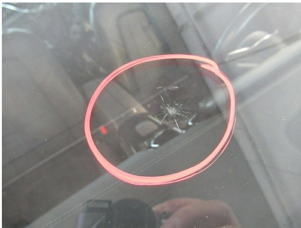
Bild 42 : Frontscheibe: Rep. Steinschlag.
