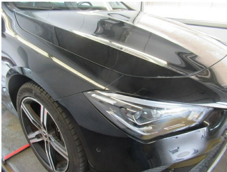
Bild 40 : Stoßfänger vorne Lackierung, Steinschlag, Gebrauchsspur Kotflügel vorne rechts Lackierung, Steinschlag, Gebrauchsspur
