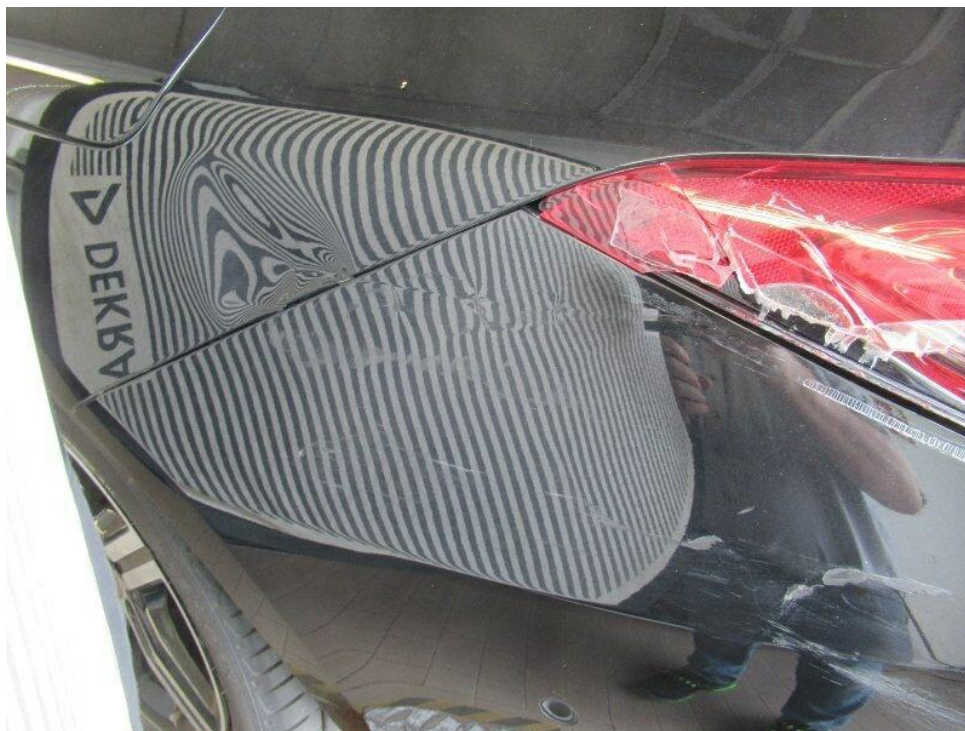
Bild 20 : Anfahrsschaden hinten links: Seitenteil, Stoßfänger, Rücklicht,..... beschädigt.
