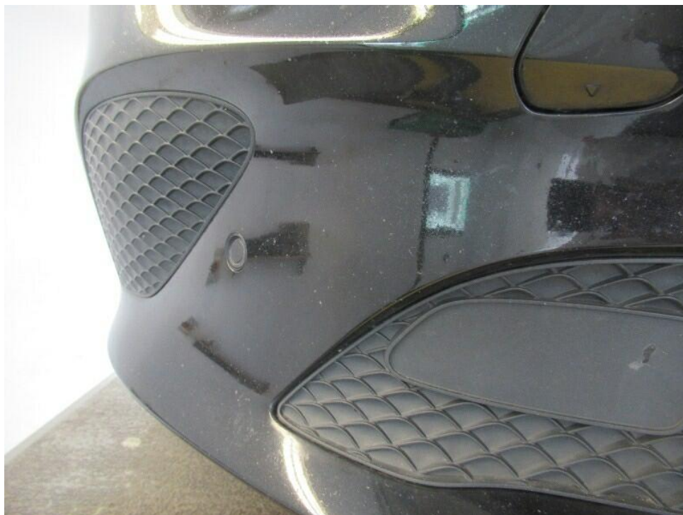
Bild 32 : Stoßfänger vorne Lackierung, Steinschlag, Gebrauchsspur
