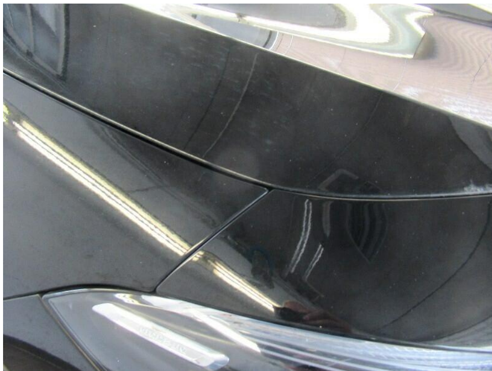
Bild 41 : Kotflügel vorne rechts Lackierung, Steinschlag, Gebrauchsspur Stoßfänger vorne Lackierung, Steinschlag, Gebrauchsspur
