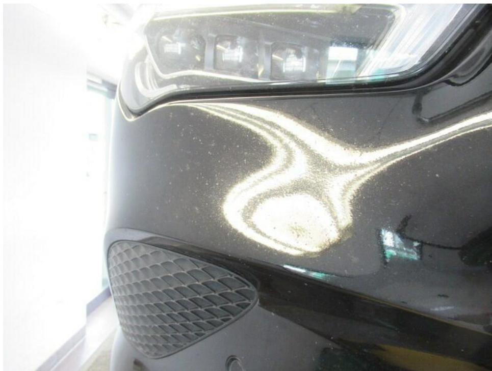
Bild 33 : Stoßfänger vorne Lackierung, Steinschlag, Gebrauchsspur
