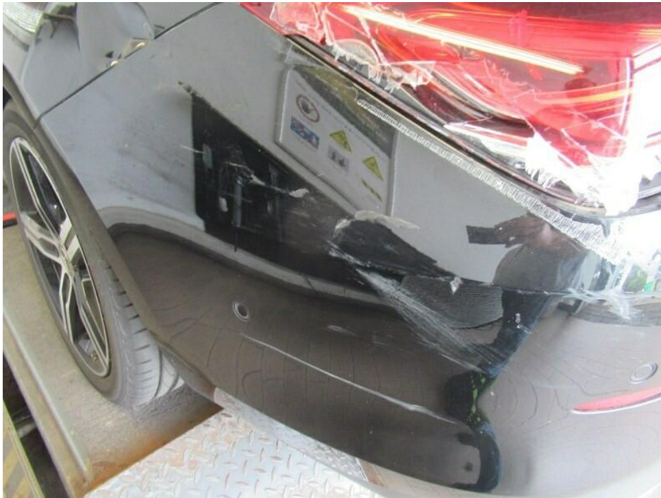
Bild 23 : Anfahrsschaden hinten links: Seitenteil, Stoßfänger, Rücklicht,..... beschädigt.
