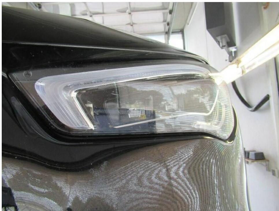
Bild 35 : Scheinwerfer links und rechts Steinschlag.
