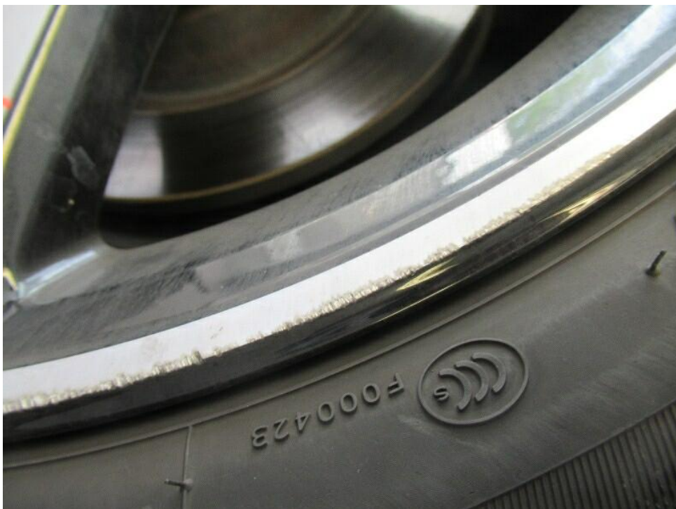
Bild 30 : Leichtmetallfelge hinten rechts beschädigt verschrammt.
