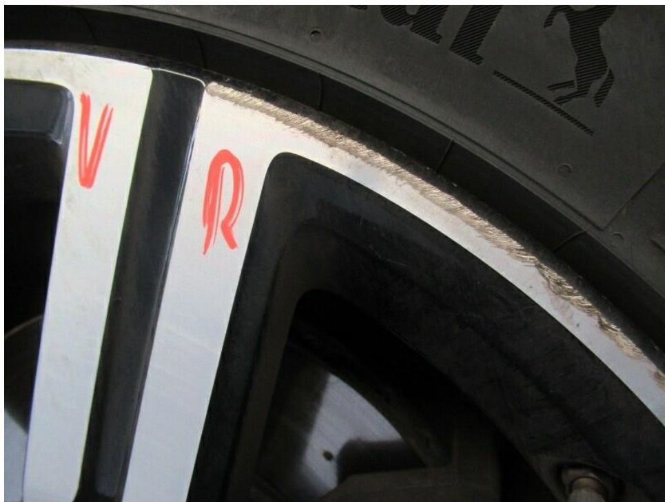
Bild 25 : Leichtmetallfelge vorne rechts beschädigt verschrammt.
