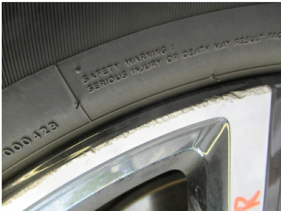
Bild 28 : Leichtmetallfelge hinten rechts beschädigt verschrammt.
