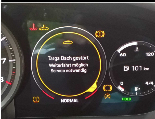
Beschädigung #4: Fahrzeugdach: Aufstelldach - Funktion / Zulässigkeit - Diagnose durchführen
