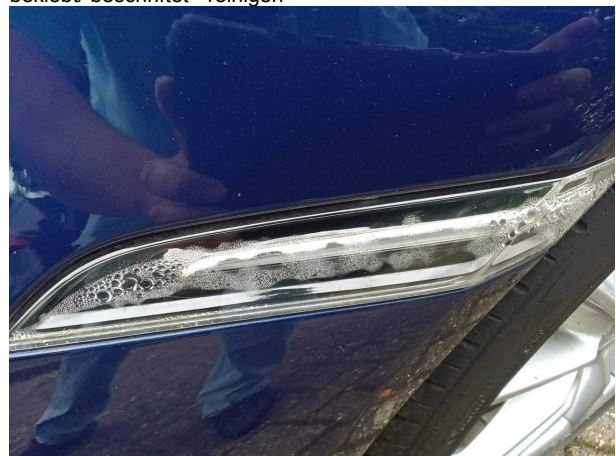
Beschädigung #3: Blinkleuchte: Blinkleuchte vorn links - undicht - erneuern
