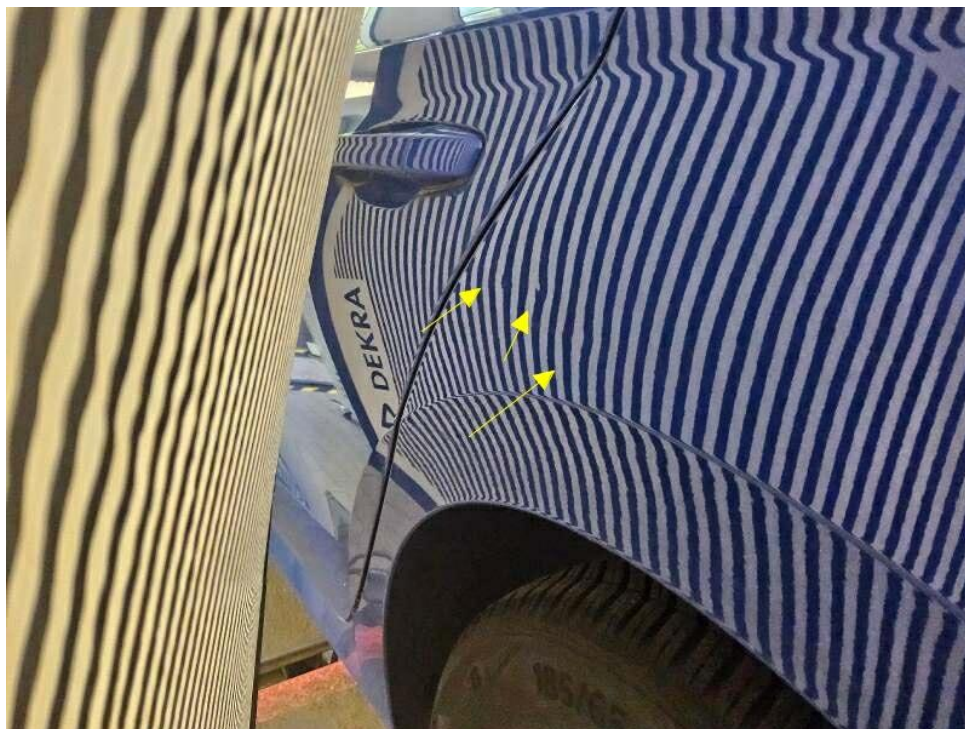
Bild 14 : Seitenwand links verformt
