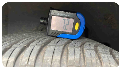
Photo mesure usure pneu arrière droit
