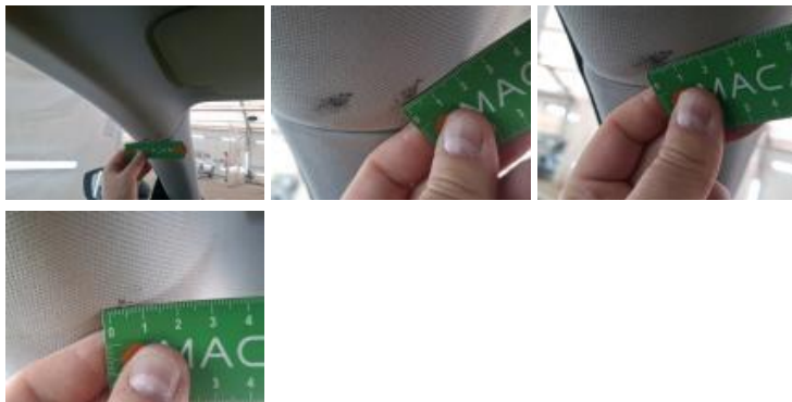
Revêtement dossier AVG, Déchirure, Smart repair +
