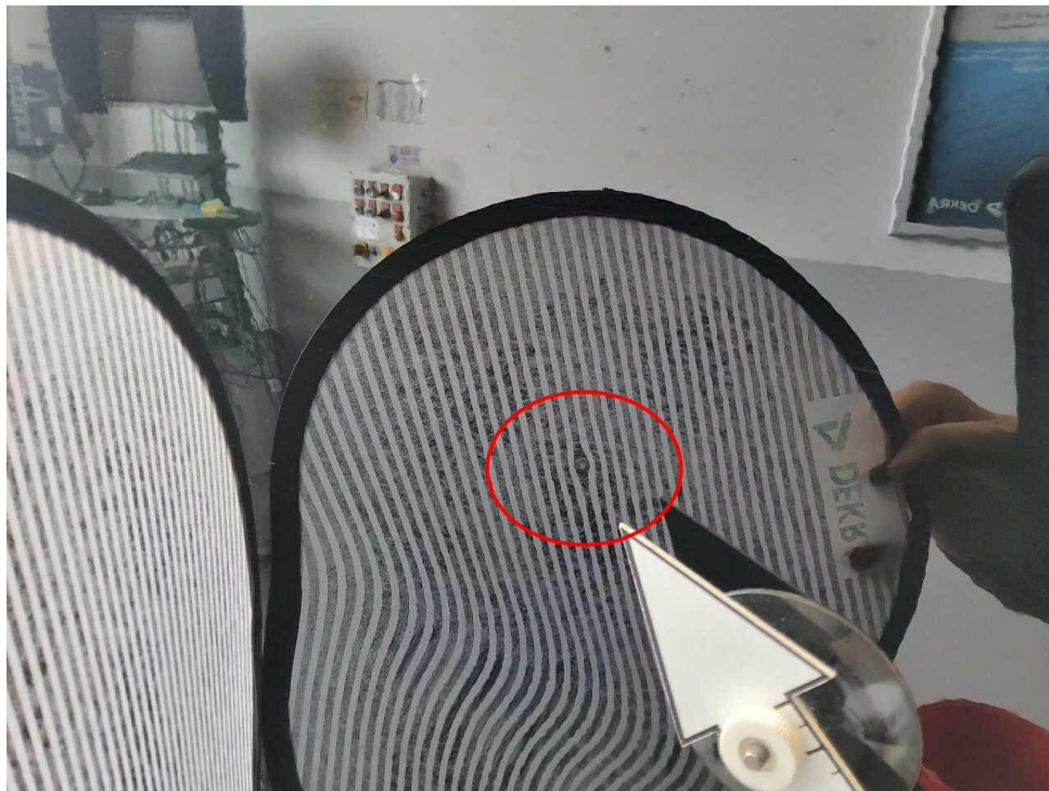
Bild 15 : Tür hinten rechts Delle
