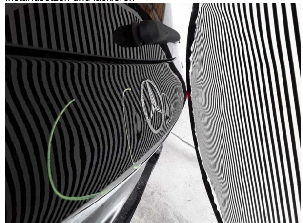
Beschädigung #9: Heckklappe/-tür: Heckklappe - Delle(n) - instandsetzen und lackieren
