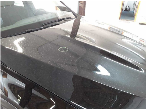
Beschädigung #4: Motorhaube: Motorhaube - Delle(n) - sanft instandsetzen
