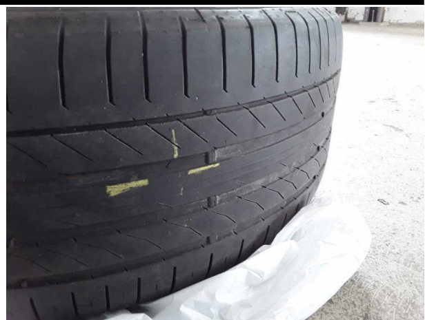
Beschädigung #6: 2.Radsatz: 2 Reifen - verschlissen - erneuern
