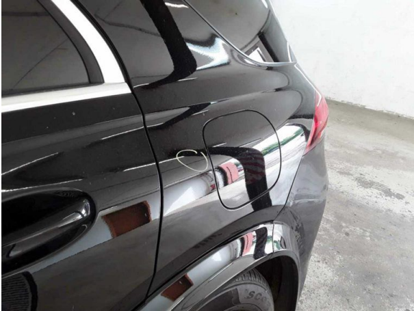
Beschädigung #3: Seitenwand links: Seitenwand - Delle(n) - sanft instandsetzen
