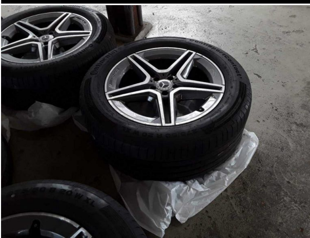
Beschädigung #6: 2.Radsatz: 2 Reifen - verschlissen - erneuern
