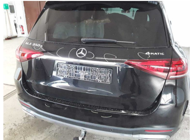
Beschädigung #9: Heckklappe/-tür: Heckklappe - Delle(n) - instandsetzen und lackieren
