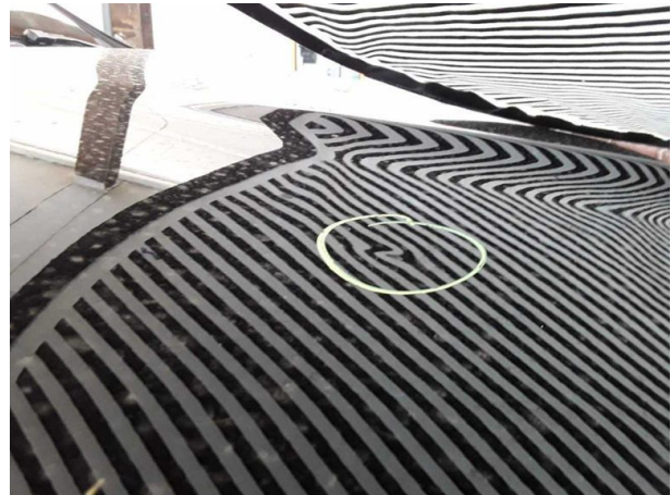
Beschädigung #4: Motorhaube: Motorhaube - Delle(n) - sanft instandsetzen
