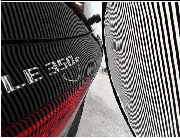
Beschädigung #9: Heckklappe/-tür: Heckklappe - Delle(n) - instandsetzen und lackieren
