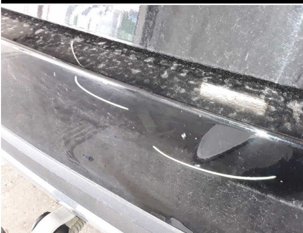
Beschädigung #8: Stossfänger hinten: Stossfänger hinten - verkratzt / verschürft - instandsetzen und lackieren
