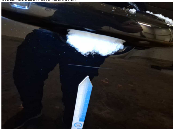
Beschädigung #5: Tür vorn rechts: Tür - verkratzt / verschürft - lackieren
