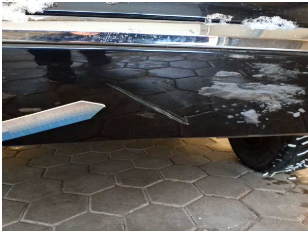
Beschädigung #6: Stossfänger hinten: Spoiler - verkratzt / verschürft - lackieren
