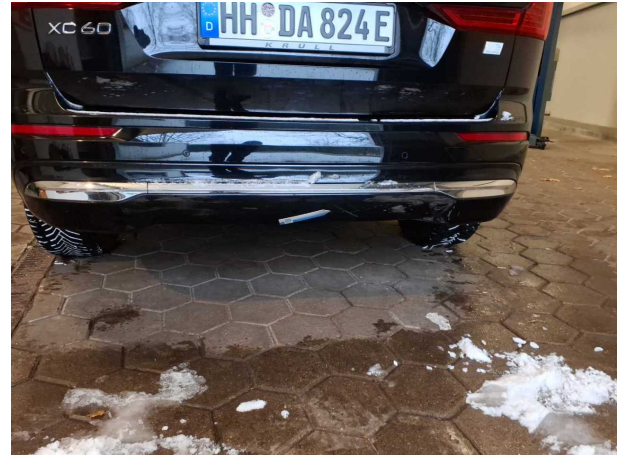
Beschädigung #6: Stossfänger hinten: Spoiler - verkratzt / verschürft - lackieren
