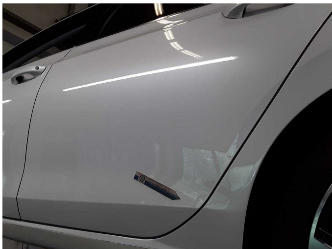
Damage 14: Door - rear left side: Door (Klarlackläufer) - Unprofessionally repaired - Paint
