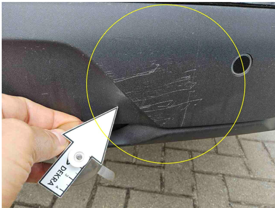
Bild 11 : Stoßfänger hinten Unterteil, verschrammt
