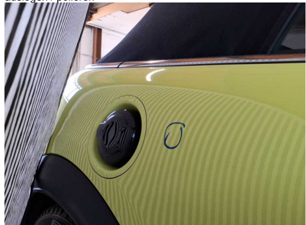
Beschädigung #3: Seitenwand rechts: Seitenwand - Delle(n) - sanft instandsetzen
