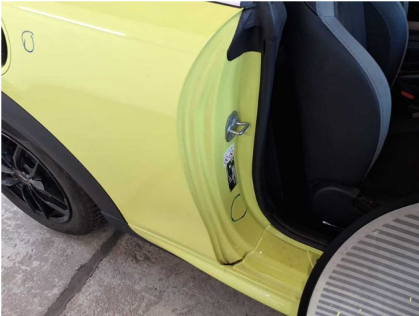
Beschädigung #1: Schweller rechts: Einstieg - Kratzer - auslegen... polieren
