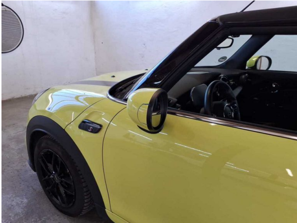
Beschädigung #6: Außenspiegel links: Spiegelgehäuse - beschädigt - erneuern
