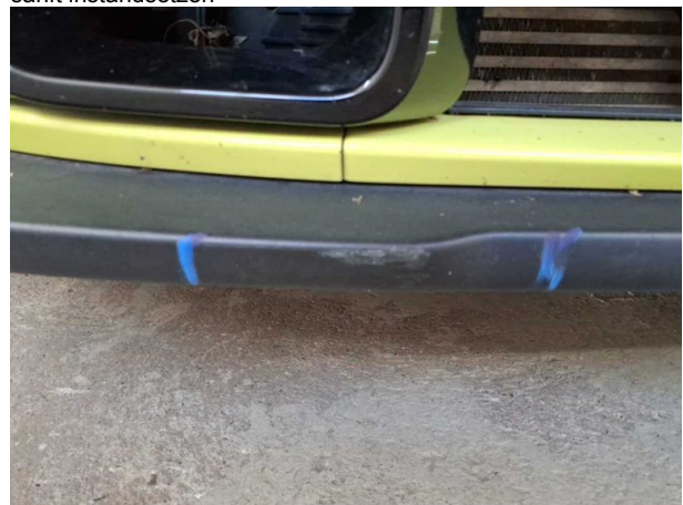
Beschädigung #4: Stossfänger vorn: Spoiler - verkratzt / verschürft - erneuern
