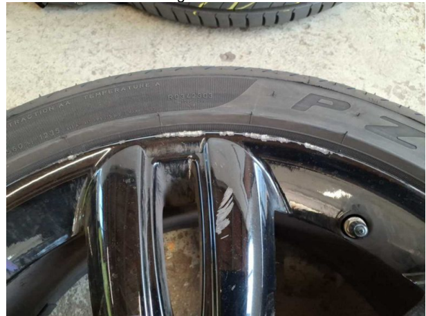
Beschädigung #7: 2.Radsatz: 3 Leichtmetallfelgen - verkratzt / verschürft - Wertminderung
