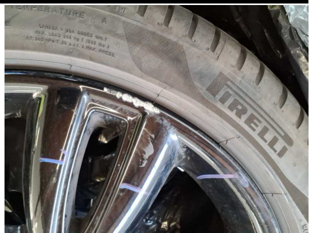
Beschädigung #7: 2.Radsatz: 3 Leichtmetallfelgen - verkratzt / verschürft - Wertminderung
