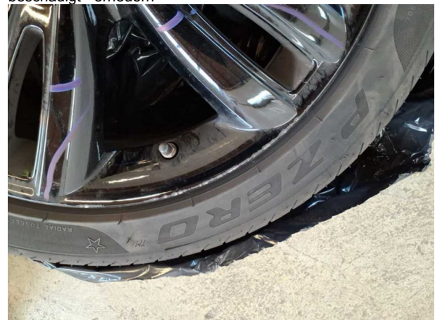
Beschädigung #7: 2.Radsatz: 3 Leichtmetallfelgen - verkratzt... verschürft - Wertminderung
