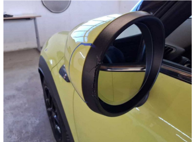
Beschädigung #6: Außenspiegel links: Spiegelgehäuse - beschädigt - erneuern
