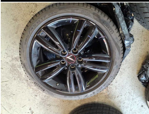
Beschädigung #7: 2.Radsatz: 3 Leichtmetallfelgen - verkratzt / verschürft - Wertminderung
