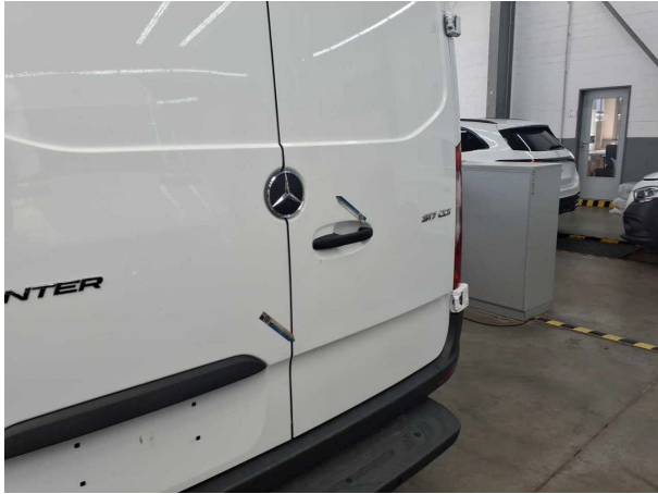
Beschädigung #8: Heckklappe/-tür: Hecktür rechts - Delle(n) - Smart Repair
