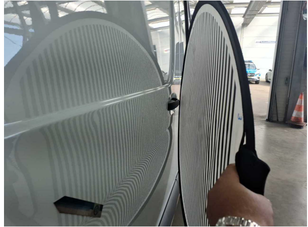
Beschädigung #11: Schiebetür rechts: Schiebetür - Delle(n) - Smart Repair
