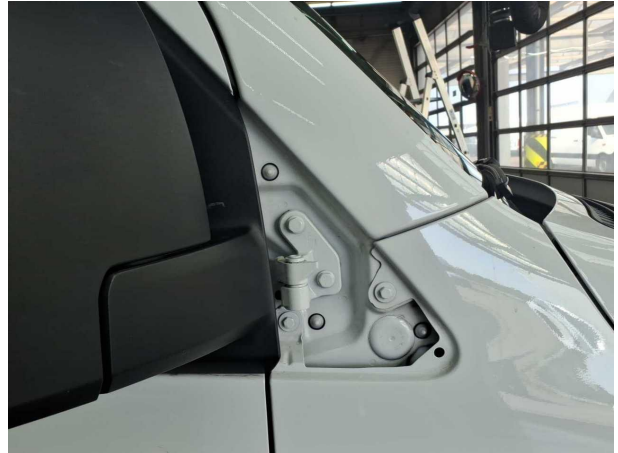
Beschädigung #1: Verkleidungen/Abdeckungen: Verkleidungen/Abdeckungen (Abdeckung Kotflügel rechts oben) - lose - de-/
