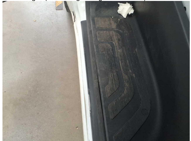
Beschädigung #3: Karosserie: Türrichtung vorn links - gebrochen / gerissen - erneuern
