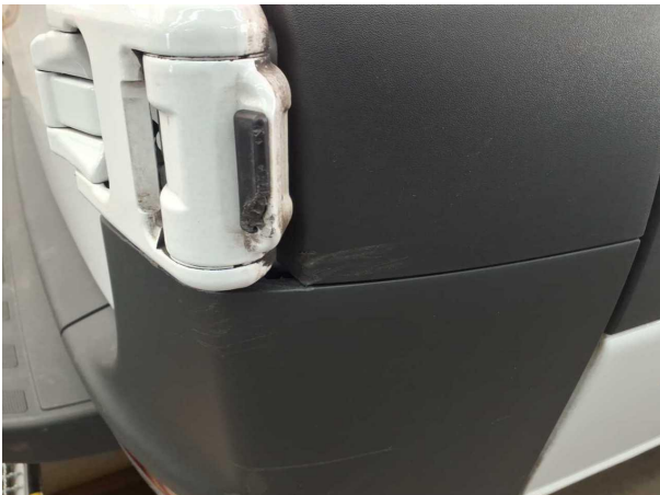
Beschädigung #4: Heckleuchte: Blende unterhalb rechts - verkratzt / verschürft - erneuern
