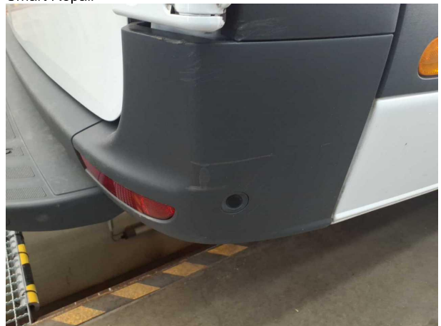
Beschädigung #9: Stossfänger hinten: Stossfänger hinten rechts - verkratzt / verschürft - erneuern
