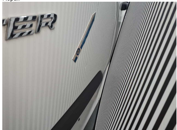
Beschädigung #7: Heckklappe/-tür: Hecktür links - Delle(n) - Sm... Repair
