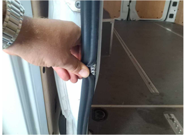
Beschädigung #6: Schiebetür rechts: Türdichtung - gebrochen / gerissen - erneuern
