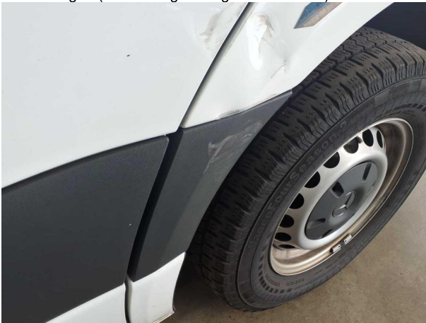
Beschädigung #2: Kotflügel rechts: Zierleiste, -gitter - verkratzt / verschürft - erneuern
