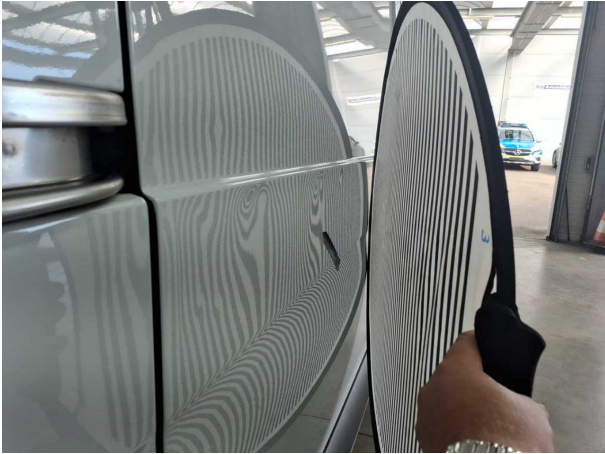
Beschädigung #11: Schiebetür rechts: Schiebetür - Delle(n) - Smart Repair
