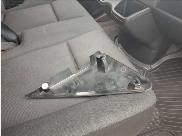
Beschädigung #1: Verkleidungen/Abdeckungen: Verkleidungen/Abdeckungen (Abdeckung Kotflügel rechts oben) - lose - de-/montieren
