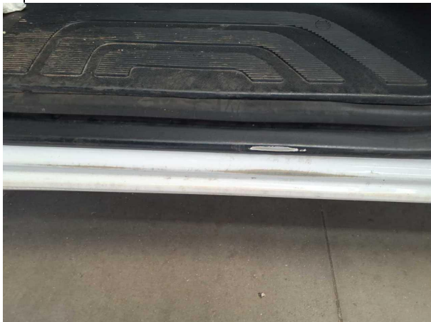
Beschädigung #10: Schweller links: Einstieg - verkratzt / verschürft - lackieren
