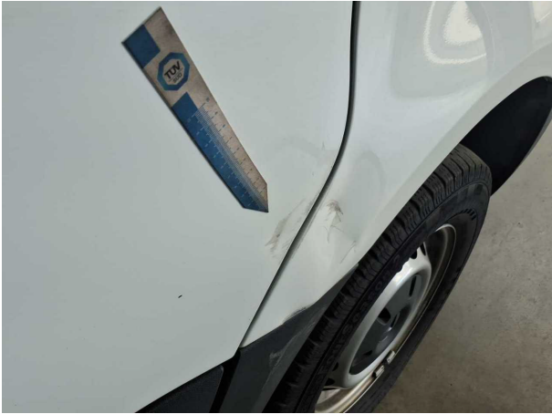
Beschädigung #15: Tür vorn rechts: Tür - Delle / Lackschaden - instandsetzen/lackieren (S2)
