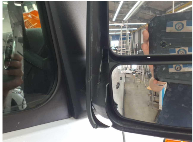
Beschädigung #14: Außenspiegel rechts: Außenspiegel - gebrochen / gerissen - erneuern
