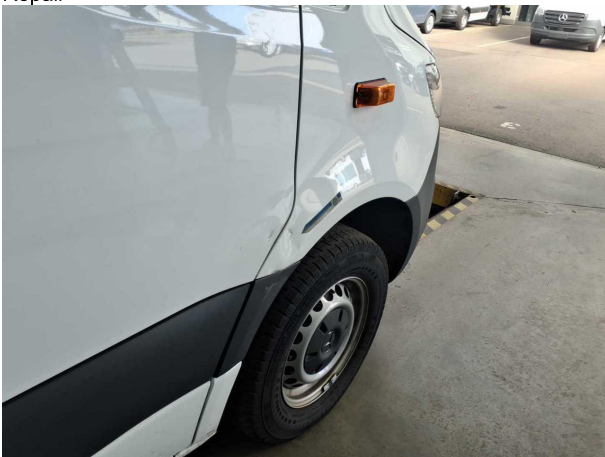
Beschädigung #12: Kotflügel rechts: Kotflügel rechts - verformt - erneuern
