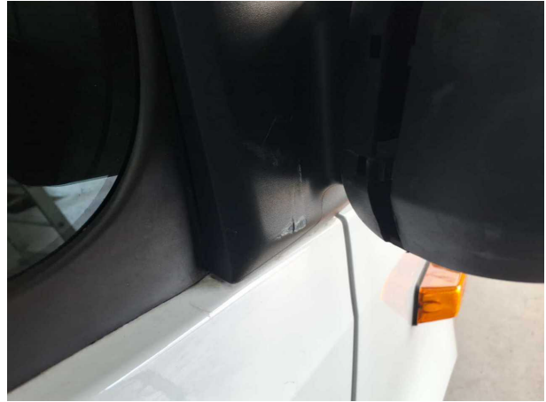
Beschädigung #14: Außenspiegel rechts: Außenspiegel - gebrochen / gerissen - erneuern
