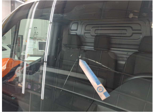
Beschädigung #16: Verglasung: Frontscheibe mit Spurhalteassistent - gebrochen / gerissen - erneuern
