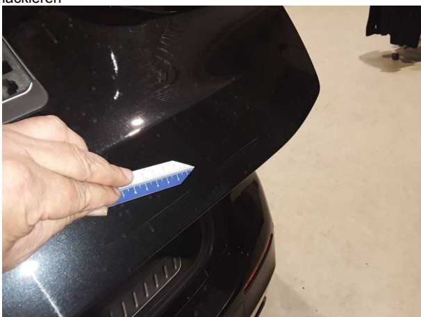
Beschädigung #12: Heckklappe/-tür: Heckklappe - Kratzer - lackieren
