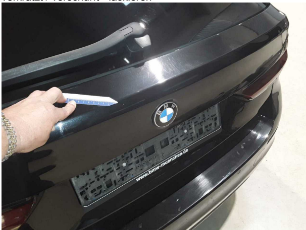
Beschädigung #12: Heckklappe/-tür: Heckklappe - Kratzer - lackieren
