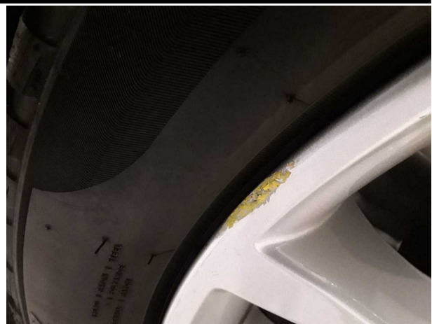
Beschädigung #7: Rad/Reifen: Leichtmetallfelge vorn links (Materialabrieb) - verkratzt / verschürft - erneuern
