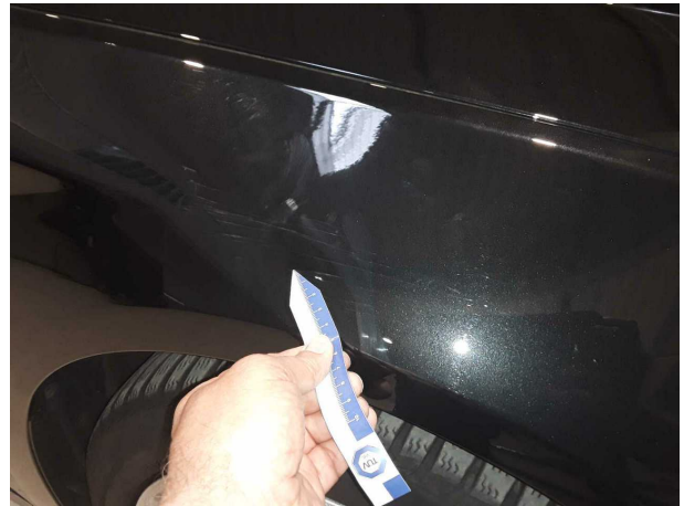
Beschädigung #13: Kotflügel rechts: Kotflügel rechts - Kratzer - lackieren
