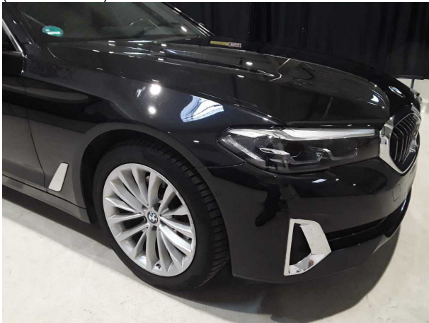
Beschädigung #8: Rad/Reifen: Leichtmetallfelge vorn rechts (Materialabrieb) - verkratzt / verschürft - erneuern
