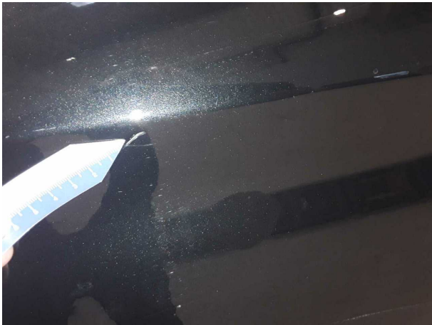
Beschädigung #10: Tür hinten rechts: Tür - Kratzer - lackieren
