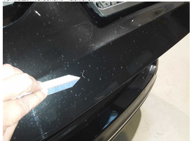
Beschädigung #12: Heckklappe/-tür: Heckklappe - Kratzer - lackieren
