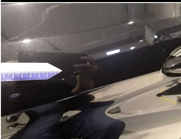
Beschädigung #9: Tür hinten links: Tür - Kratzer - lackieren
