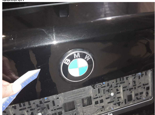
Beschädigung #12: Heckklappe/-tür: Heckklappe - Kratzer - lackieren
