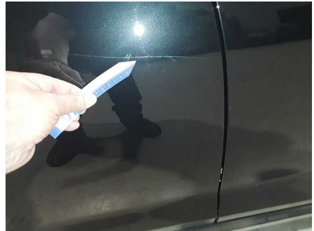
Beschädigung #10: Tür hinten rechts: Tür - Kratzer - lackieren
