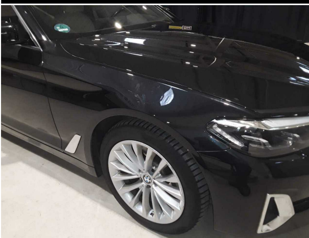
Beschädigung #13: Kotflügel rechts: Kotflügel rechts - Kratzer - lackieren
