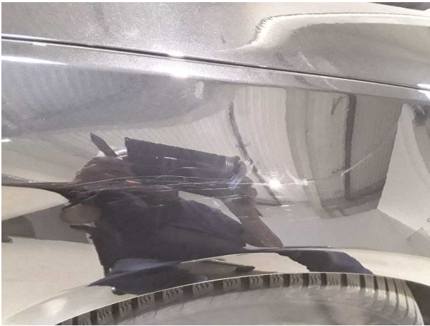
Beschädigung #13: Kotflügel rechts: Kotflügel rechts - Kratzer - lackieren
