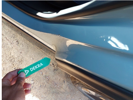
Travesaño de la puerta / Trasero Izquierdo / Abolladura
