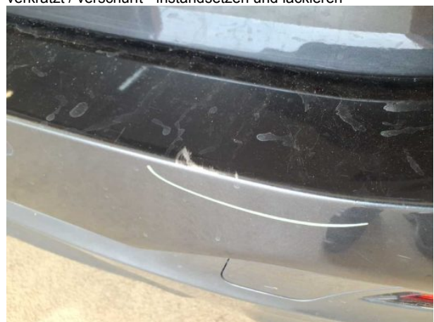
Beschädigung #18: Stossfänger hinten: Stossfänger hinten - verkratzt / verschürft - instandsetzen und lackieren
