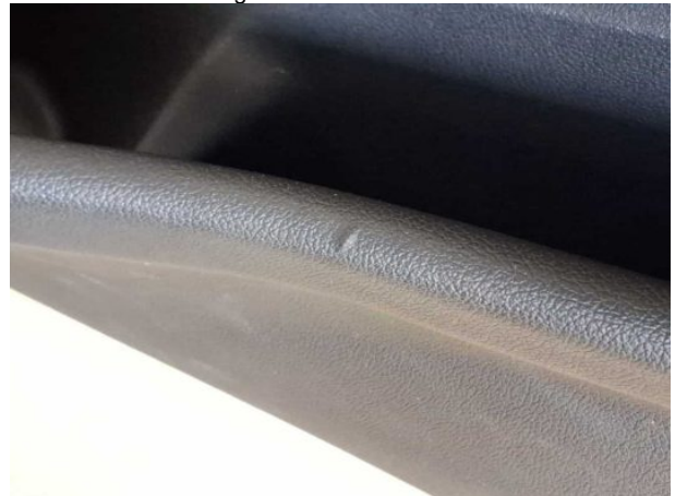
Beschädigung #3: Verkleidungen/Abdeckungen: Türverkleidung vorn rechts - beschädigt - Wertminderung
