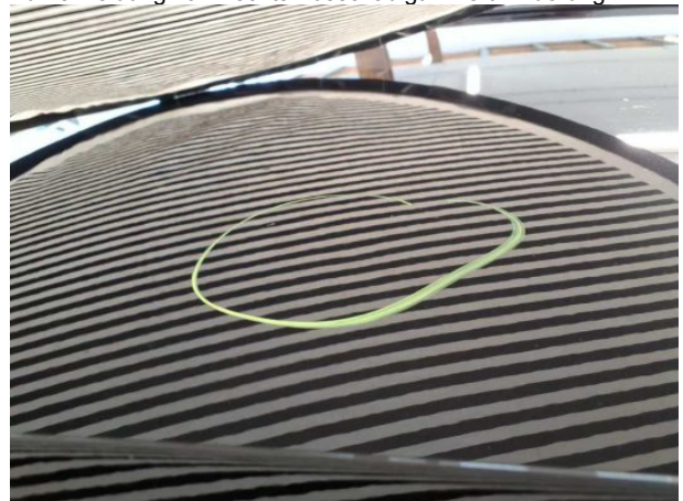
Beschädigung #4: Fahrzeugdach: Dach - Delle(n) - sanft instandsetzen
