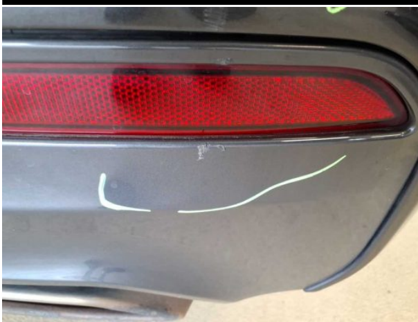
Beschädigung #5: Stossfänger hinten: Spoiler - verkratzt / verschürft - Wertminderung
