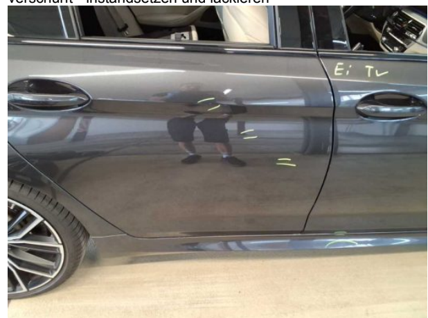
Beschädigung #17: Tür hinten rechts: Tür - verkratzt / verschürft - instandsetzen und lackieren
