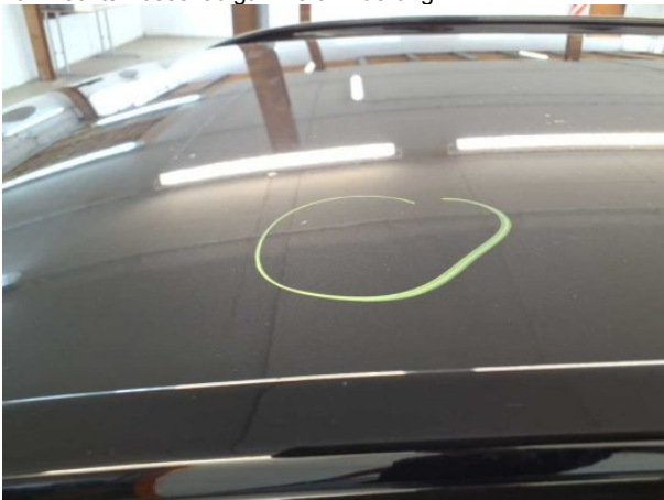
Beschädigung #4: Fahrzeugdach: Dach - Delle(n) - sanft instandsetzen
