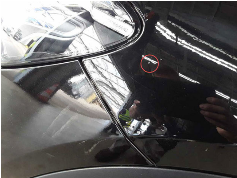
Beschädigung #13: Kotflügel links: Kotflügel links - nicht fachgerecht instandgesetzt - lackieren
