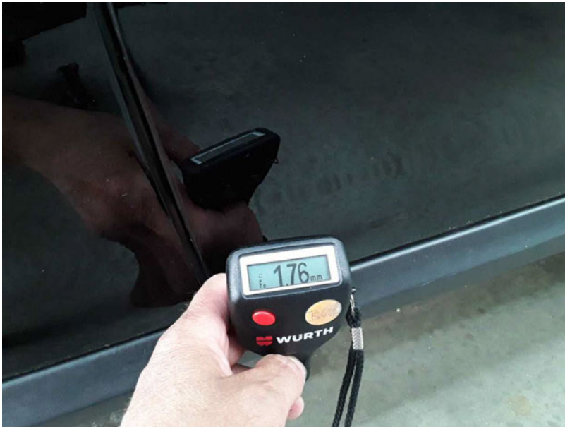
Beschädigung #21: Tür hinten links: Tür - nicht fachgerecht instandgesetzt - erneuern
