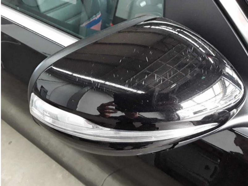
Beschädigung #17: Außenspiegel rechts: Außenspiegel - beschädigt - erneuern
