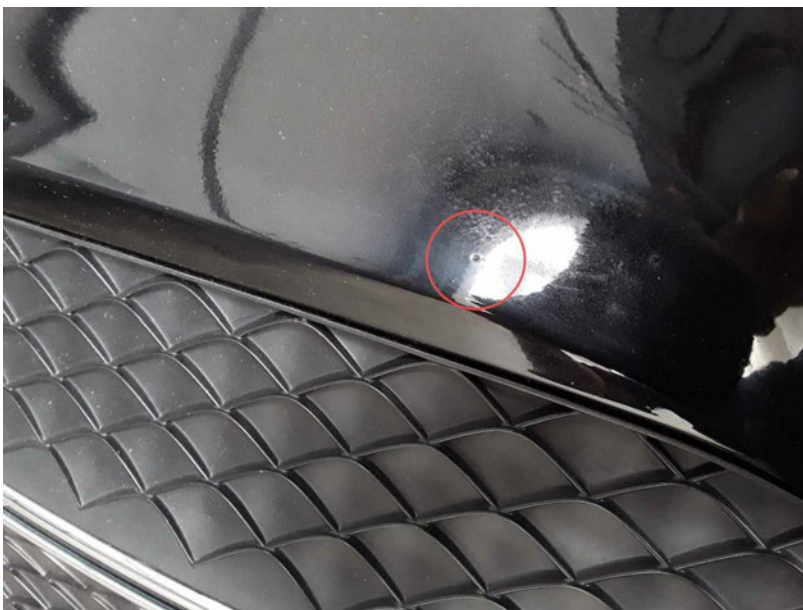
Beschädigung #19: Stossfänger vorn: Stossfänger mit Parktronic - beschädigt - erneuern
