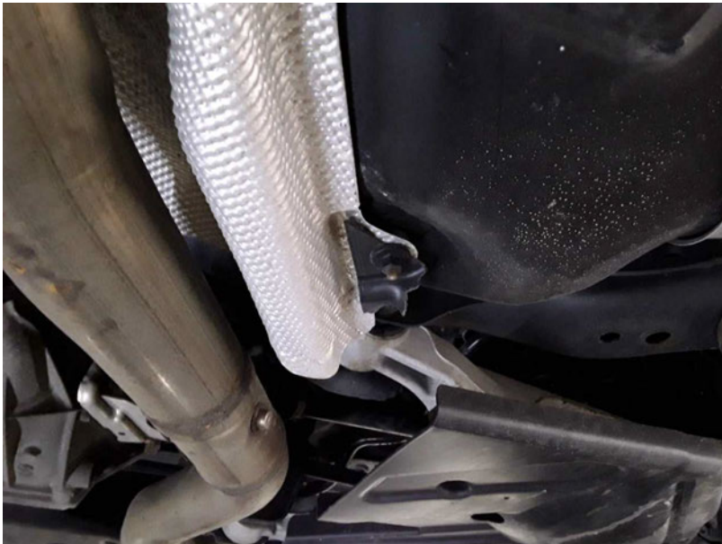
Beschädigung #10: Karosserie: Unterbodenverkleidung (links) - gebrochen / gerissen - erneuern
