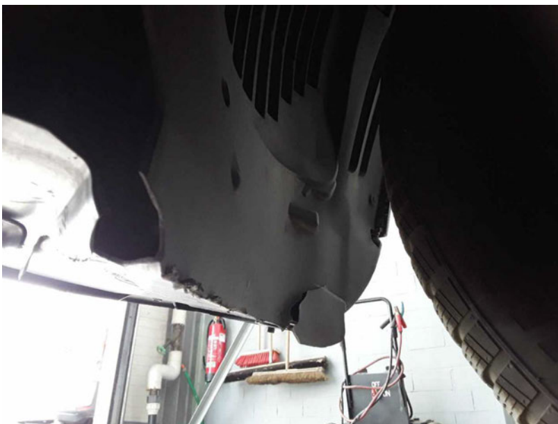
Beschädigung #8: Kotflügel rechts: Innenkotflügel - beschädigt - erneuern
