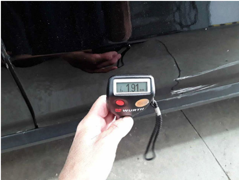
Beschädigung #24: Tür vorn rechts: Tür - nicht fachgerecht instandgesetzt - erneuern
