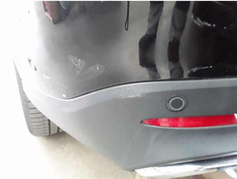
Beschädigung #18: Stossfänger hinten: Stossfänger mit Parktronic - nicht fachgerecht instandgesetzt - erneuern
