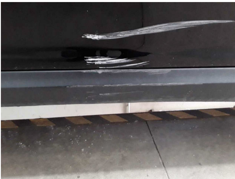
Beschädigung #11: Schweller rechts: Verkleidung - verkratzt / verschürft - erneuern
