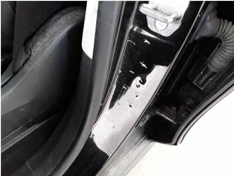
Beschädigung #12: Karosserie: B-Säule links - Delle / Lackschaden - instandsetzen und lackieren
