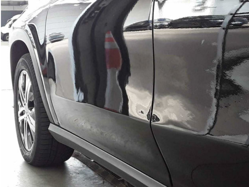
Beschädigung #23: Tür vorn links: Tür - nicht fachgerecht instandgesetzt - erneuern
