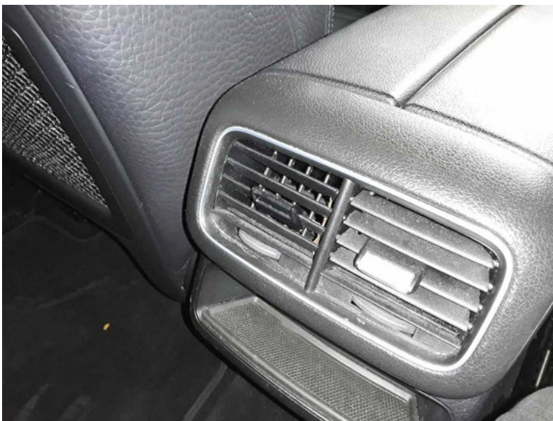
Beschädigung #4: Instrumententafel: Mittelkonsole hinten (Luftdüse) - beschädigt - erneuern
