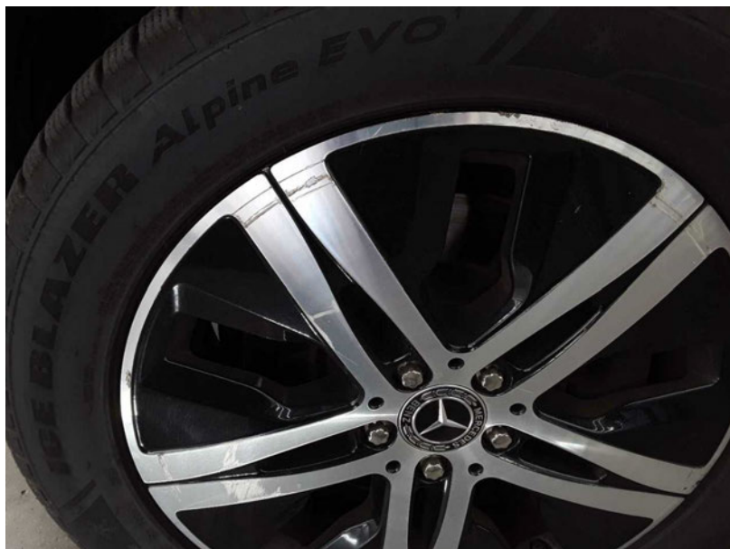
Beschädigung #20: Rad/Reifen: Felgensatz komplett - beschädigt - erneuern
