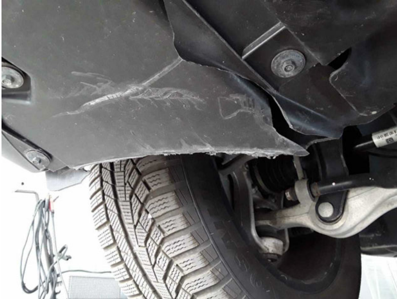
Beschädigung #8: Kotflügel rechts: Innenkotflügel - beschädigt - erneuern
