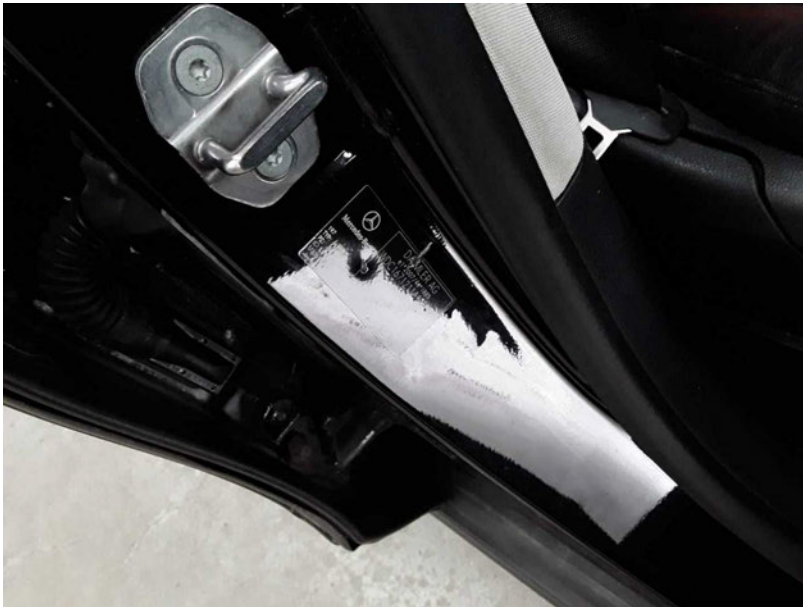
Beschädigung #6: Karosserie: B-Säule rechts - Delle / Lackschaden - Smart Repair
