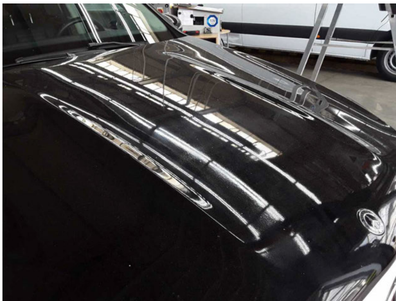
Beschädigung #16: Motorhaube: Motorhaube - nicht fachgerecht instandgesetzt - lackieren
