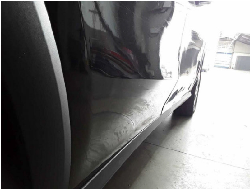
Beschädigung #22: Tür hinten rechts: Tür - nicht fachgerecht instandgesetzt - erneuern
