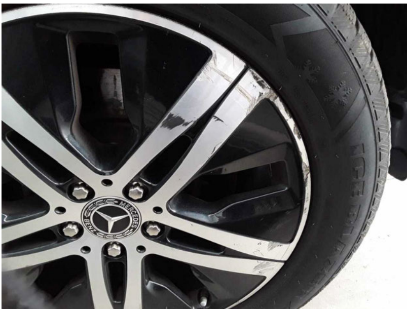
Beschädigung #20: Rad/Reifen: Felgensatz komplett - beschädigt - erneuern
