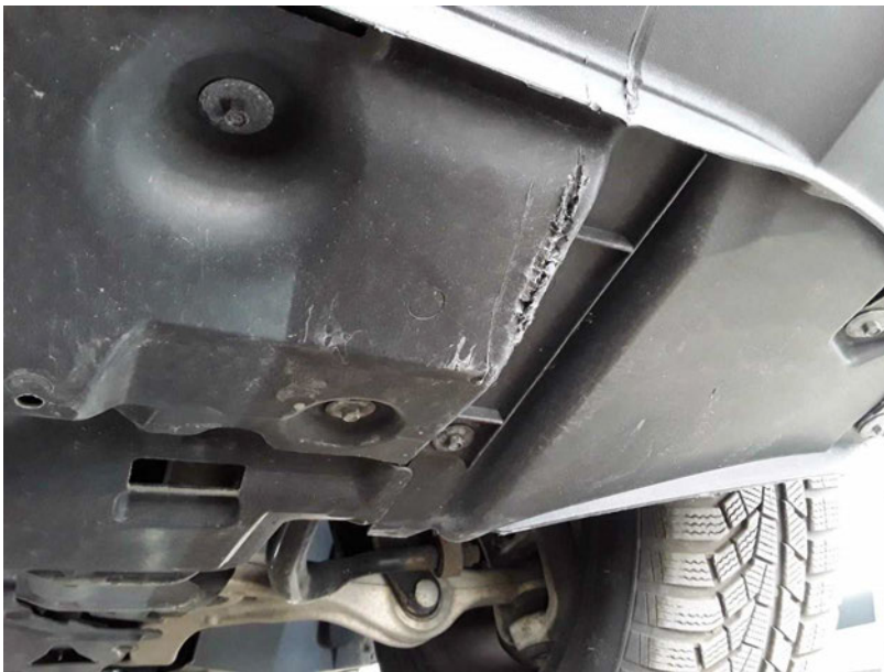
Beschädigung #7: Motor: Motorverkleidung unten - gebrochen / gerissen - erneuern
