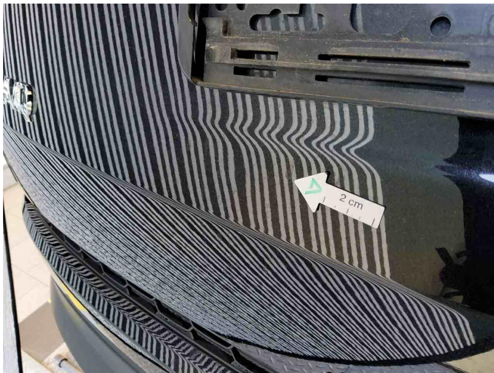
Bild 29 : Heckklappe, eingedellt, drücken
