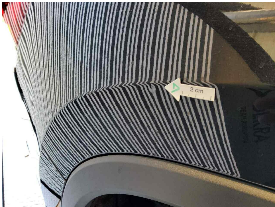
Bild 27 : Seitenwand hinten rechts eingedellt
