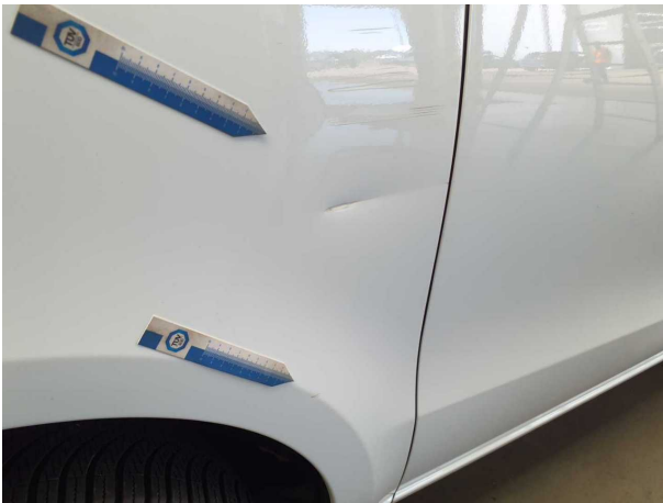
Beschädigung #16: Seitenwand rechts: Kotflügel hinten rechts - Dell... Lackschaden - instandsetzen und lackieren
