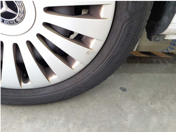
Beschädigung #3: Rad/Reifen: Radblende vorn links - verkratzt / verschürft - erneuern
