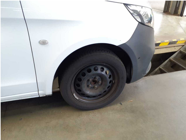
Beschädigung #1: Rad/Reifen: Radblende vorn rechts - fehlt - erneuern
