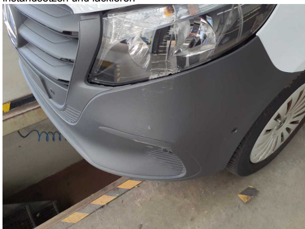
Beschädigung #15: Stossfänger vorn: Stossfänger mit Parktronic (Mehrkosten können entstehen) - beschädigt - erneuern
