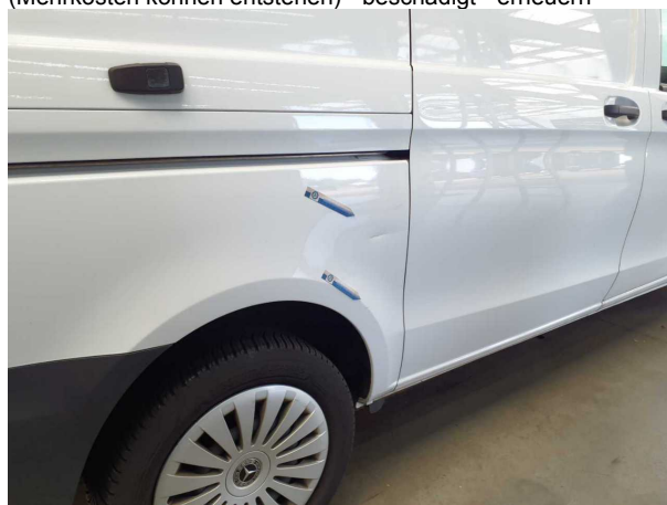
Beschädigung #16: Seitenwand rechts: Kotflügel hinten rechts - Delle / Lackschaden - instandsetzen und lackieren
