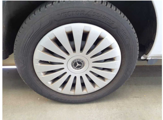
Beschädigung #2: Rad/Reifen: Radblende hinten rechts - verkratzt / verschürft - erneuern
