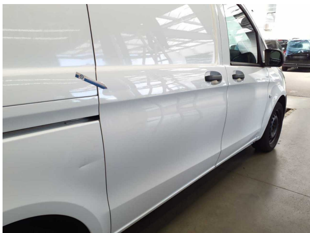
Beschädigung #14: Schiebetür rechts: Schiebetür - Delle(n) - instandsetzen und lackieren
