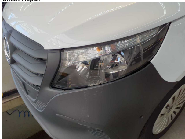
Beschädigung #12: Scheinwerfer: Scheinwerfer links - beschädigt - erneuern
