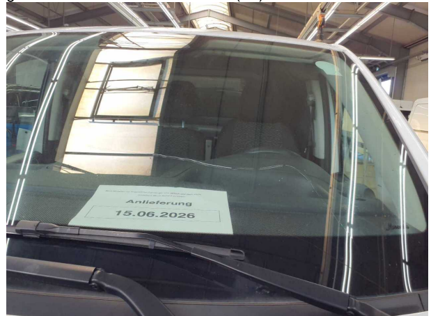
Beschädigung #18: Verglasung: Frontscheibe mit Spurhalteassistent - gebrochen / gerissen - erneuern
