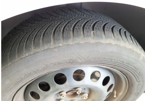
Beschädigung #11: Rad/Reifen: Reifen vorn rechts - verschlissen - erneuern
