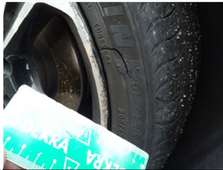
Pneu / Avant Gauche / Déchiré
