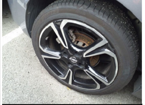
Pneu / Arrière Droit / Déchiré
