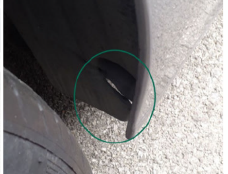
Pare-boue / Arrière Droit / Cassé
