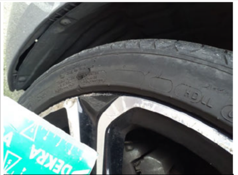
Pneu / Avant Gauche / Déchiré
