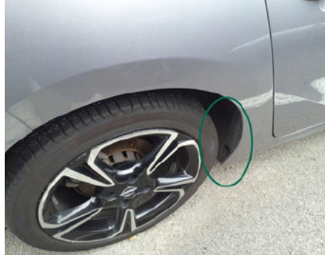
Pare-boue / Arrière Droit / Cassé
