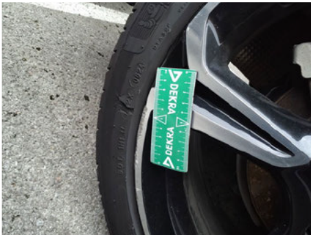
Pneu / Arrière Droit / Déchiré
