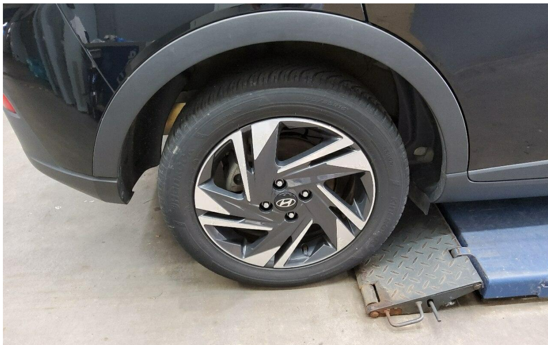
Bild 10 : Felge hinten rechts, Oberflächenkorrosion
