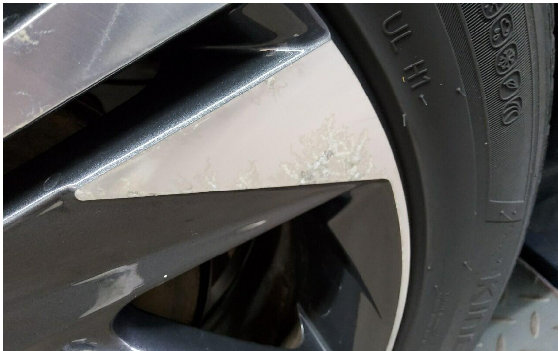
Bild 11 : Felge hinten rechts, Oberflächenkorrosion
