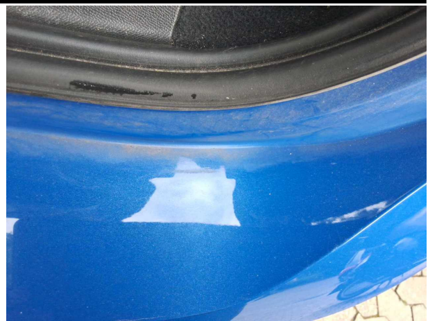
Beschädigung #5: Stossfänger hinten: Stossfänger hinten - Delle / Lackschaden - lackieren
