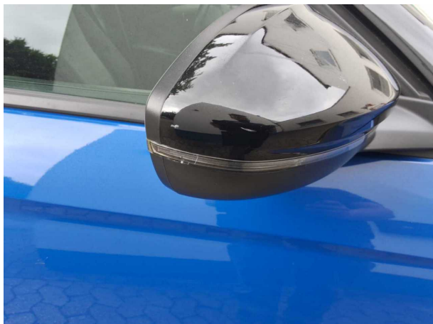
Beschädigung #1: Außenspiegel links: Abdeckkappe - Kratzer - Smart Repair
