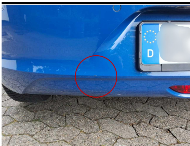
Beschädigung #5: Stossfänger hinten: Stossfänger hinten - Delle / Lackschaden - lackieren
