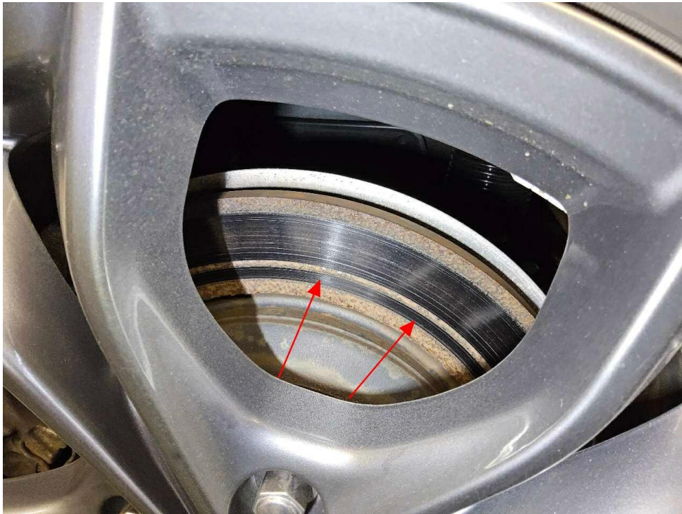
Bild 15 : T- Bremsscheiben Hinterachse Riefenbildung
